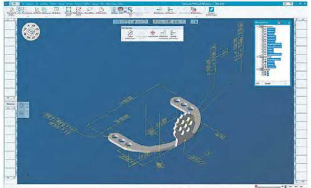
Bild visar modell från Solidworks inkl toleransinformation (PMI data)
