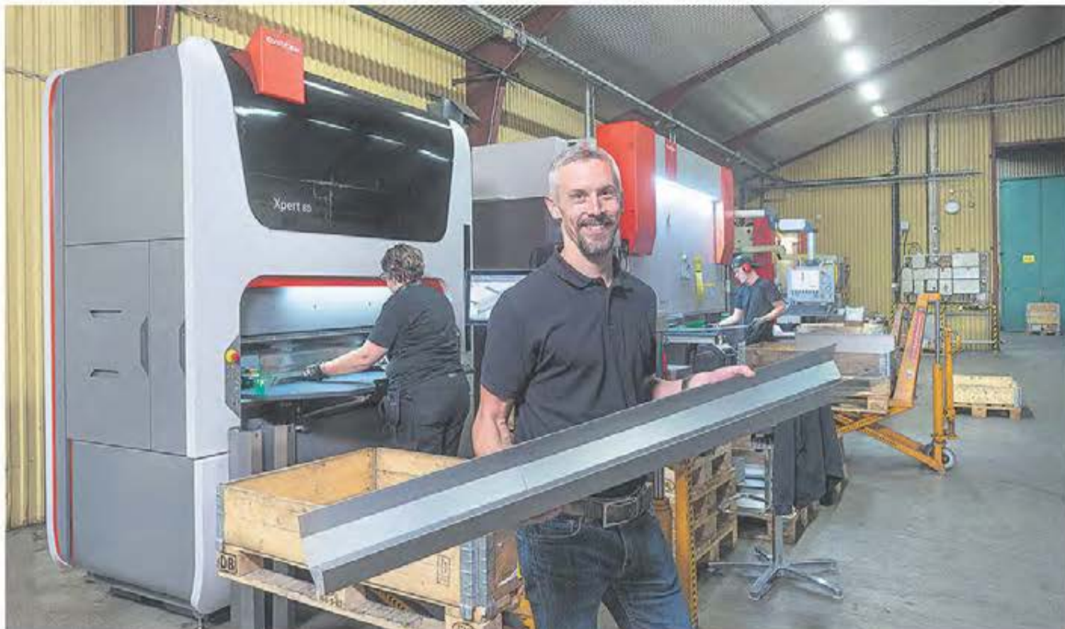
Ett exempel på tillverkning i Xpert 80 är kabeldiken till skrivbordsstativ, en bockad detalj som skjuts in i en matchande bit, och kunden kan vid slutmonteringen själv justera längden. Då bitarna tillverkas i par, är det viktigt att måtten hålls repeterbart
