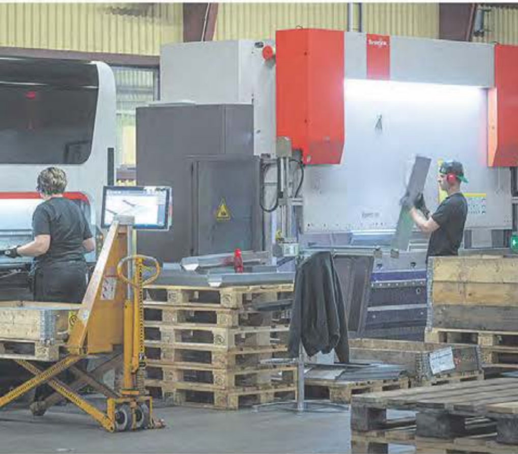
WOG Metall har en Fiberlaser på 4000W och 90% av det som skärs bockas. Det förädlas 600 ton järnplåt per år. – Det är lite kul när man går på stan och hamnar på någon av de större butikskedjorna, nästan varje gång ser man något vi tillverkat säger Kristoffer Davidsson. Här ser vi deras uppställning av kantpressar.
