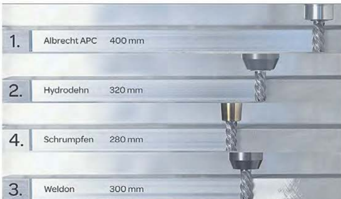
Jämförelsetest av bearbetning med HM fräs dia 16 mm i olika hållande system, vinnare Albrecht FPC
