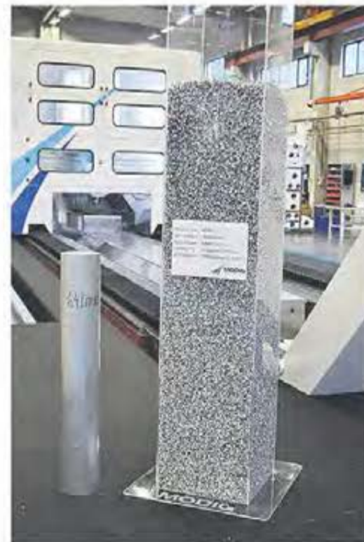
Glasmontern demonstrerar hur mycket spån det blir av 16,4 liter aluminium som är det nya världsrekordet för aluminiumfräsning under en minut. När Modig Machine Tool genomförde ett test på världsrekord-nivå stängde elnätsägaren av strömmen i Virserum eftersom de trodde att det var något fel på nätet när förbrukningen av el ökade drastiskt.
