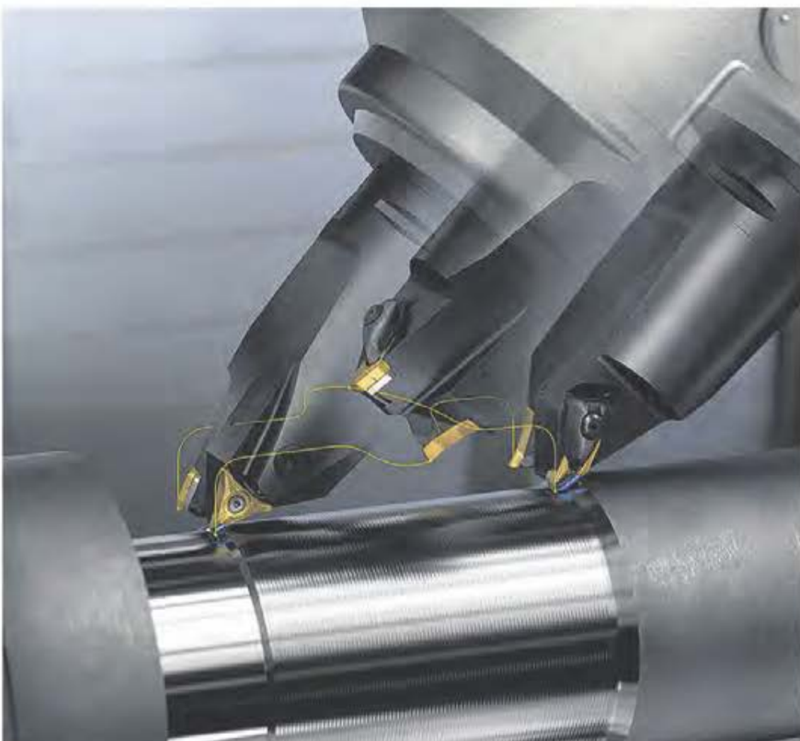
Skär av både CoroTurn A- och B-typ kan monteras tillsammans på Sandvik Coromants CoroTurn-tvillingverktygshållare för flerfunktionsmaskiner.
