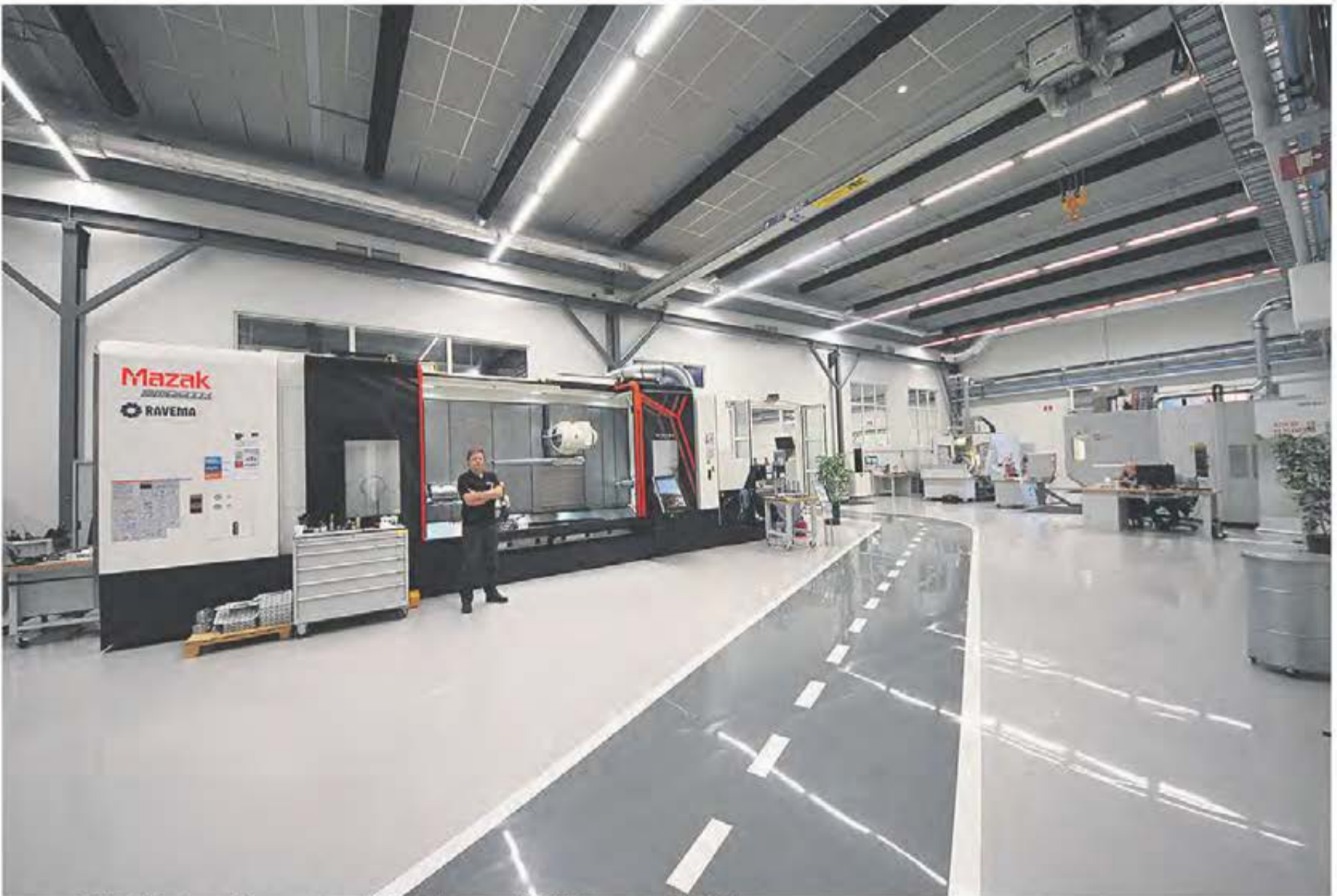
Secos nya Technical Center med den senaste maskininvesteringen, en MAZAK Integrex modell e500 H.
