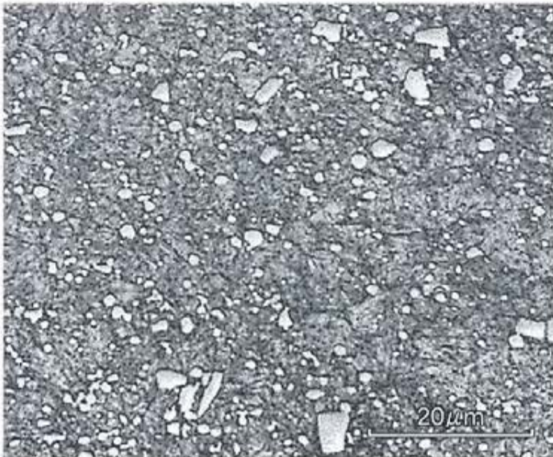
Mikrobild av tandspetsmaterialet M42 HSS
