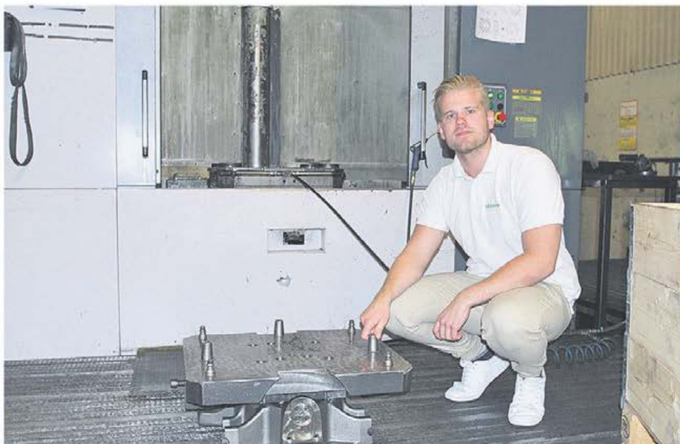
Produktionstekniker Alfred Jönsson visar nollpunktsystemet som ger tidsvinster och bibehåller hög kvalitet i processen.
