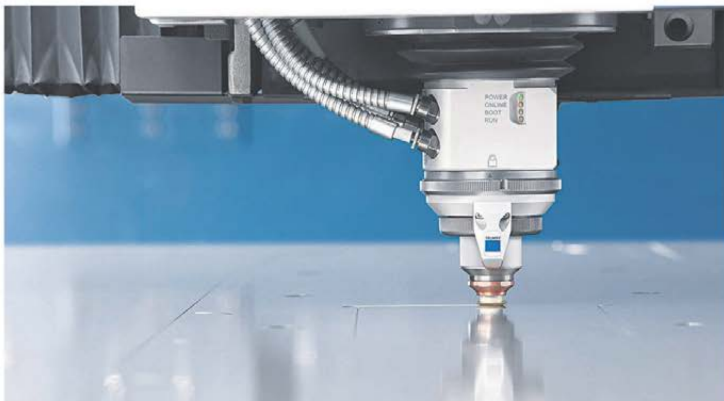
Ett nydesignat munstycke reducerar nitrogen konsumtionen med i genomsnitt 70 procent i Highspeed Eco processen. Som med Highspeed processen, ökar genomströmningshastigheten med så mycket som 100 procent.
