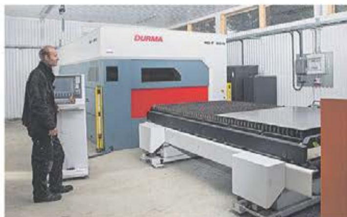
Durma laserskärmaskin med växelbord och 6kW fiberlaser.
