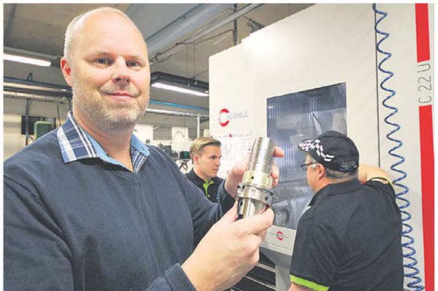
En annan verktyghållare som Anders Kock visade upp var en hydraulchuck HTC MAPAL med en kastjustering, framförallt väldigt bra om kunden har en brotschapplikation och kan ställa bort kastet i maskinspindeln som gör att hen får perfekta brotschhåll.
