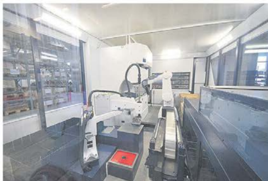
Holautomatisk böckning med vision och färdig produkt i pall.
