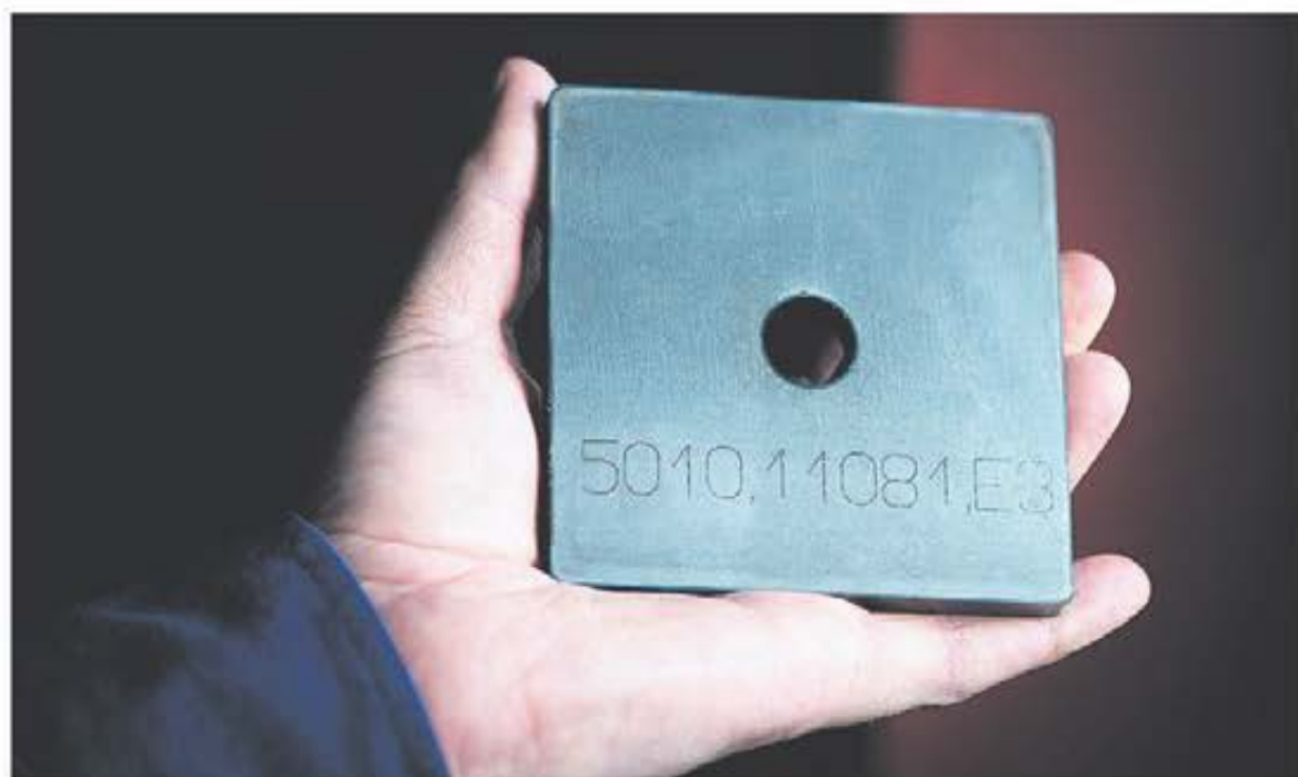
Det gäller för montörerna ute på byggarbetsplatsen att veta vilka plattor som hör till vilken stomme. Eftersom lasern graverar in ett unikt nummer på varje del, sparar det mycket tid, och säkerställer en säker slutinstallation.
