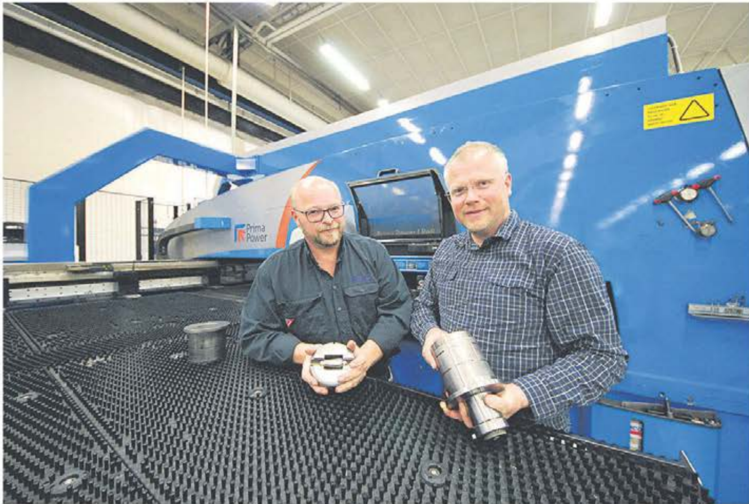
Jesper Nielsen och Daniel Johansson visar verktygen för den s.k. "hjulteknologin" eller vulsta som man också säger. Att arbeta i rostfri plåt och forma den på det sätt som man gör, framförallt när s.k. "hjulteknologin används, kräver en extrem precision i maskinen. Tack vare servodriften styr man stanslaget mycket exakt och resultatet blir optimalt.
