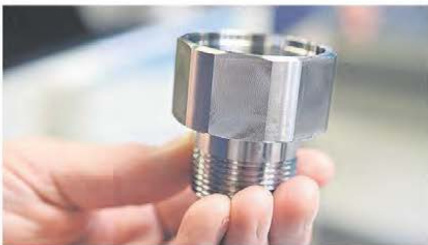
Detalj bearbetad från stång, helt klar i en uppspänning. Magasinet från IEMCA tillåter en stängdiameter på 85 mm.
