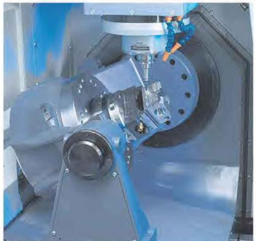
Med fast spindel och vridning av arbetsstycket uppnås alltid högsta precision.
