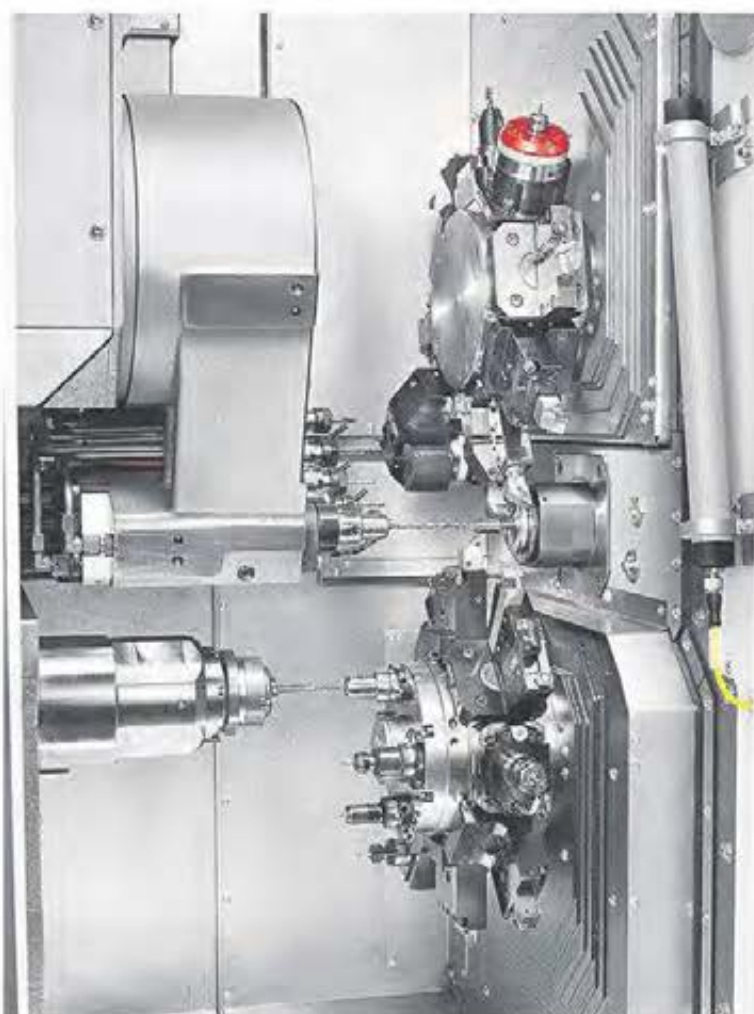
TRAUB TNL20-9B med B-axel i övre revolvern bearbetar komplexa detaljer i valfri ingreppsvinkel.
