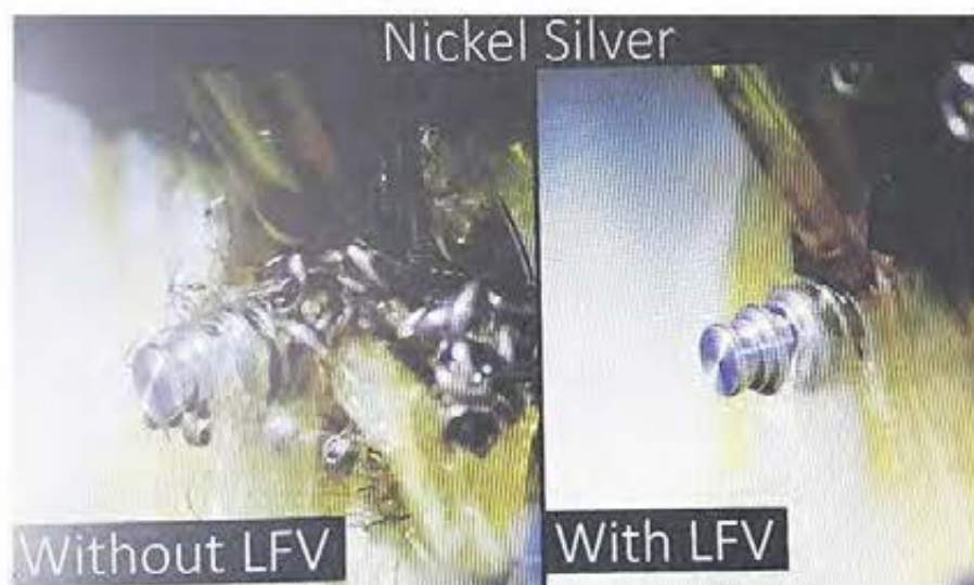
Citizen's LFV funktion vid bearbetning av nickel silver material.
