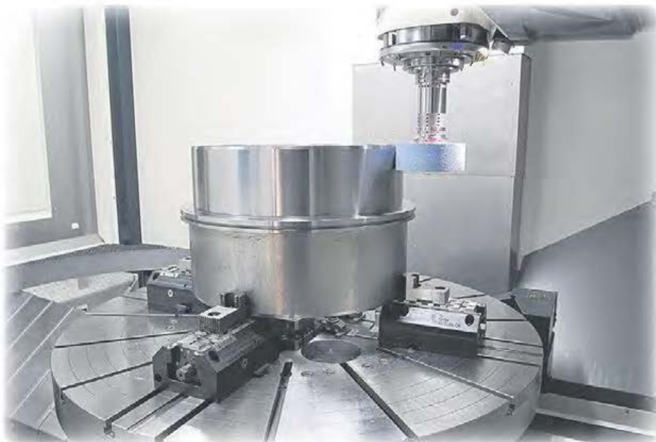
Här kan nu Pretak slipa stora detaljer upp till 1 600 mm i diameter på samma maskinbord som övrig bearbetning, fräsning svarvning borming och slipning allt i en uppspanning, unikt!
