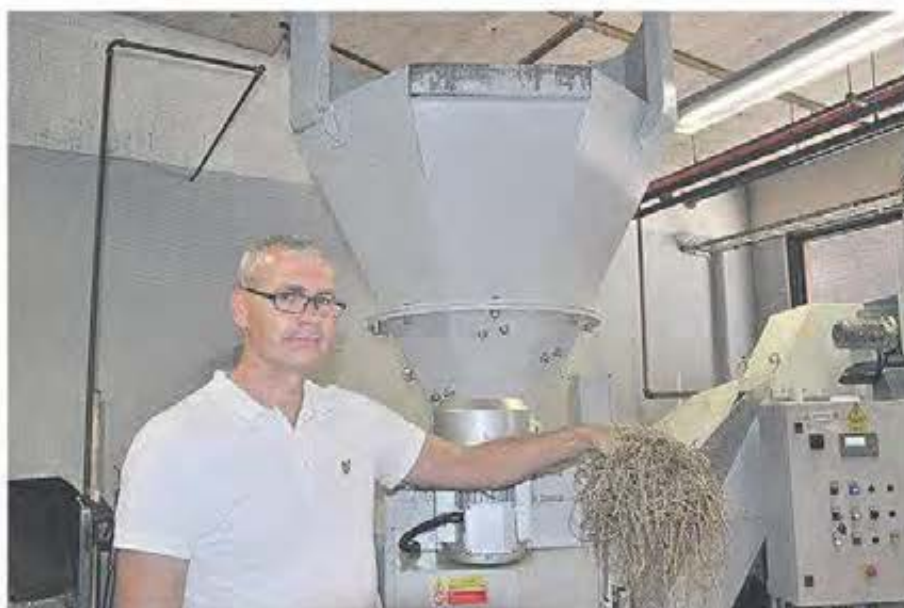
Produktionschef Ola Petersson visar långa spånor som skall hanteras i den nya utrustningen från INDASS.
