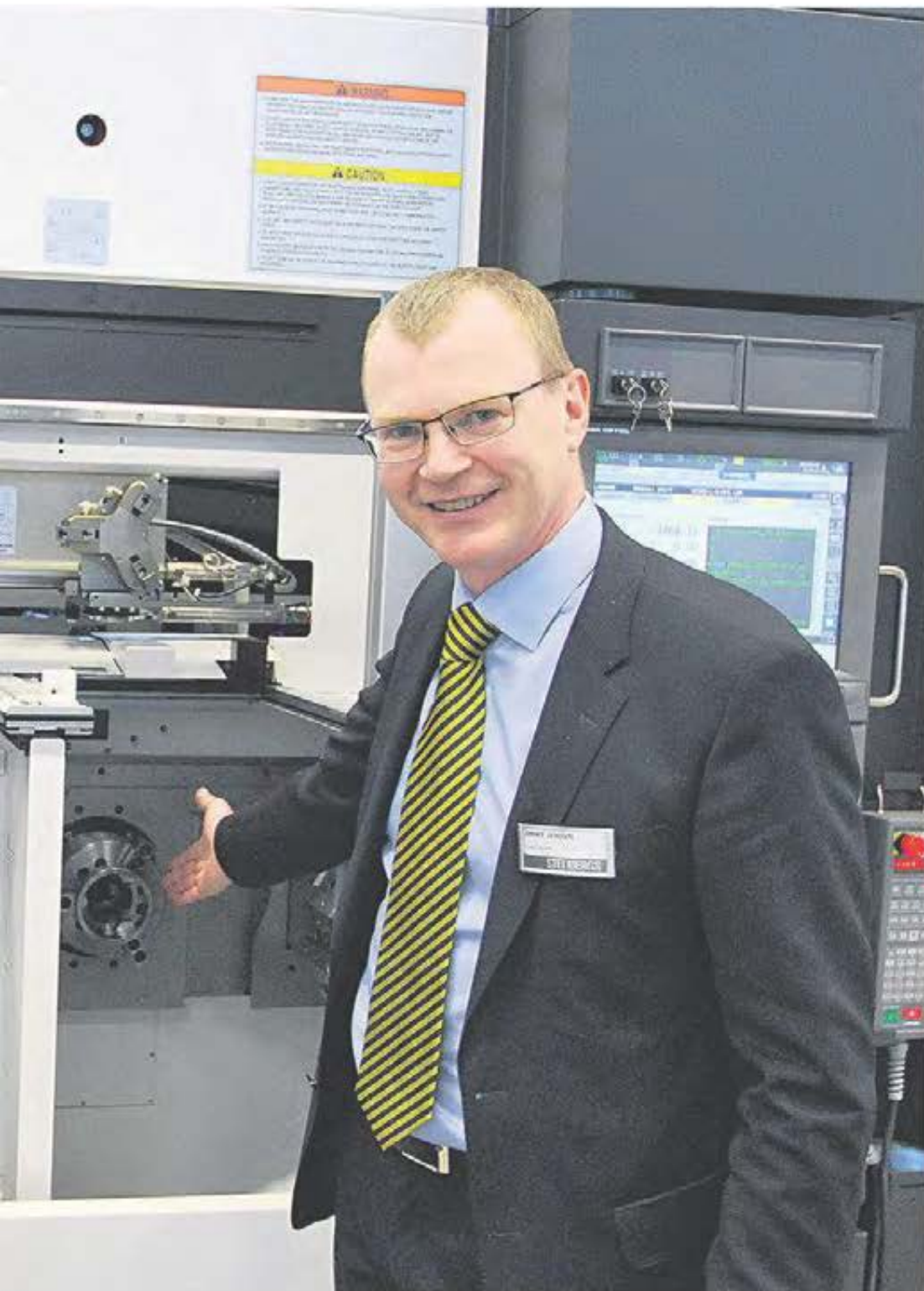
OKUMA 2SP-150H, två-spindlig CNC-svarv för komplett bearbetning av kutsdetaljer. Kan utrustas med integrerat laddningssystem och drivna verktyg. Tord Löfgren och Jimmy Jensen visade maskinen för besökarna.
