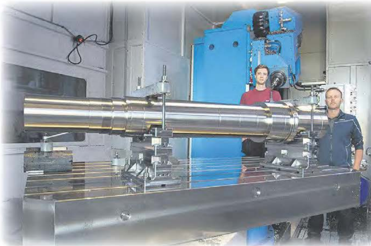
Operatör Tobias Sjöberg och produktionschef Henrik Fredriksson. – Här ser vi en komponent för papper och massaindustrin med ett högt förädlingsvärde och här har vi mångårig erfarenhet av att bearbeta denna typ av detaljer. Här pratar vi komplex borrar i långa hål med lagerlägen och kast på en 100-del, väldigt snäva toleranser, säger Henrik Fredriksson.
