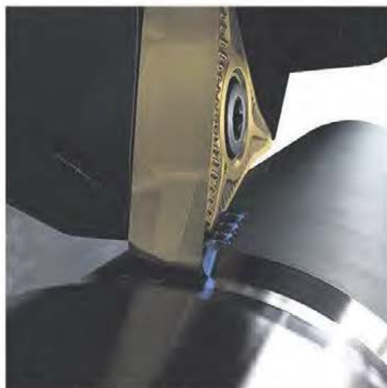
CoroTurn Prime i aktion – eftersom man skär bort från skuldran finns ingen risk för spånstockning.
