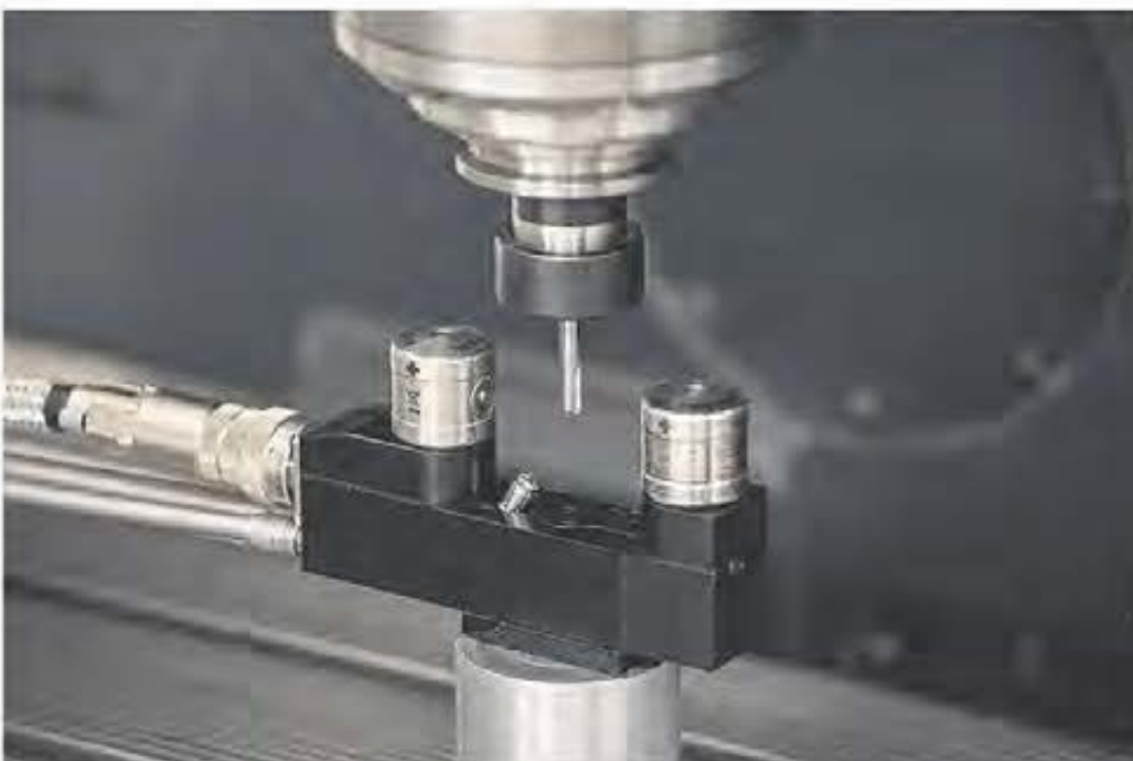
NC4 är utrustad med integrerad tryckluftsrengöring och uppnikningsmål
