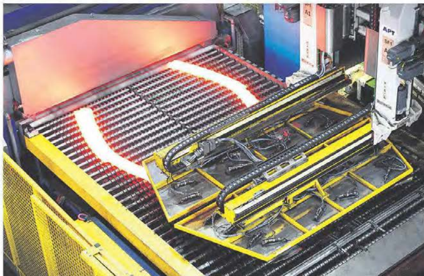
Att ämnet värms upp, formas och kyls ner vid exakt rätt temperaturer är avgörande för att den färdiga fordonsdetaljen ska få de materialegenskaper som eftersträvas.
