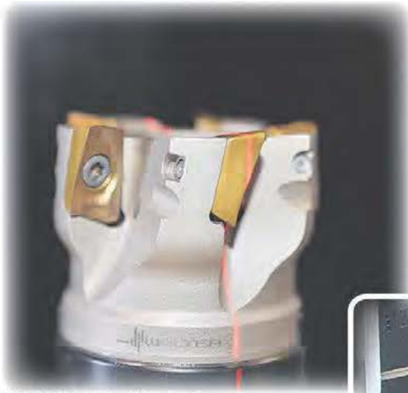
Walter hörnfräs diameter 50 mm med Tiger-Tec Gold skär för bearbetning av svart material och gjutgods.
