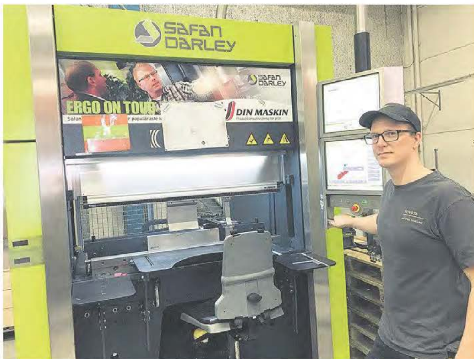
Operatören Tomas Svensk vid den nyligen installerade servoelektriska kantpressen i ergoutförande från Din Maskin.
