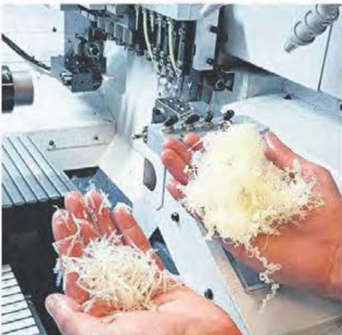
Citizen's LFV funktion vid bearbetning av plast – perfekt spänkontroll!
