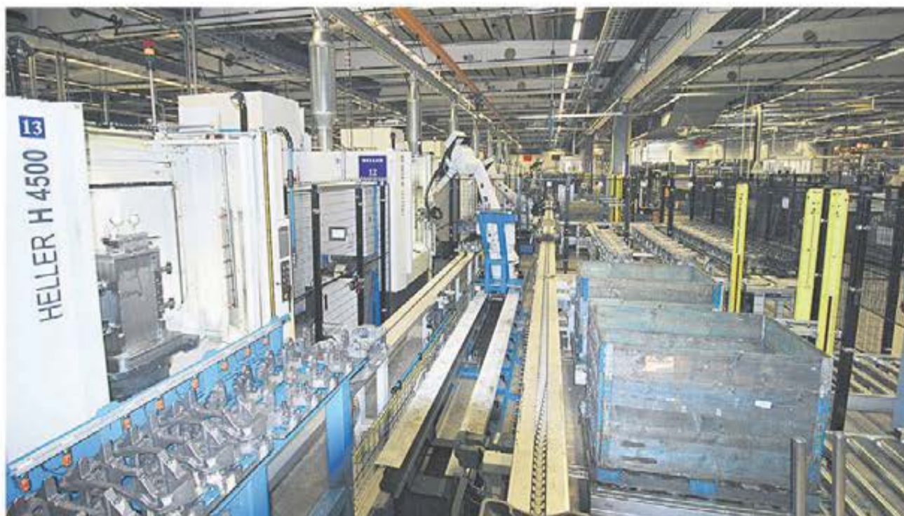
Heller H 4500 utrustad med HSK 100 kona, nödvändigt för tuff bearbetning i besvärligt material som gljutjärn.
