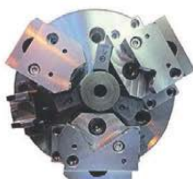
Kitagawa PW-10 Kraftchuck 3-backig kraftchuck med nedåtdragande och pendlande backar.
