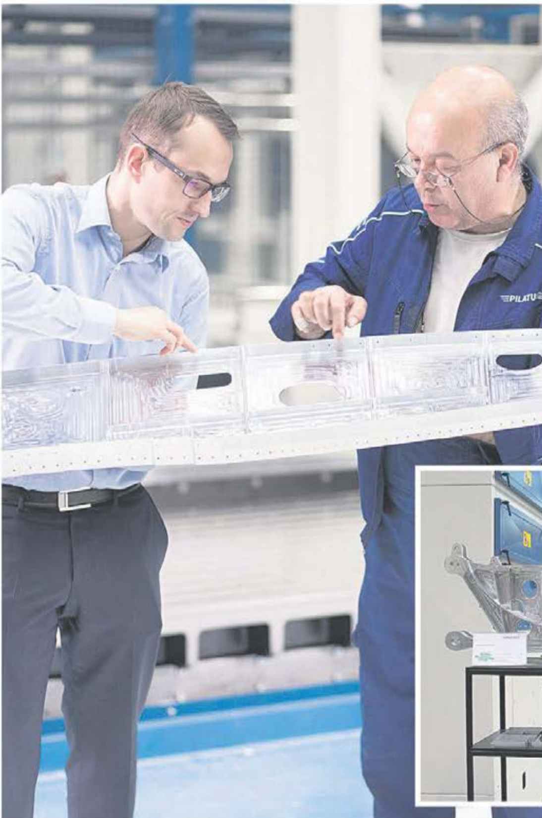
Detalj till multi role flygplanet PC-12: 380kg råmaterial bearbetas ner till en färdig detalj på 35kg.
