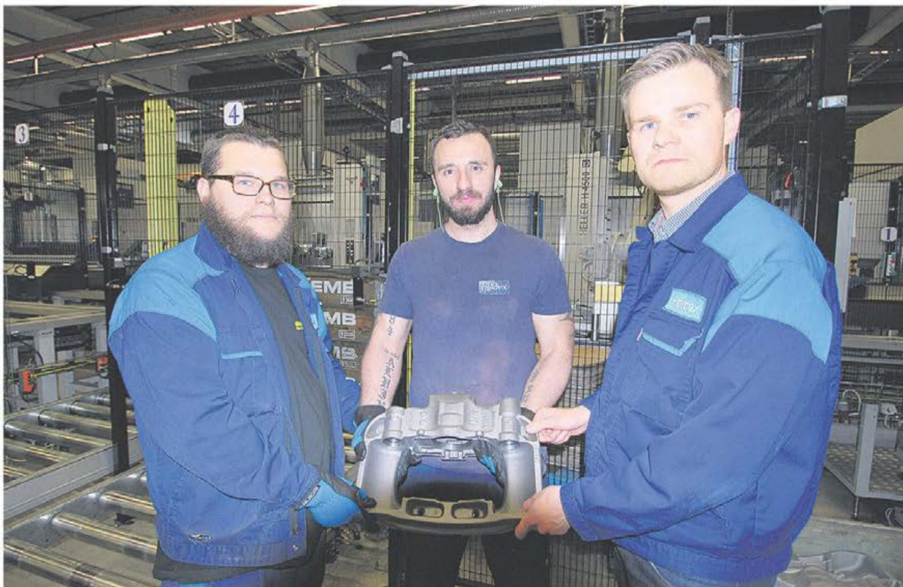
Maskinoperatörerna Simon Karlsson, Alisa Harris och produktionschef Philip Andersson visar en av de produkter som tillverkas i en högt automatiserad process. På ett bromsok avverkar man ca. 2 kg spånor, från råämne till färdig produkt. Och det handlar om tuff bearbetning med många kombinationsverktyg för att reducera cykeltider.
