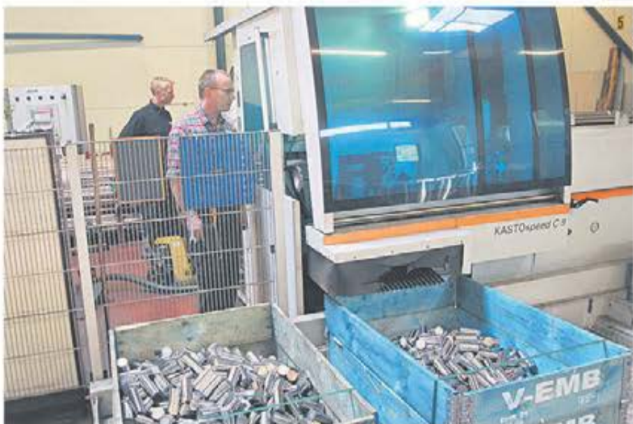
Anders Wennberg övervakar kapningen i KASTO speed C9 klingkap. - Vi kan ladda material upp till 5 ton och här ser vi snabb precisionskapning av kuts med fin yta.
