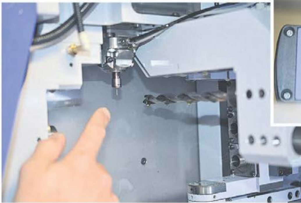
Simon Larsson pekar på högfrekvensspindeln från IBAG med prestanda på 60 000 rpm för mikroborming av extremt små hål - här "så stort som" 0,7 mm i dia. Intill den är borenheten monterad som möjliggör en verktyglängd om ca 180 mm mot huvudspindeln.
