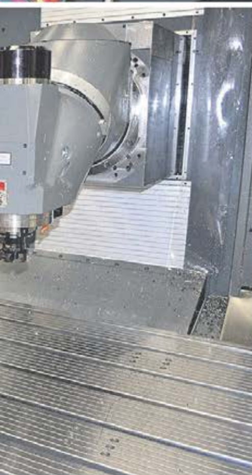
KPK Plåt och Maskins nya Lagun BF-4000, en bäddfräs med verktygsväxlare för 40 verktyg samt inbyggd mätpropp för uppmätning med protokoll.
