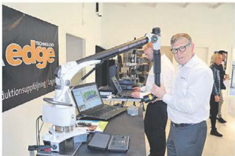
Lennart Hedman, Area Sales Manager på Hexagon, demonstrerade laserscanner RS4 som används tillsammans med ROMER Absolute mätarm.
