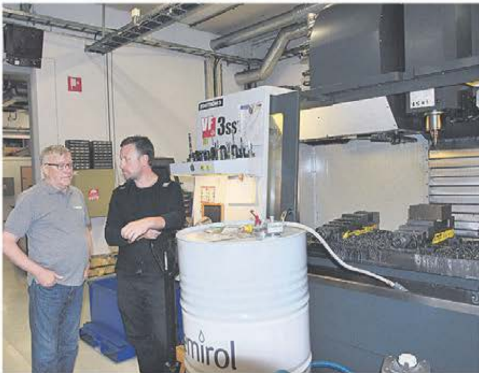
Bengt-Åke Beng och Roger Fransson pratar miljöfrågor medans man fyller tanken med skärvätska. – Vi använder en faktometer och mäter skärvätskans kondition. Är värdet för högt fyller vi på med vatten och i detta fallet så är värdet för lågt och då håller vi i skärvätska.
