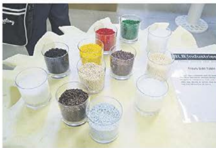
BLB Industries 3D-skrivare arbetar i olika material som ABS, Svart färgämne, PLA med 50% träfiber, PLA med 20% träfiber, Gul färgämne, Återvunnet PET, Röd färgämne, PLA 30% koppar, Grön färgämne, PCL, TPE och PP.
