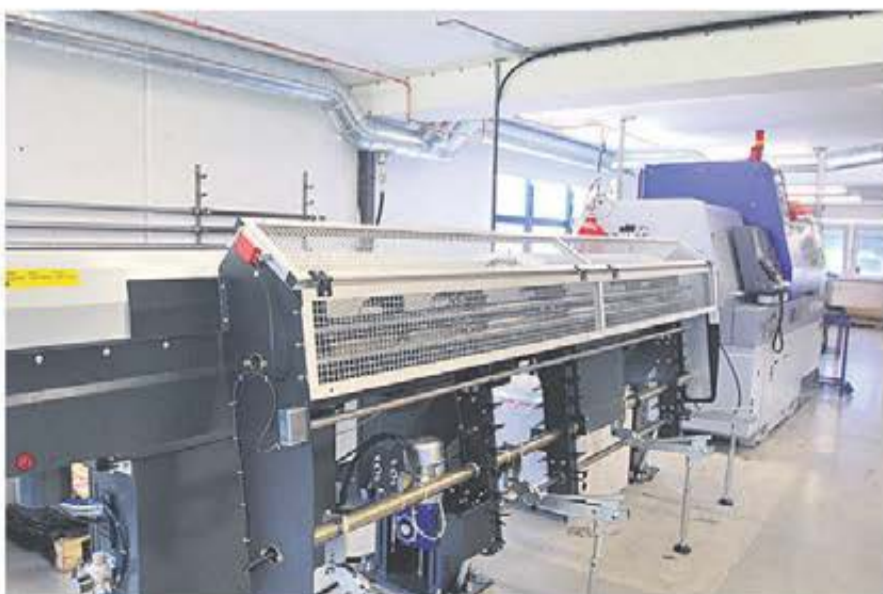
En av två Star SR 38 - En tungviktare med stor flexibilitet, framtagen för grov bearbetning med höga krav. Utrustade med 3 meters stångmagasin från LNS.
