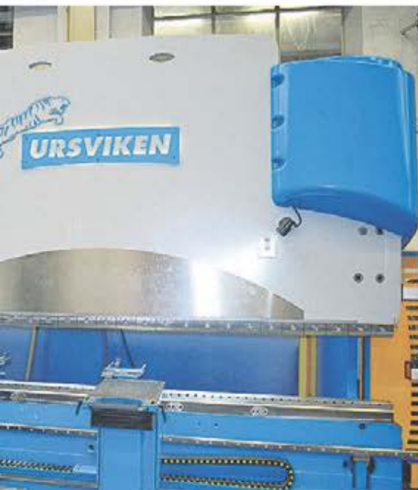
Svensk tiger. Operatör Mats Andersson programmerar Ursvikens kantpress Optiflex 200 TON efter det han ska tillverka.
