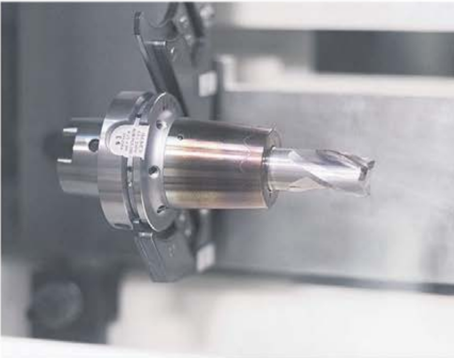
Dom nya bearbetningsmaskinerna hos Pilatus i Stans är utrustade med verktyghållare från HAIMER (bilden visar: krymp chuck med HSK-A 63/80 interface) bild: HAIMER
