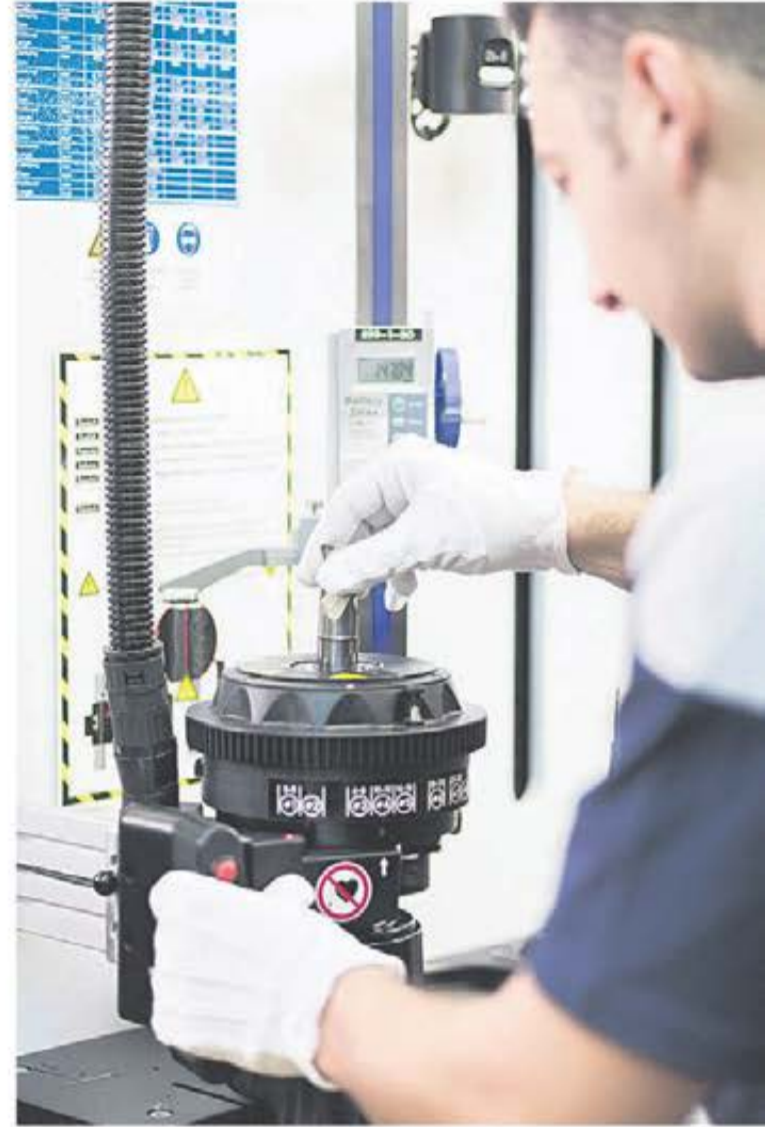
Enkel och noggrann krympprocess: för varje HAIMER krymp chuck finns nödvändiga parametrar redan integrerade i HAIMERS Power Clamp Premium maskin.
