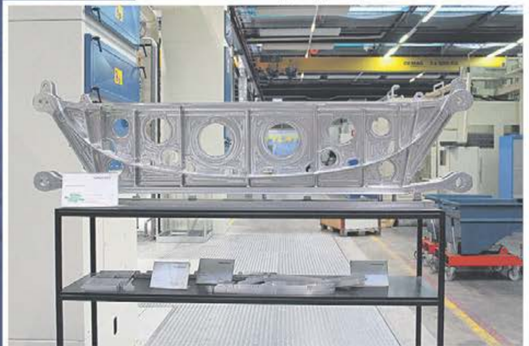
Detalj till multi role flygplanet PC-12: 380kg råmaterial bearbetas ner till en färdig detalj på 35kg.
