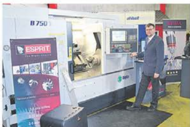
Kjell Gallneby, säljare på Ahlsell Maskin, visar upp Biglia B750 som är en rejäl, kraftfull svarv med beprövad konstruktion, y-axel och subspindel.
