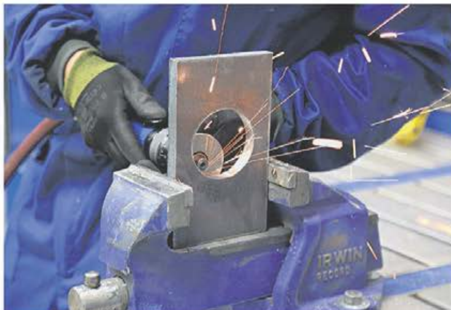
Vid rundning av öppningar och kanter ger NorBevel en större och rundare yta vilket ger ett bättre underlag för målning och lackering. Tack vare den rundare formen behövs oftast inte packningsringar för att undvika slitage vid exempelvis kabelgenomföringar.
