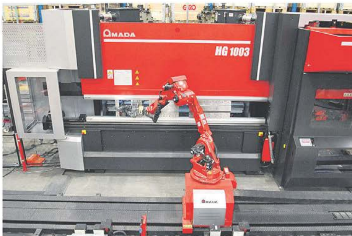
AMADA HG 1003 kantpress, utrustade med ATC kabinett för automatisk verktygsväxling. Den ena maskinen helautomatisk den andra är manuell med operatör, vilket ger stor flexibilitet när det gäller att planera körningarna. Korta serier, svåra bockningar framförallt men operatören slipper byta verktyg och här sparar man mycket ställtid.
