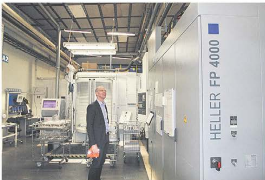
Olof Karlsson visar upp en unik cell för blandad körning av olika serier, Heller FP 4 000, en 5-axlig maskin med Fastems FMS ställage för främst obemannad körning av mindre serier därav det gigantiska verktygmagasinet på 480 verktygsplatser.
