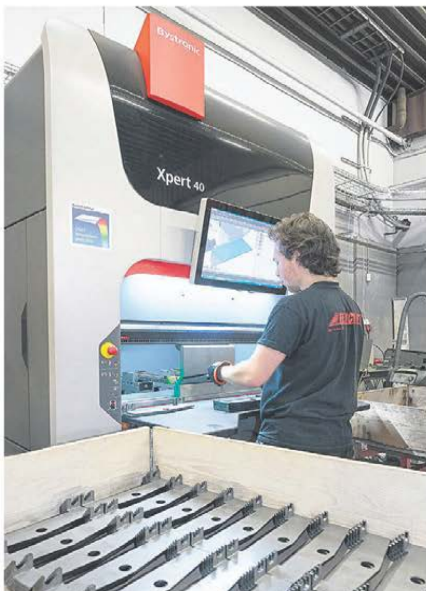
Kenan Karavdic är imponerad av den lilla kantpressen Xpert 40. Bitar upp till en meter långa kan bockas utan problem.
