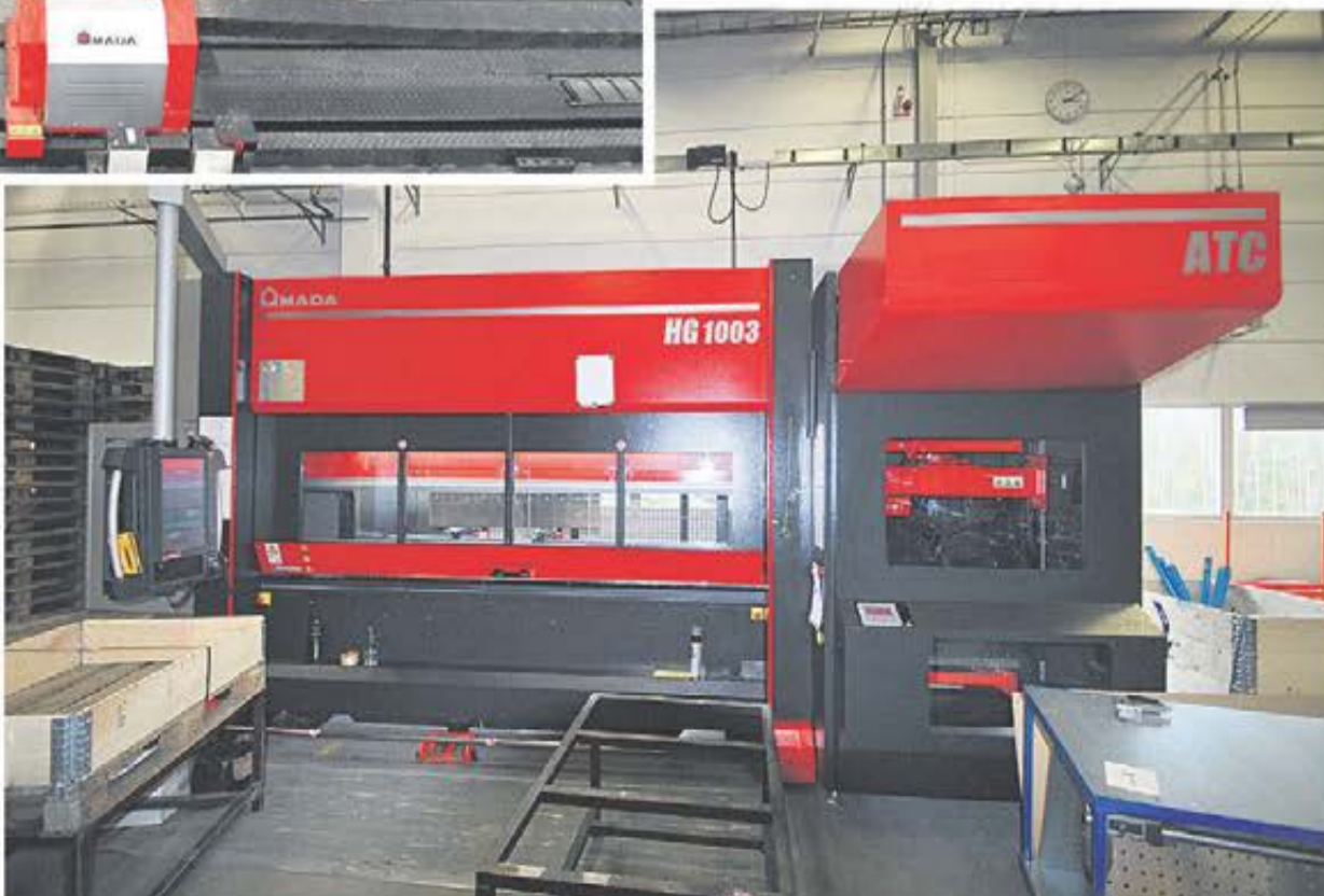
AMADA HG 1003 kantpress, utrustade med ATC kabinett för automatisk verktygsväxling. Den ena maskinen helautomatisk den andra är manuell med operatör, vilket ger stor flexibilitet när det gäller att planera körningarna. Korta serier, svåra bockningar framförallt men operatören slipper byta verktyg och här sparar man mycket ställtid.
