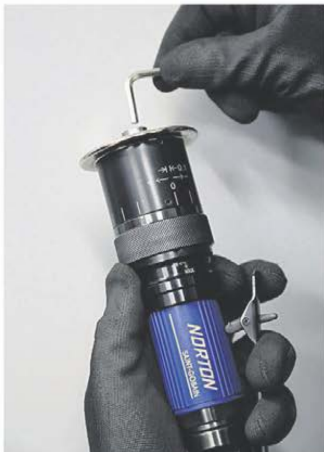
Byte av fräshuvud görs med ett enda verktyg (insexnyckel) och utförs mycket snabbt och enkelt.
