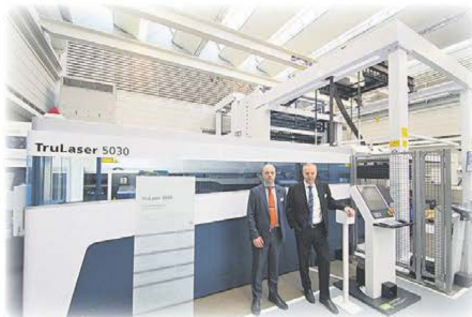
TruLaser 5030 är en av de senaste investeringarna som man gjort på Tryckta i Markaryd. – Maskinen är integrerad i ett helautomatiskt lagersystem. Maskinen har ett arbetsområde på 3 000 x 1 500 mm och skär i upp till 25 mm i kolstål och med kopplingen till lagersystemet används anläggningen för obemannad körning, berättade Bengt-Ove Johansson på INTECH i Tyskland.
