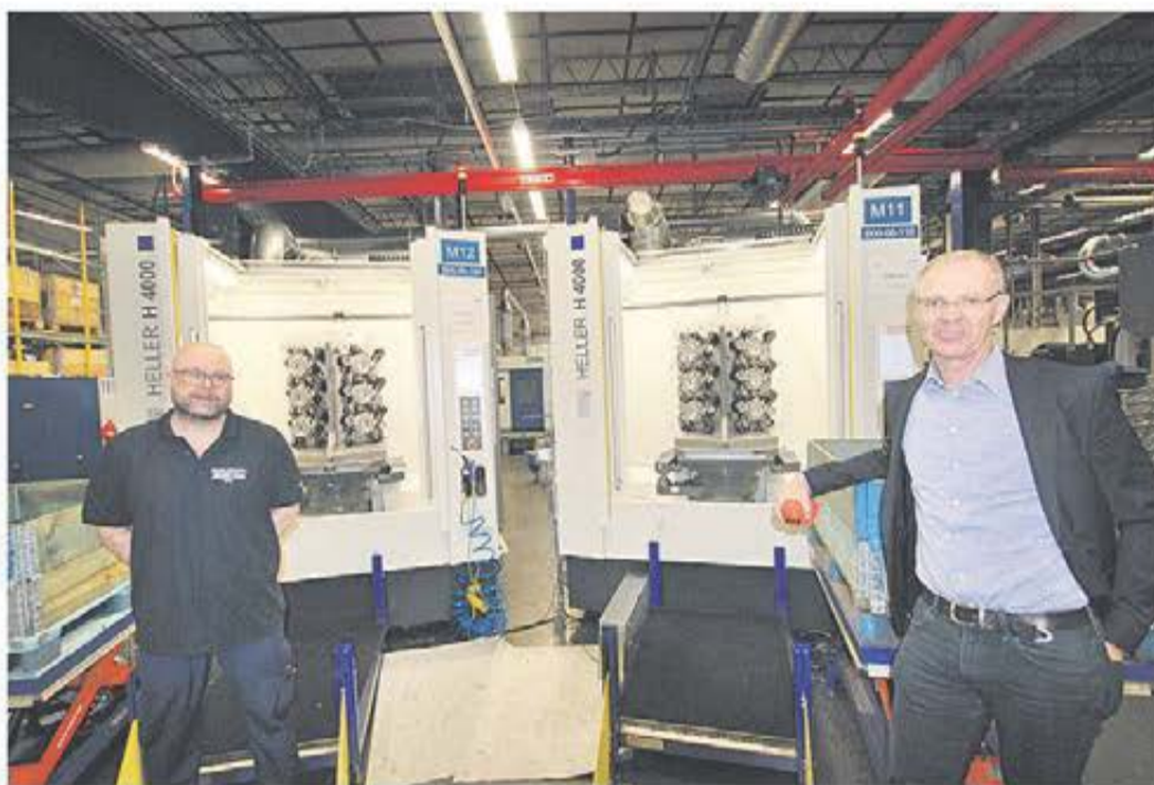
Patric Carlström och Olof Karlsson visar Heller H 4000 med standardiserad fixturering och automation.
