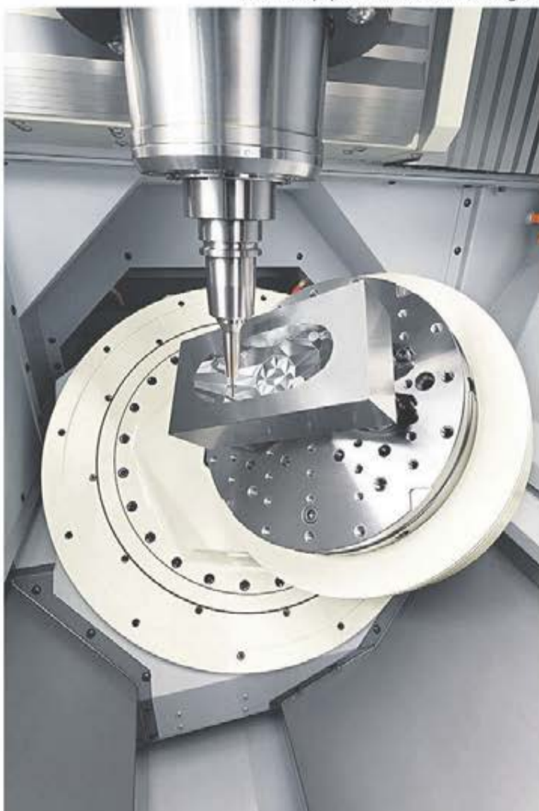
Det styva och dynamiska 5-axelbordet liknar den populära Makino D800Z-designen
