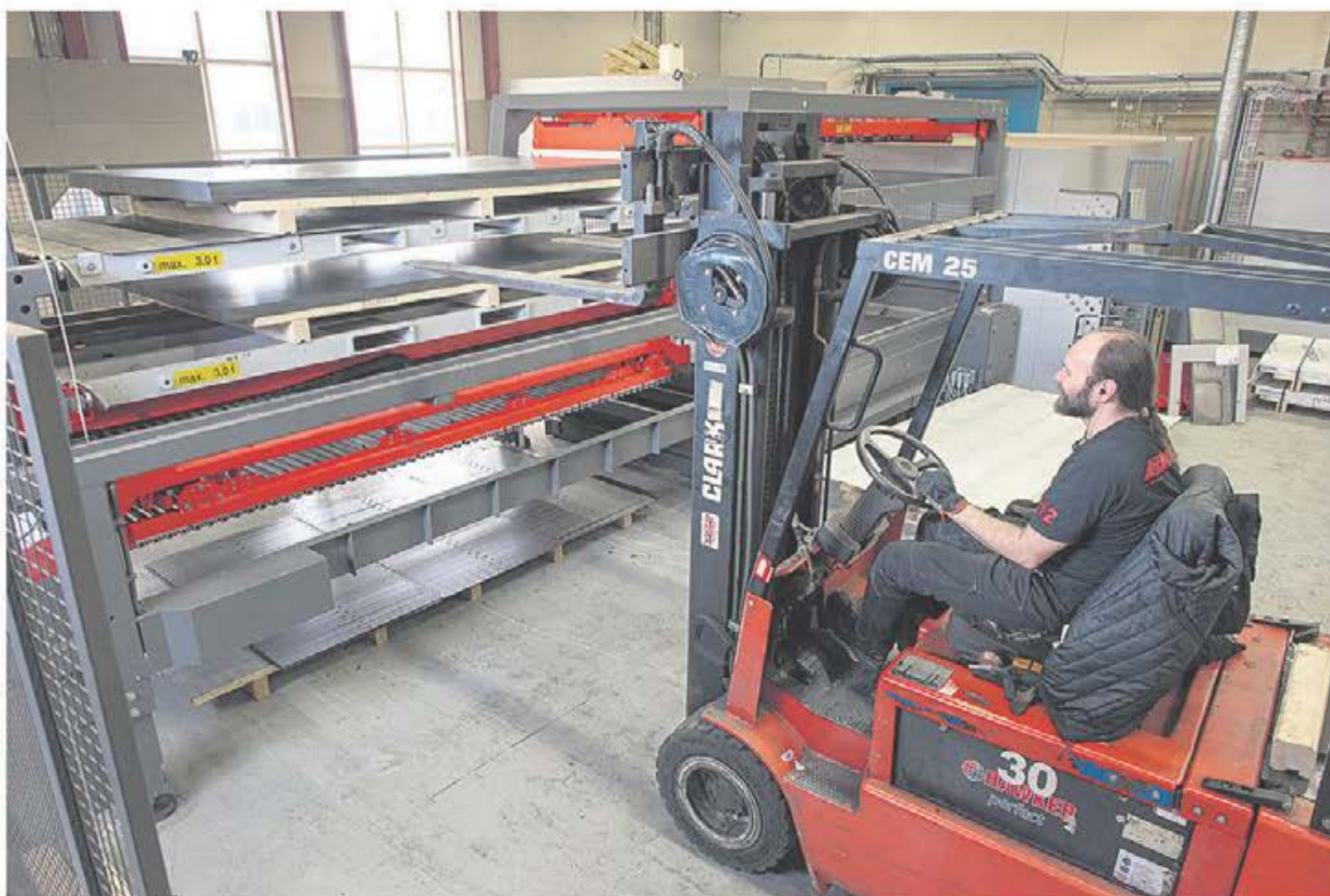
Ungefär 500 ton plåt förädlas årligen. ByTrans Extended kan vid behov laddas med 6 ton plåt och lägger i plåtarna som ska skäras och lastar ur de färdigskurna bitarna automatiskt. På morgonen när man kommer är det bara att paketera och leverera till kunden! Thomas Fransson laddar!
