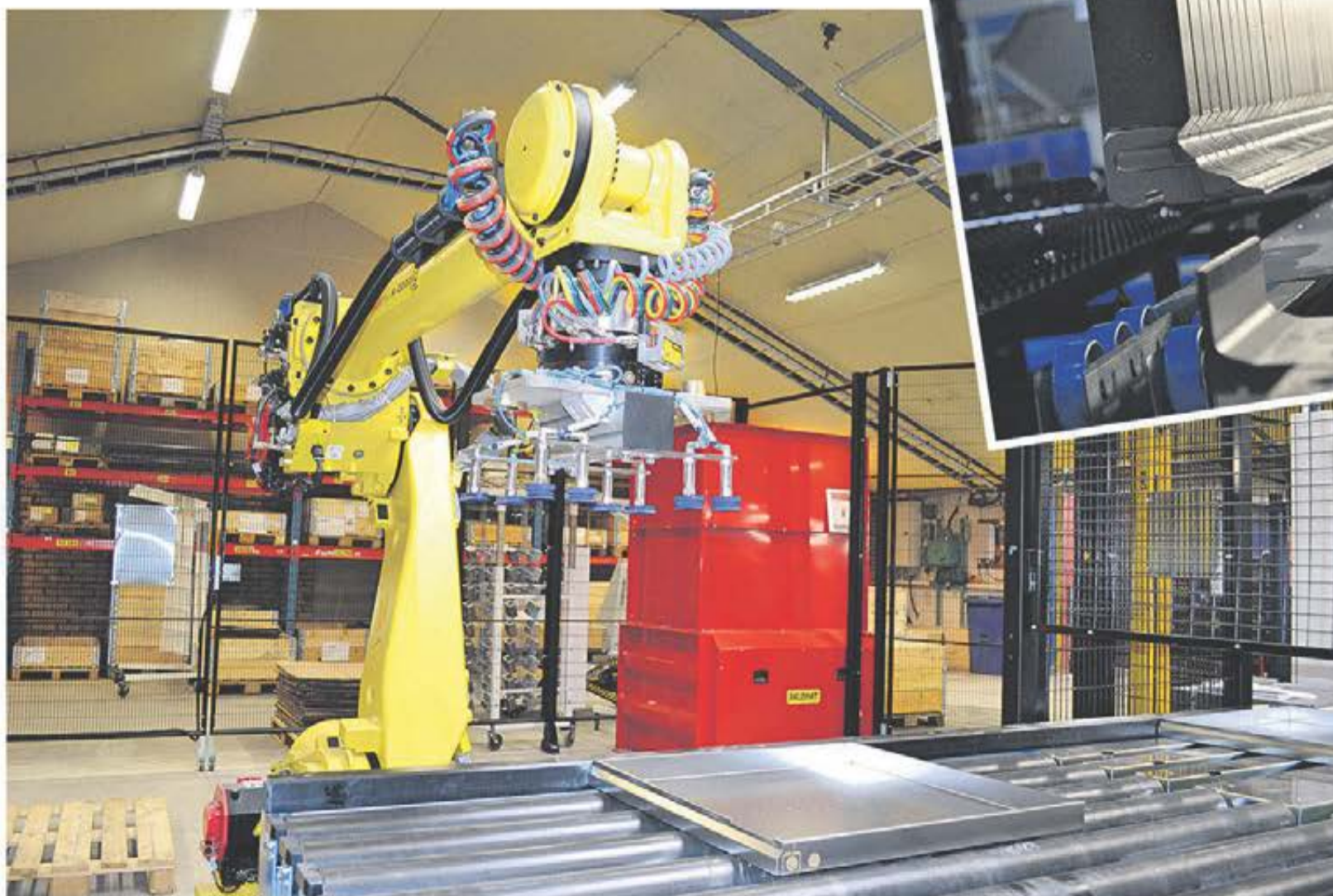
Med exakt repeterbarhet, stor nyttolastförmåga och extra stor räckvidd passar roboten FANUC R-2000iC/125L utmärkt för stapling av de färdigbockade produkterna. Roboten byter gripdon med automatik efter vilken produkt som har bockats. Gripdonen kan kombinera sugkoppar, magneter och tänger. Detta ger tillsammans med de sex axlarna största möjliga flexibilitet.
