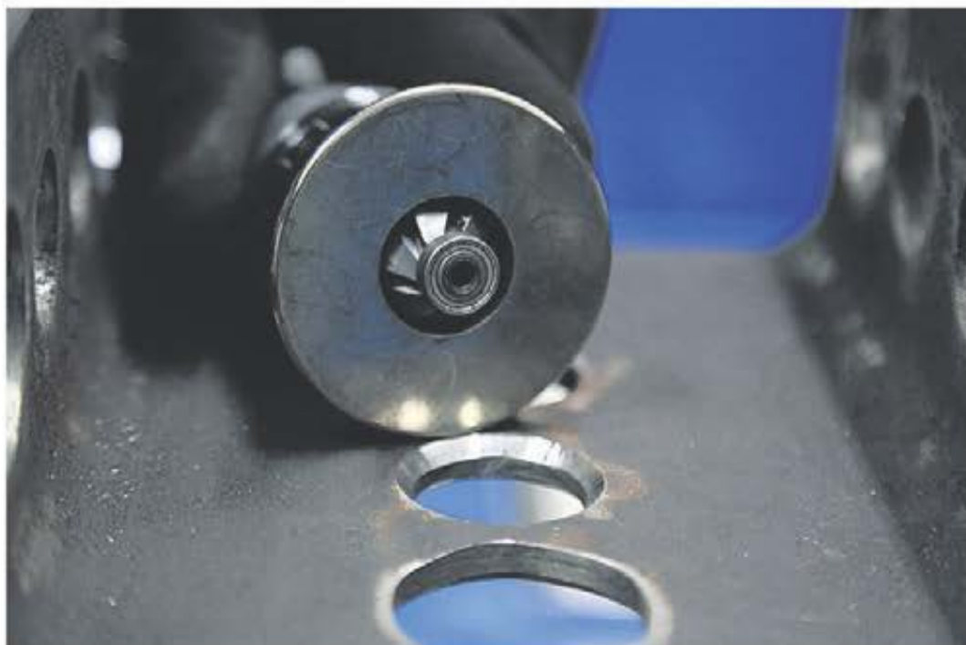
NorBevel-6, som är en mindre maskin, är speciellt lämpad för fasning och rundning av t. ex mindre hål och öppningar från 18 mm diameter.
