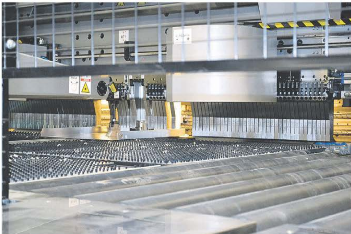
Att bockautomaten är helt servoelektrisk istället för hydraulisk ger inte bara en överlägsen precision i bockningen, det ger också minimala drifts- och underhållskostnader och är utmärkt för miljön.
