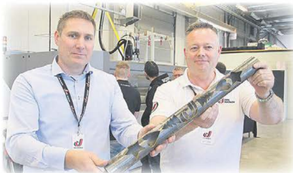
Karl-Magnus Skepö och Thomas Häggglund visade vattenskuret material i form av ett rör, här skuret med 5-axlig teknik. Materialet späns fast i en chuck.
