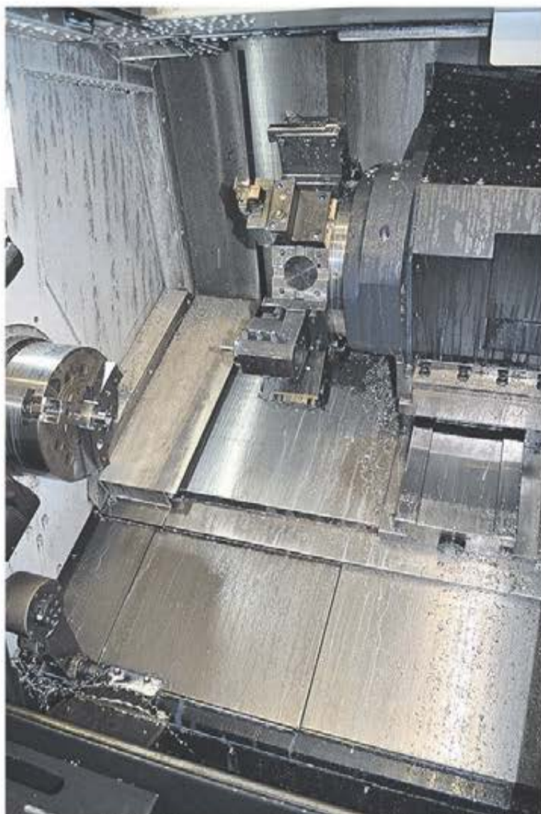
Strömmarnas Verkstads Doosan Puma 2600M, som har spindelvarvtal på 3500 varv per minut och en svarvdiameter på 370 millimeter, utrustades med kortstångmagasinet Quick Load Servo III från LNS. Magasinet har en stångdiameter på mellan 6 och 120 millimeter och en stånglängd på 260 till 1600 millimeter.
