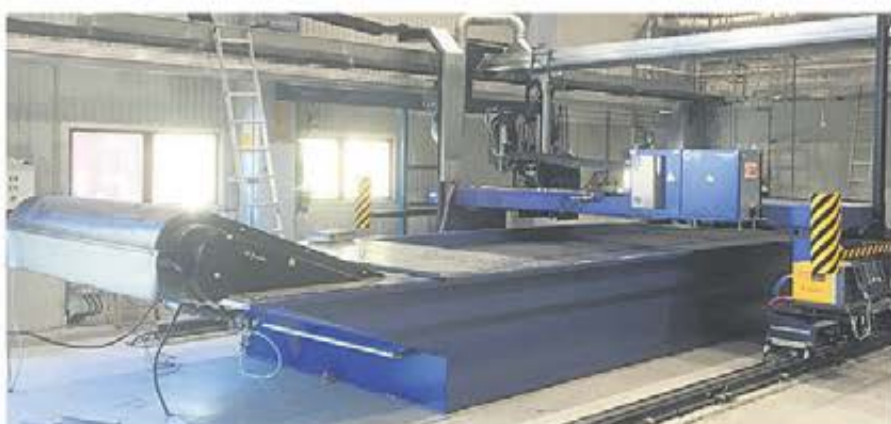
Messer MultiTherm hos Valmet med kraftfull HyperTherm, fasskärning samt skärbord med utmatning
