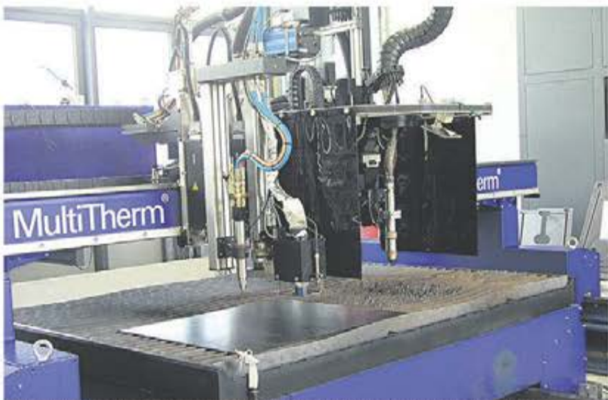
Messer MultiTherm med Alfa gasbrännare samt fasaggregat för plasmaskärning
