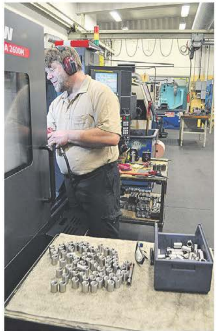
Maskinoperatör Magnus Svensson gångar rostfria nipplar i Doosan Puma 2600M.
