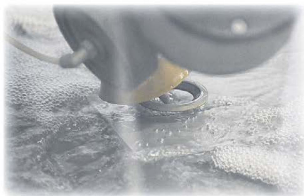
Karl-Magnus Skepö och Thomas Häggglund visade vattenskuret material i form av ett rör, här skuret med 5-axlig teknik. Materialet späns fast i en chuck.
