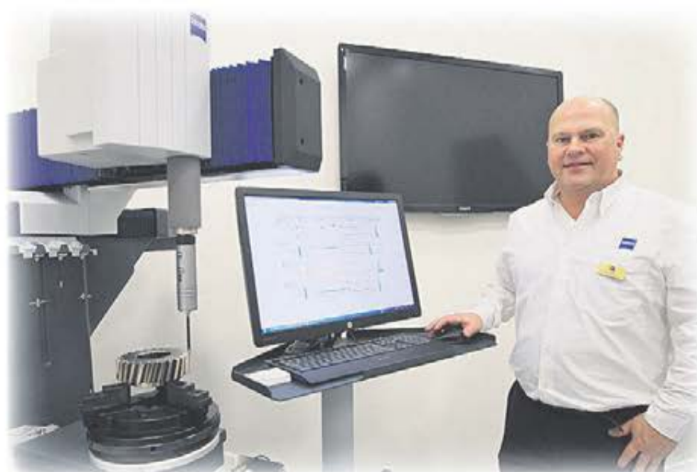
Björn Stelin visade mätmaskinen DuraMax som är byggd för att stå ute i produktionen och t.ex. leverera data för kompensation till en fleroperationsmaskin. Maskinen är utrustad med ett rundbord och den har en mätvolym på 500 x 500 x 500. Mät noggrannheten beroende på temperatur i verkstaden ligger runt 2,5 – 2,8 \mu\text{m} .
