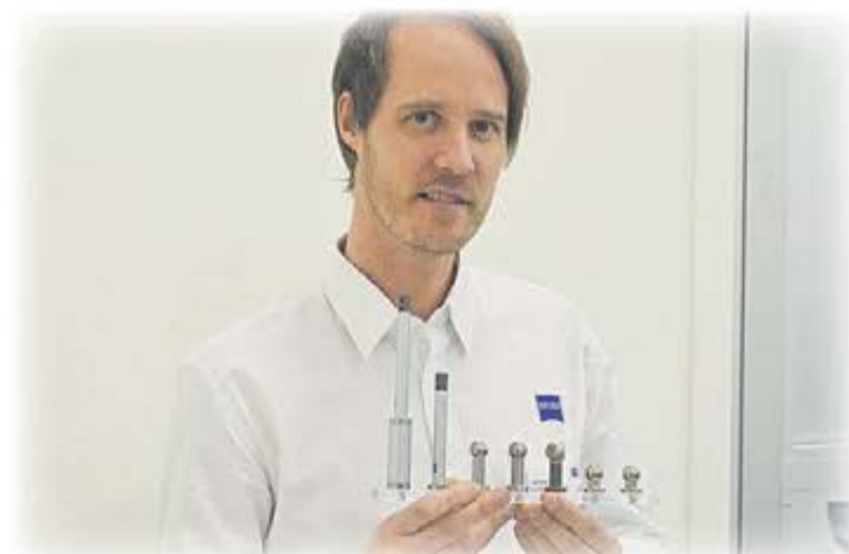
Jens Sjöberg på applikation visar en del av ZEISS stora utbud av bl.a. mätspetsar, förlängare, mätspetskopplingar m.m. som håller mycket hög kvalitet för att säkerställa den högsta noggrannheten.
