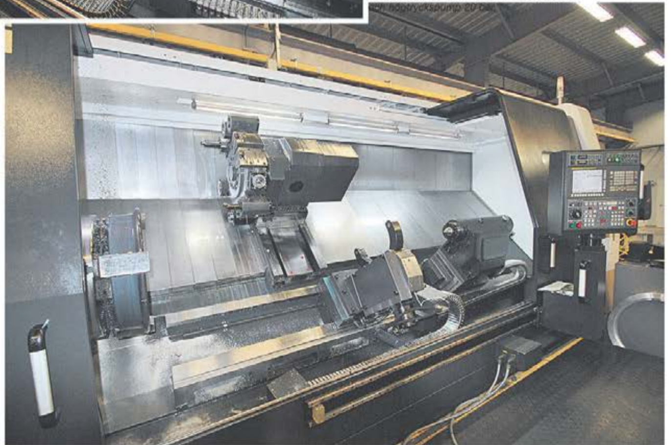
Hyundai L 700 LMA med imponerande svarvlängd max 3 250 mm. Utrustad med bl.a stödlager Atling AX8.5, 24" 3-backchuck och höstryckspump 20 bar.
