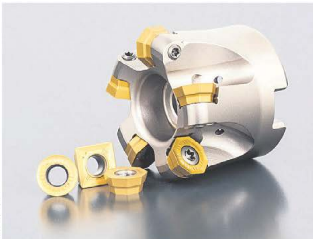
Pramets fräsar minskar ställtid och lagerhållning tack vare de unika skärlägena som kan bära åttkantiga, runda och fyrkantiga skär.
