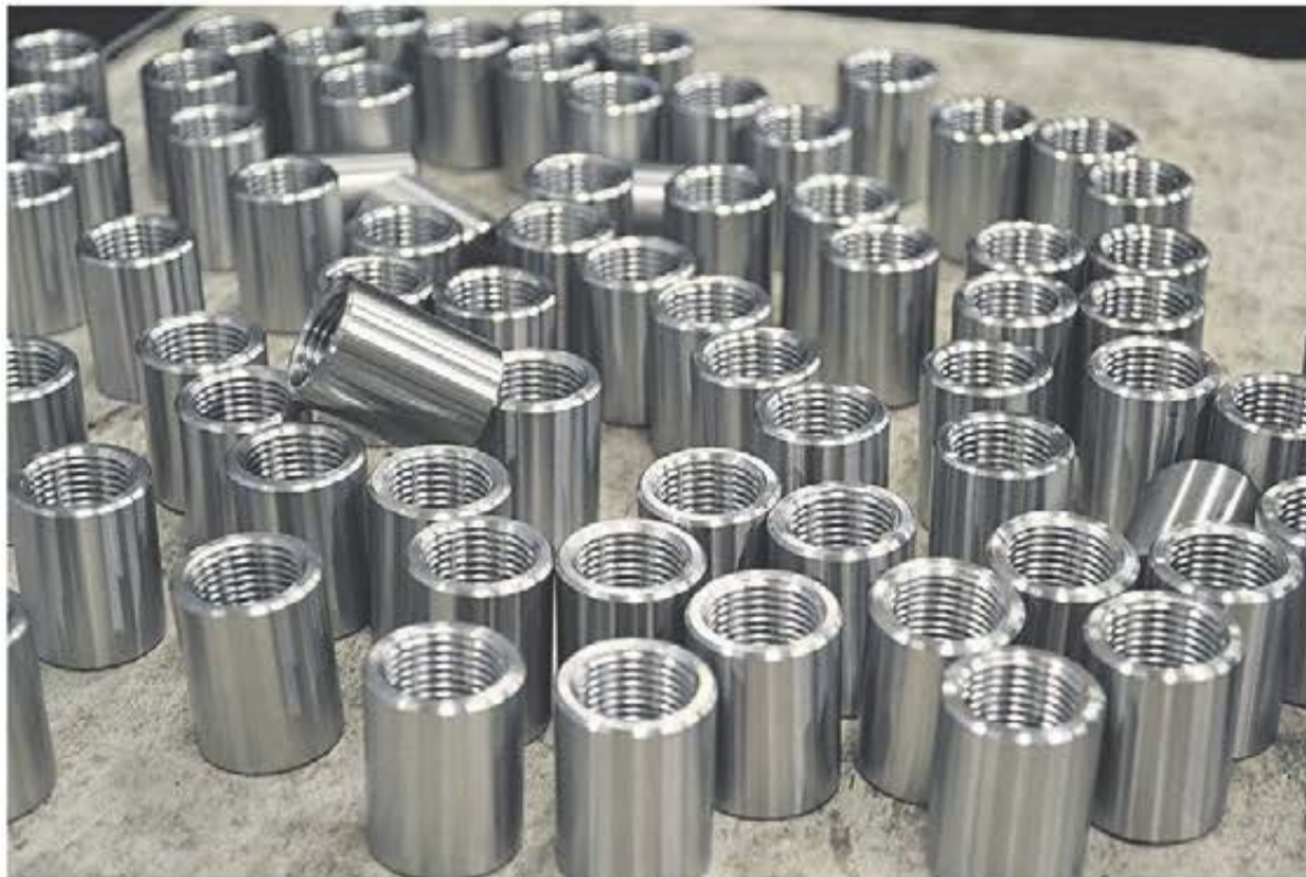
I den nya svarven Doosan Puma 2600M göngas rostfria nipplar till bränslerör som installeras i entreprenadmaskiner inom olika branscher.
