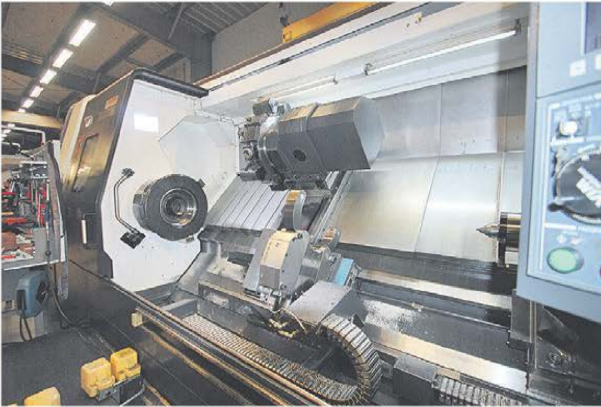
Hyundai L 700 LMA med imponerande svarvlängd max 3 250 mm. Utrustad med bl.a stödlager Atling AX8.5, 24" 3-backchuck och höstryckspump 20 bar.
