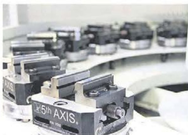
Monterar man skruvstyckena på paletter ges möjlighet att effektivisera arbetsflödena i produktionen.
