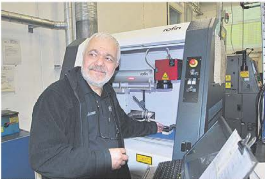
På verkstaden har man en lasermärkare av fabrikat Rofin för märkning av detaljer och skyltar.
