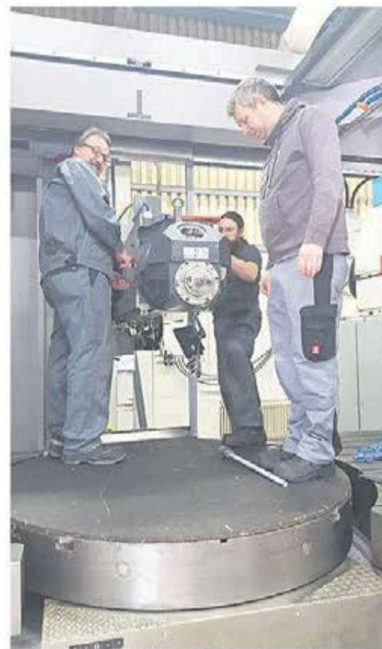
Installation pågår, fråshuvud och rundbord i fokus.
