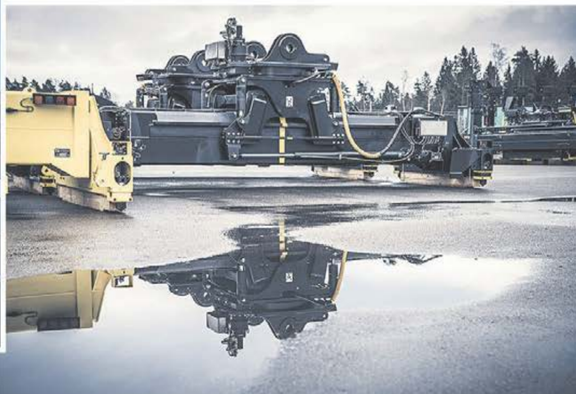
Produkterna tillverkas i 5 grundmodeller med ett hundratal varianter där kunden kan bygga sitt aggregat enligt ett system av moduler för sina individuella krav och funktion. Det handlar om material i högkvalitativt stål för att klara de påfrestningar som hanteringen av containere, lastade eller tomma, i höga farter och med vikter upp till 45 000 kg. Oket anpassas efter ett interface beroende på om det sitter på en gaffeltruck, kran eller Reach Stacker.
