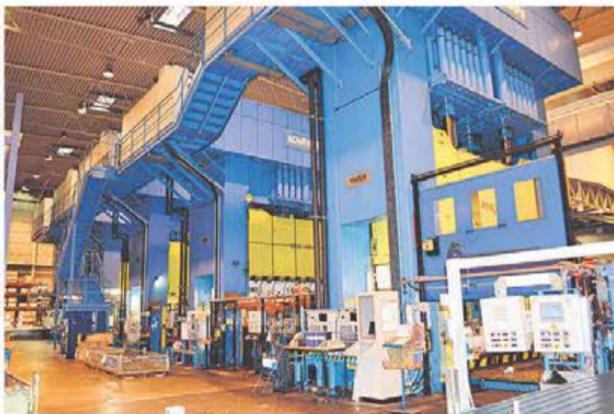
Den stora presslinjen på EBP där en press har presskraft på upp till 1200 ton.
