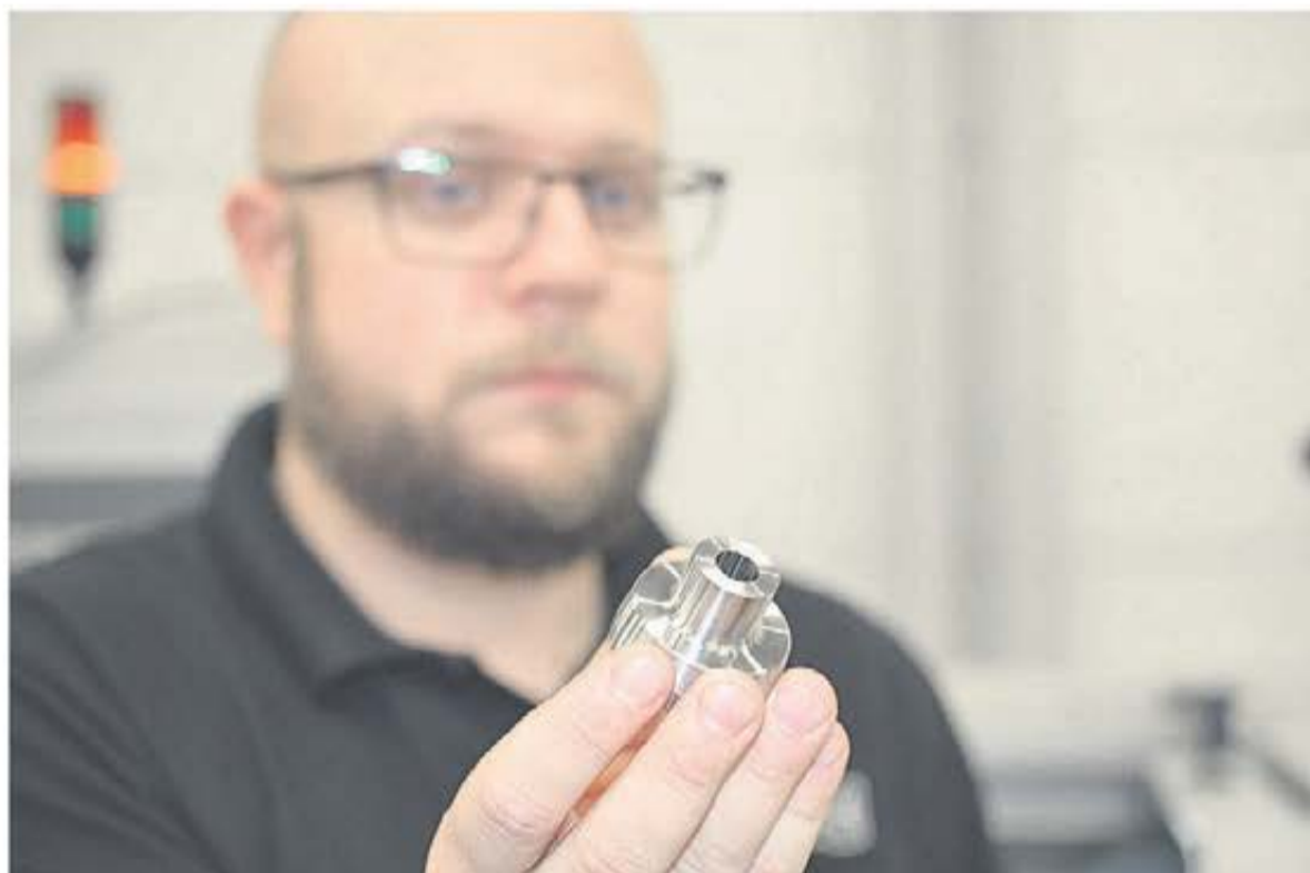
- Högkvalitativa ytor vid hårdsvärning är en av fördelarna med metoden. Att svarva efter hårdning ger en otrolig finish på ytan och ger möjligheter för mycket snäva toleranser, säger operatör Matti Nieminen
