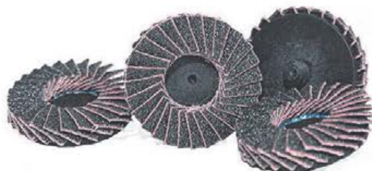
Sortimentet omfattar BDX minilamellrondeller med diameter 50 och 75 mm i kornstorlekarna 40, 60, 80 och 120. Rondellerna används med en speciell hållare med 6 mm spindeldiameter och är försedda med snabbfäste vilket medger snabba och enkla rondellbyten. De är avsedda för användning i elektriska eller pneumatiska raka maskiner.
