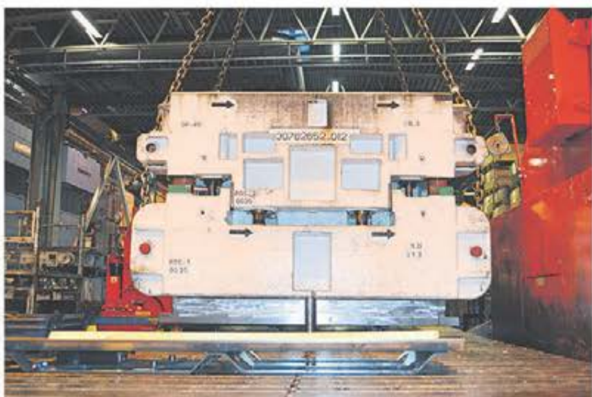
Quick Cassetten, som förutom rännan bara är 78 mm hög, i väntan på att verktyget ska sänkas ner.
