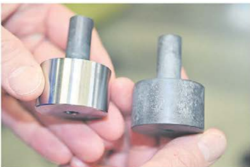
Fördelar med hårdsvavning är att man har full formfrihet. Operatören kan gå in och ändra två hundradelar om det behövs och processen har en mycket god repetemoggrannhet.
