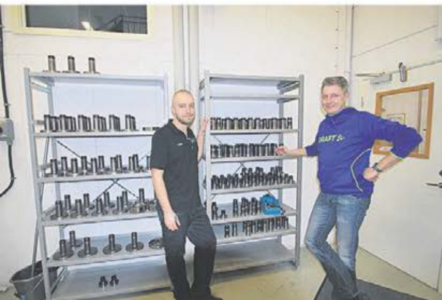
Spännhylsor i olika dimensioner för fastspänning av detaljerna i svarvarna.
