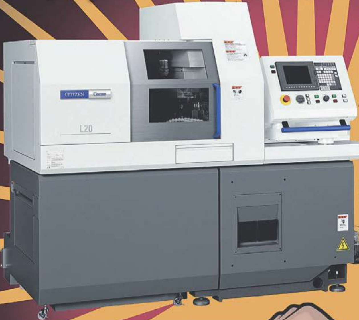
Svarvning med LFW tekniken, perfekt spänkontroll och ytfinhet.
