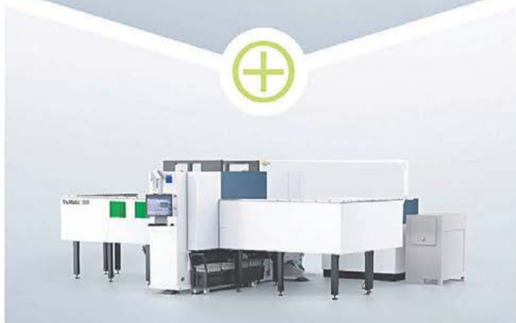
Konvertera TruPunch 1000 sedan till en kombimaskin genom att ansluta en 3 kW TruDisk faskroppsleser. Med bara några ytterligare justeringar, drar du snart nytta av de enorma möjligheter som en kombination av stansning och laserskärning ger.
