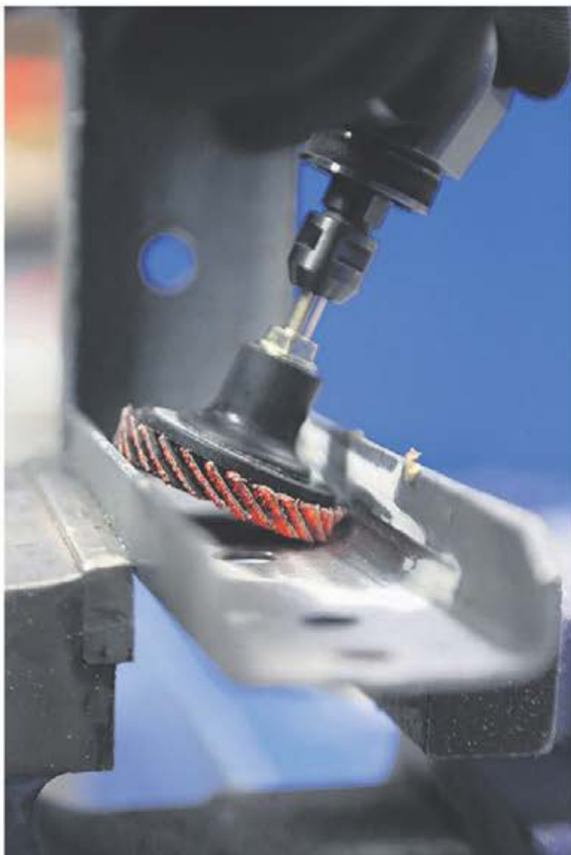
Minilamellrondeller Blaze har den senaste generationen keramiskt slipmedel och är dessutom belagd med ett fyllnadsmedel som reducerar värmeutvecklingen. Det ger en rondell som medger aggressiv och snabb slipning i kombination med lång livslängd. De är kallskärande vilket gör dem idealiska för värmekänsliga material som rostfritt, titan och andra hårda legeringar.
