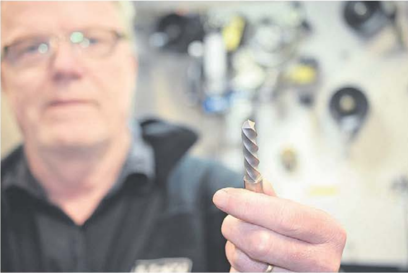
Den nya trådnisten är utrustad med en C- axel vilket innebär att vi kan samtidigt rotera en detalj samtidigt som vi trådnistar den. Här ser vi resultatet som är lite ovanligt.
