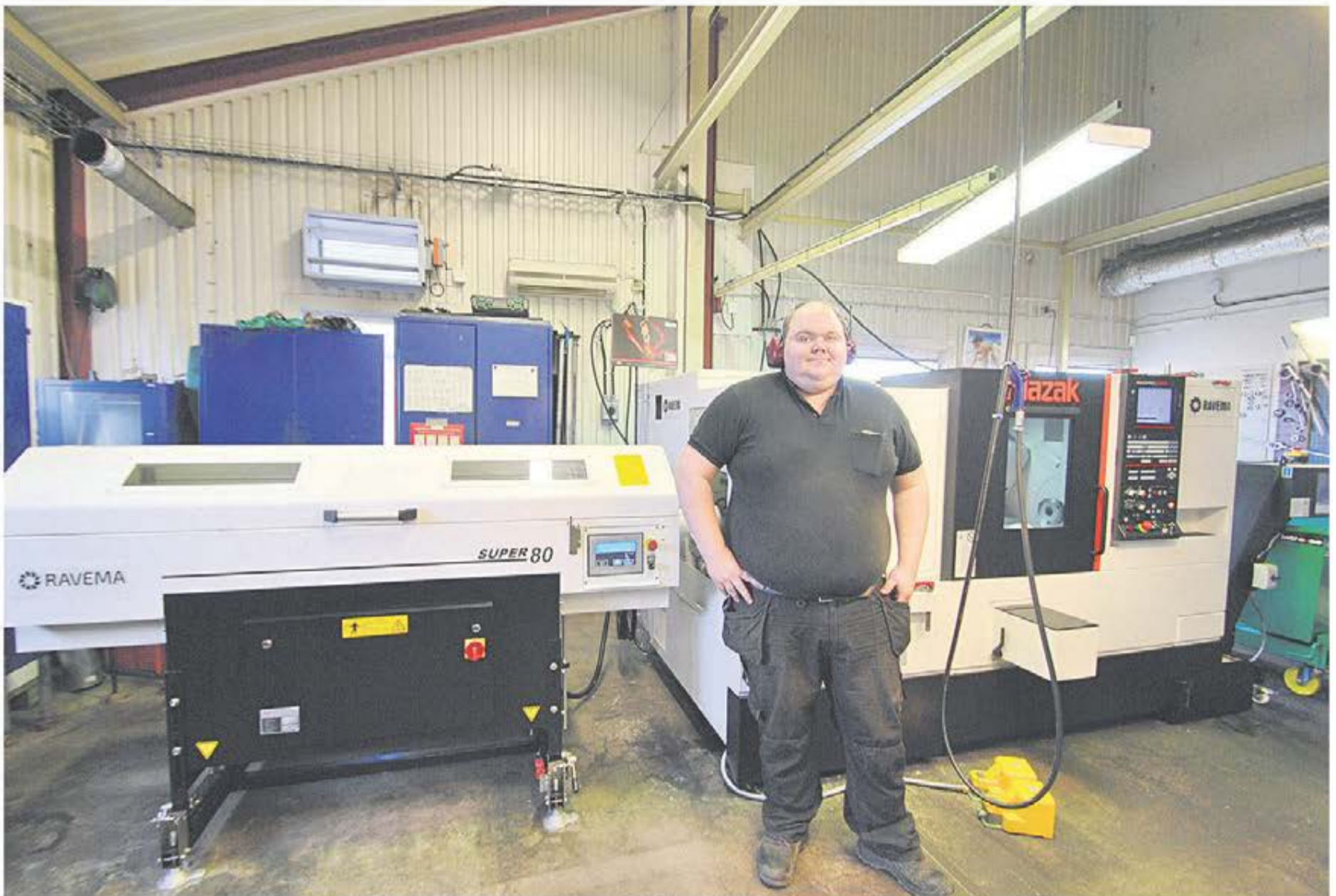
Maskinoperatör Håkan Bengtsson framför verkstadens nya Mazak Mazak Quick Turn Smart 250 ML automatiserad med stångmagasin.
