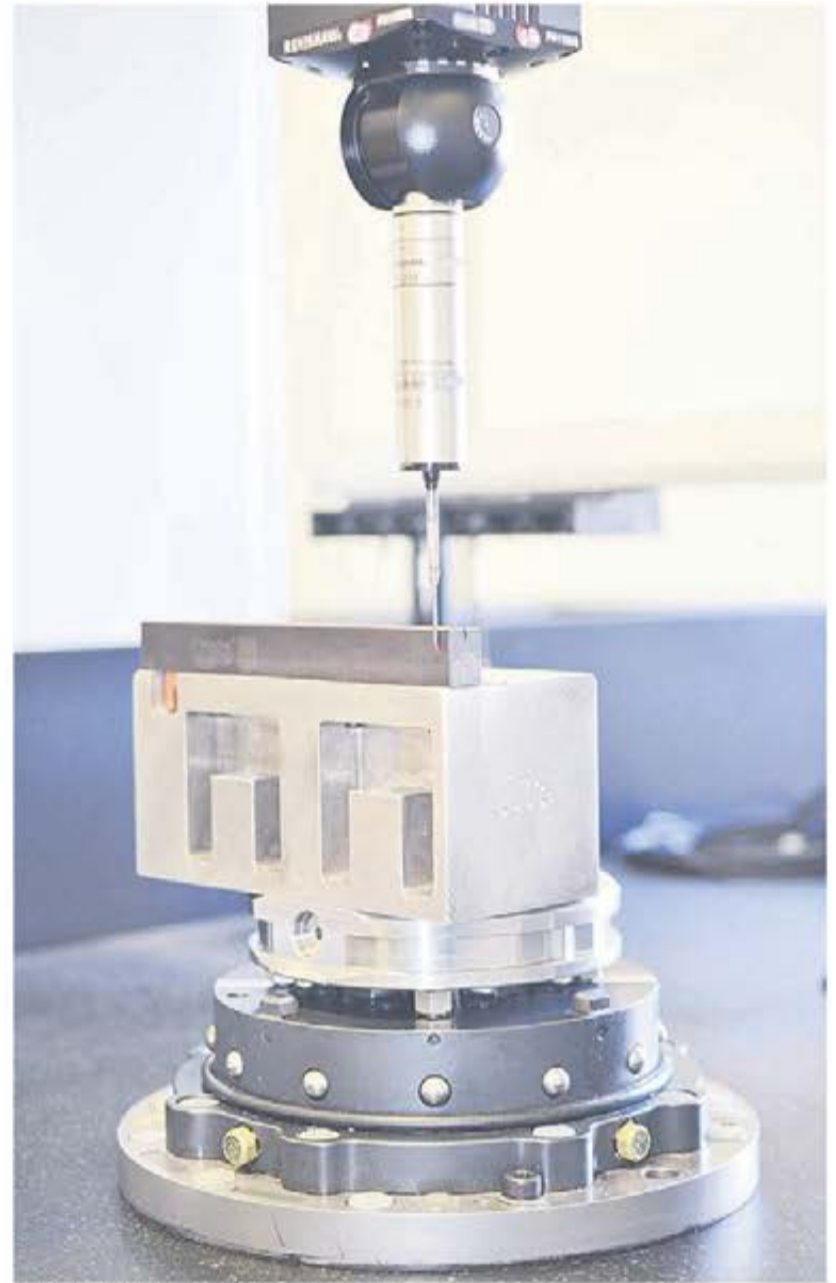
EROWAS referenssystem i mätmaskinen.
