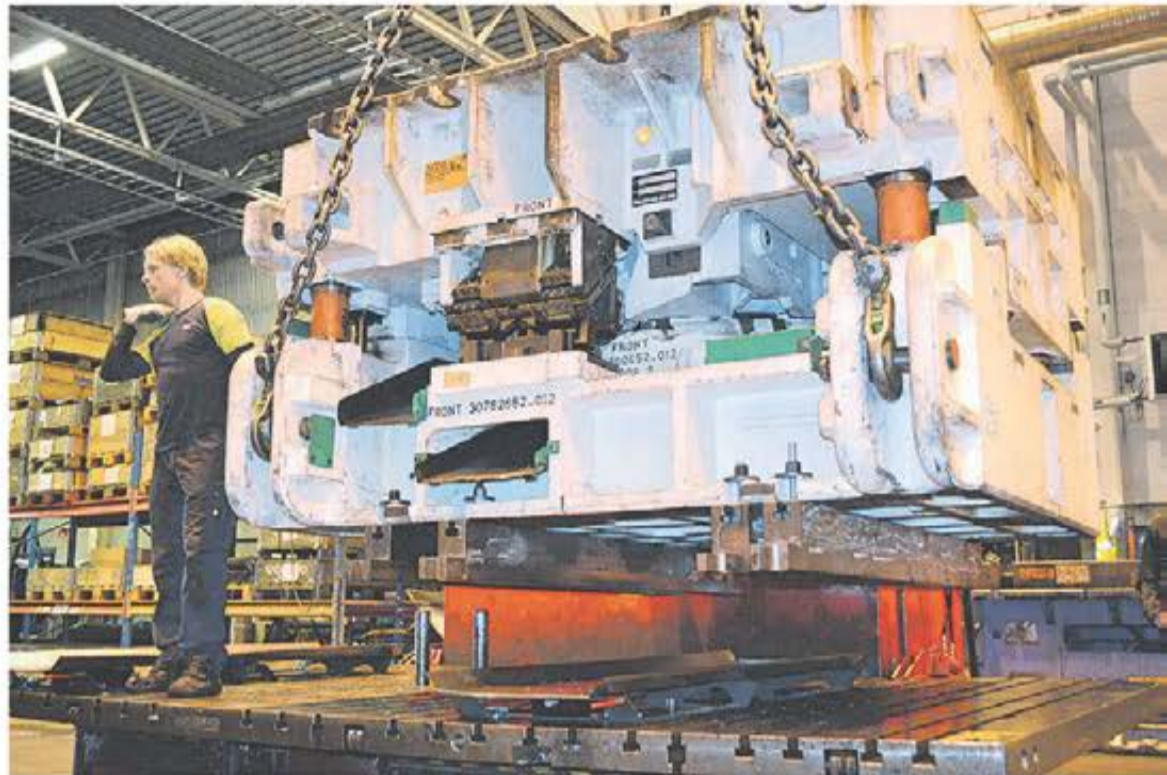
Det stora pressverktyget i EBP:s produktionsanläggning sänks ner över utmatningsenheterna.
