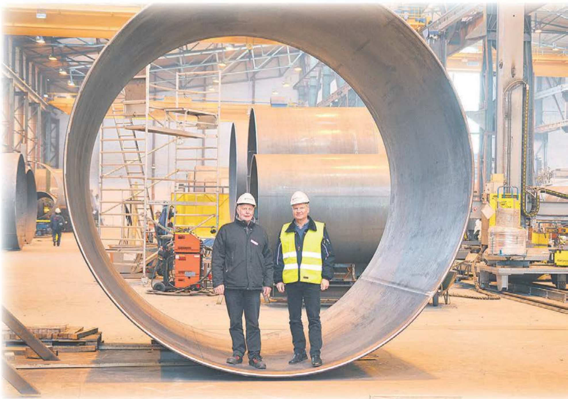
Rundvalsat och svetsat i gigantiska storlekar, vindkraftstorn är byggda av stora stålplåts cylindrar, minst sagt.
