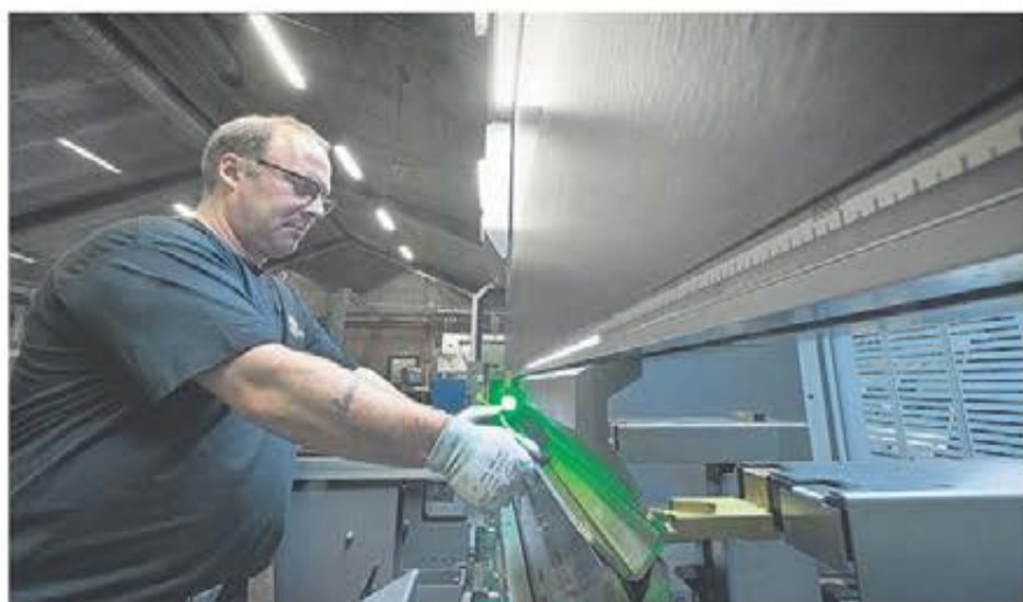
Oleg Langefors var med redan 1991 då den första laserskäraren kom på plats. Idag arbetar han med de senaste i huset, en BySprint Fiberlaser på 6 KW. – En otroligt smidig och snabb laser som är sammankopplad med den nya kantpressen.
