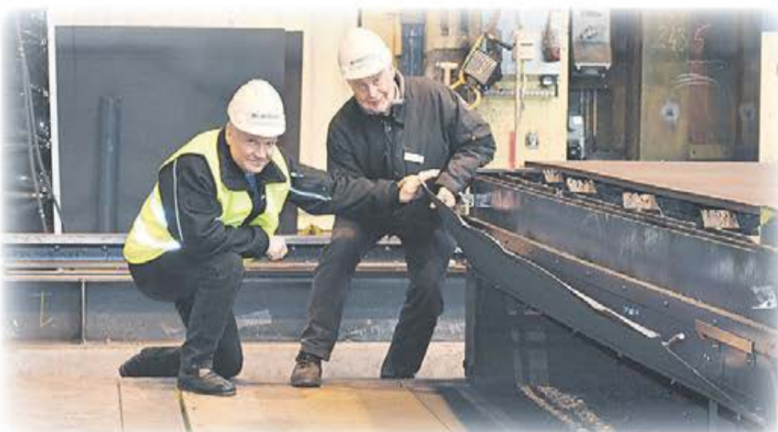
Ulf och Bertil visar en finurlig produkt som kallas Slagger och som har ett plogblad som löper under maskinen där slagg och övriga restprodukter plogas till en container i golvnivå som tar hand om detta.
