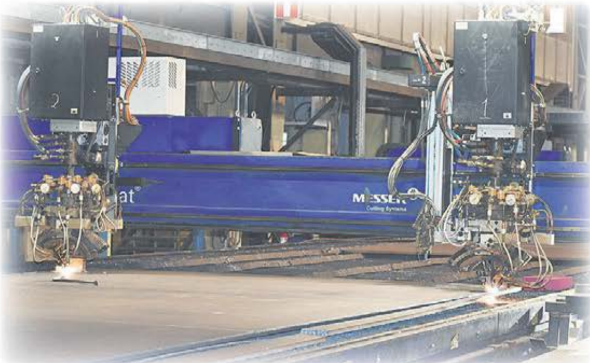
Här skär man i de riktigt grova plåtdimensionerna med precision och imponerande snabbhet. Valet mellan gasskärning och plasmaskärning avgörs av material, kvalitet, tjocklek och erforderliga toleranser.
