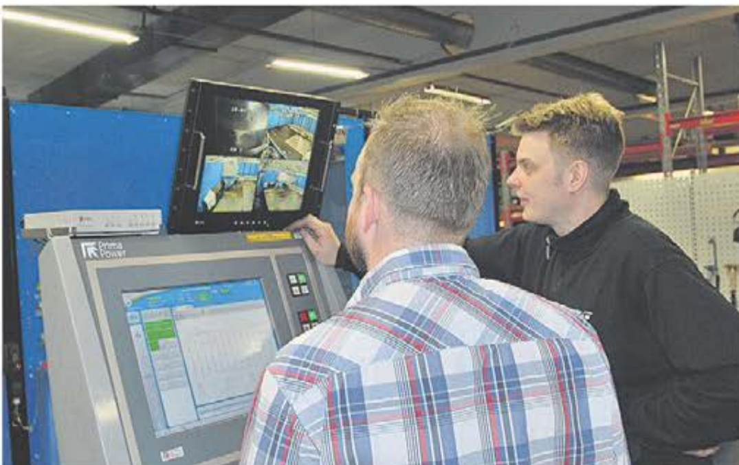
Fyra kameror är standard idag på Prima Powers fiberlasermaskiner. Det handlar om att kunna bevaka processen optimalt och se vad som händer i maskinen
