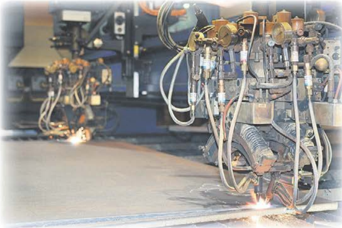
Gasskärning med 3 brännare
