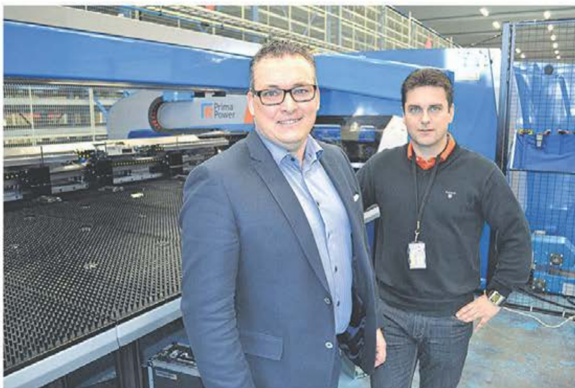
I bakgrunden syns CNC Plåts nya stans-vinkelsaxmaskin SBe8 som har linjärmotorer för extremt höga hastigheter och som hantlar plåtformat 4300x1500.
