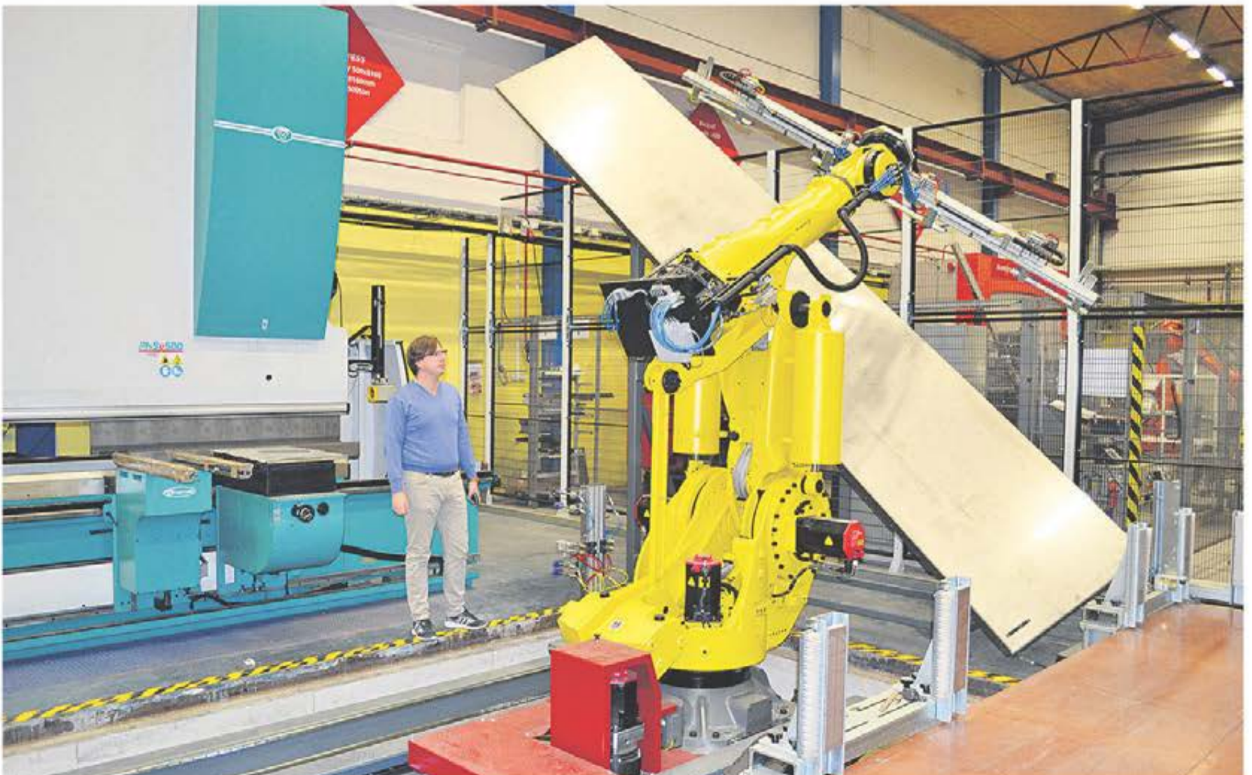
Anställd från CNC Plåt observerar företagets nya stora Sarmatik-robot som hanterar upp till 700 kg. Förutom flera investeringar i maskiner har CNC Plåt bytt ut sitt gamla programmeringsverktyg till Prima Powers system NC Express.
