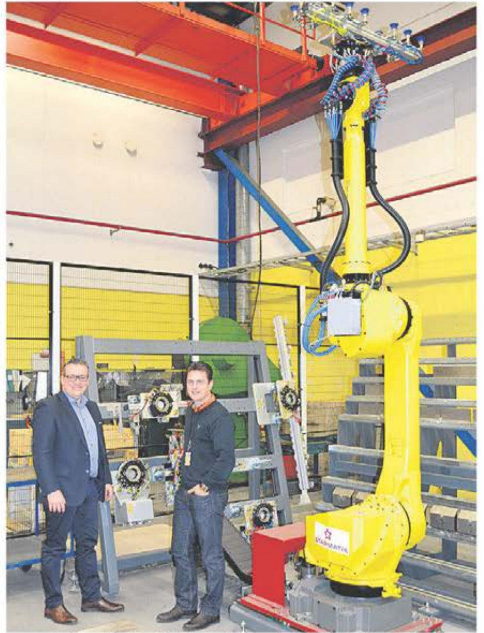
Sarmatik-roboten ingår i en ny kantpressrobotcell. Roboten byter gripdon och verktyg helt automatiskt. Programmering sker off-line.
