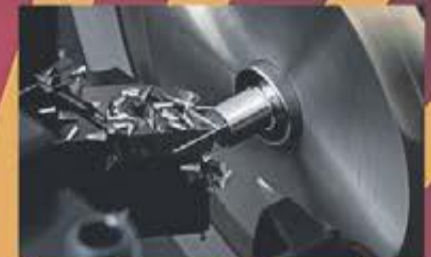
Svarvning med LFV tekniken, perfekt spänkontroll och ytfinhet.
