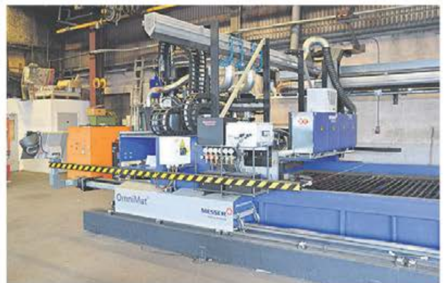
Messer Omnimat med Skew Rotator samt dubbla 400 Amp Hypertherm strömkällor, skärningen utförs i ett vattenskråbord och programmeras av Messer's CAD/CAM program Omniwin
