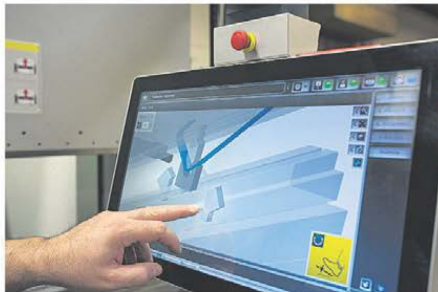
Touchkontroll och en display som visar de olika momenten i bockningen.
