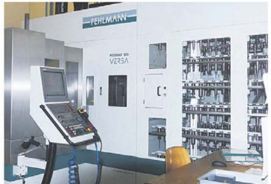
Verktymsmagasinet som rymmer 218 verktyg gör att Nedinsco BV kan ha hela sitt verktygsbehov konstant och inte behöver riskera operatörsmissar vid byte av uppsättning.
