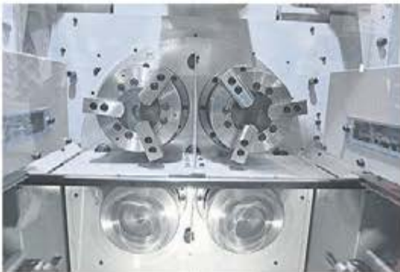
Bearbetningsutrymmet på en Shimada stängsvarv. Maskinerna kan fås med 2, 4, 6, eller 8 spindlar.
