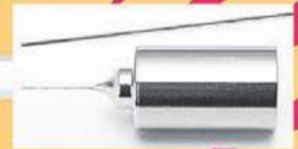
Svarvad med hjälp av LFW teknik. Bilden visar jämförelsen med ett 0,5 mm tjockt blyertsstift.
