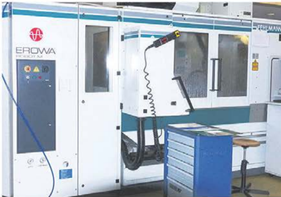
På dessa sina äldre FEHLMANN-maskiner har Nedinsco BV ända sedan år 2000 tillverkat samma typer av detaljer och hela tiden med en tolerans av några få hundradelar.
