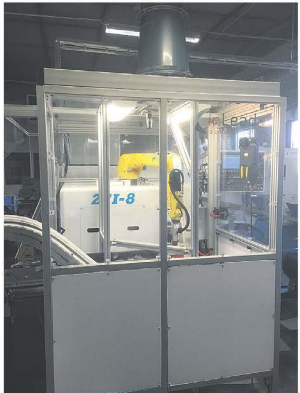
Nominit vidareförädlar kallformade ämnen genom att svarva dem i en obemannad robotcell.
