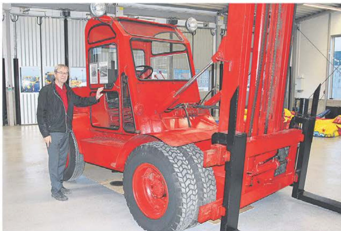
Till en början tillverkades truckarna som bakvända lastbilar inköpta av Vägkassan och först 1964 fick truckarna ett eget chassi.
