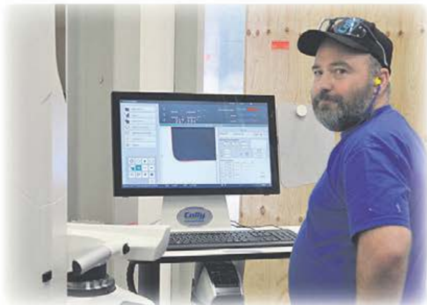
Kunden har även valt att komplettera anläggningen med verktygsförinställare Microset UNO där man mäter alla verktygens mått och data som sparas och sedan kan skickas direkt ut till maskinerna.
