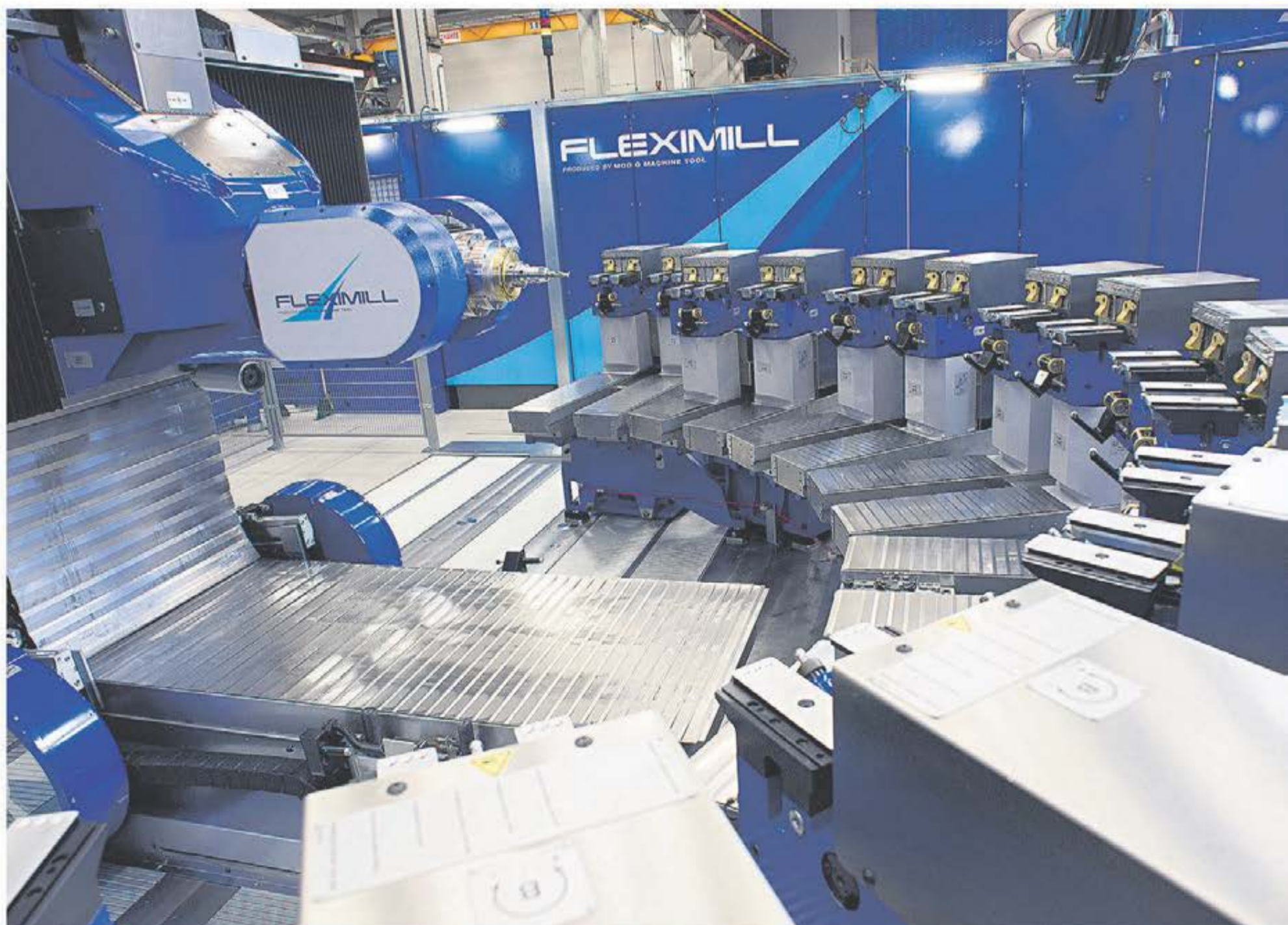
FlexiMill är unik med sina elektroniska styrda fixturer framför maskinen, vilket ger kunder stora möjligheter. Fixturena kan hålla detaljer oavsett form.
