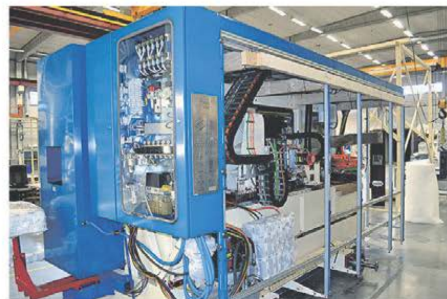
Spirit Aerosystems senaste HHV Extrusion Mill. Maskinen, som tar cirka 2000 timmar att montera, lastas i container utan grundplåtar.
