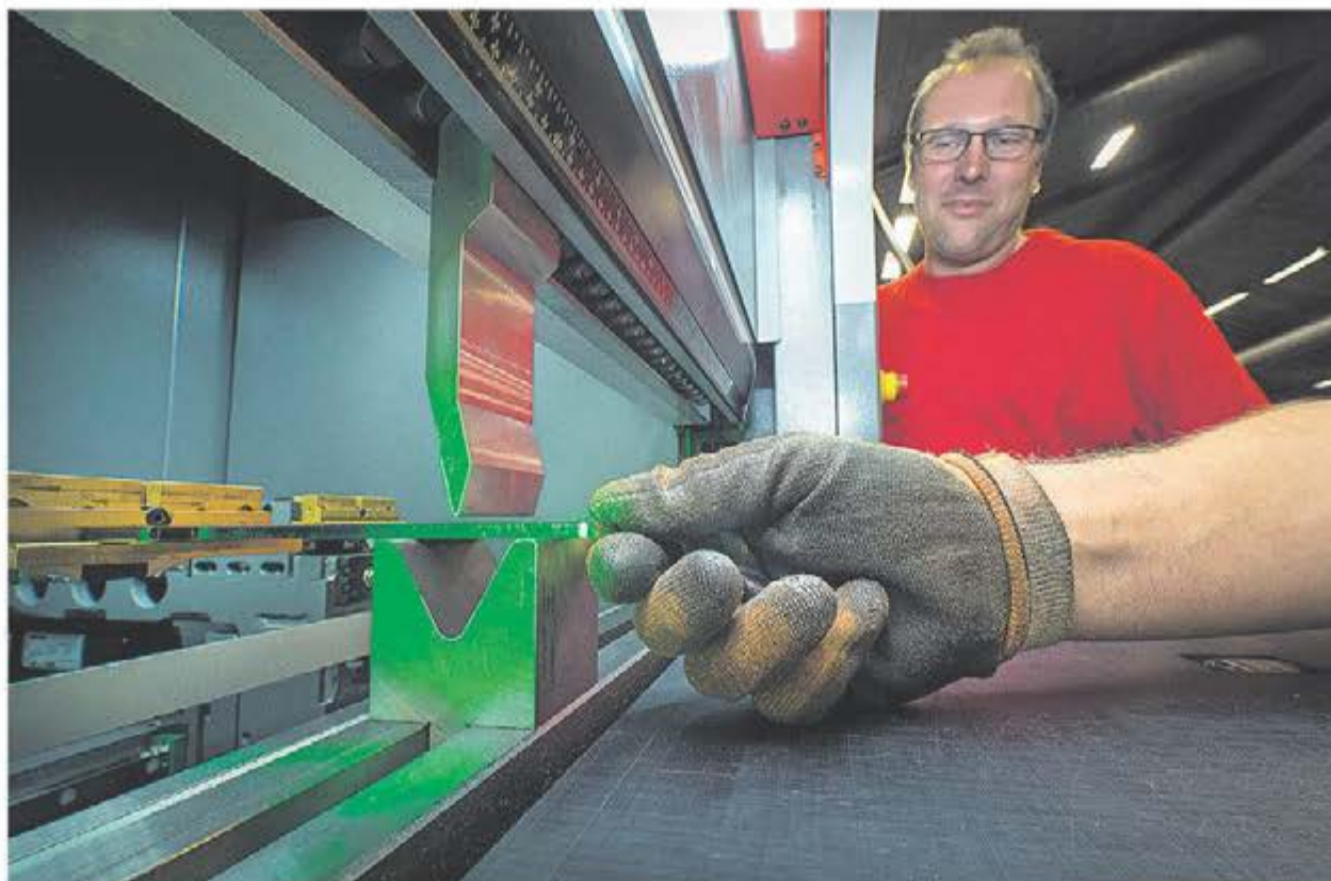
Lars Rydberg konstaterar att utvecklingen av kantpressar under de 19 år han arbetat i branschen verkligen gått framåt. Expert 40 är den senaste och modernaste kantpressen från Bystronic.
