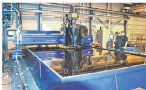
Messer OmniMat L med plasmafasning samt gasskäring på vattenbord
