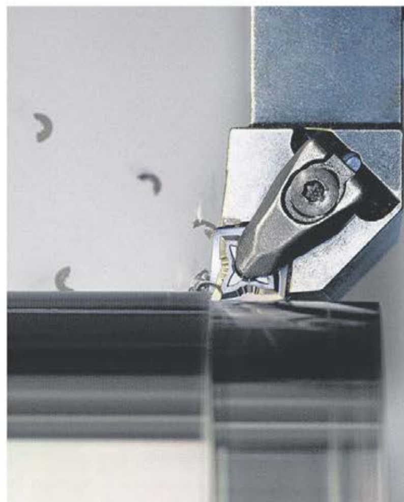
SF och SM geometrierna stödjer svarvning av svårbearbetade material (DTMM).
