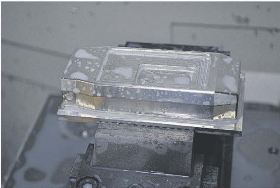
Den färdiga detaljen är en del av laserutrustning som används mycket inom travsport för att lindra muskelverk. Detaljen är i aluminium och tar cirka 12 minuter att framställa.
