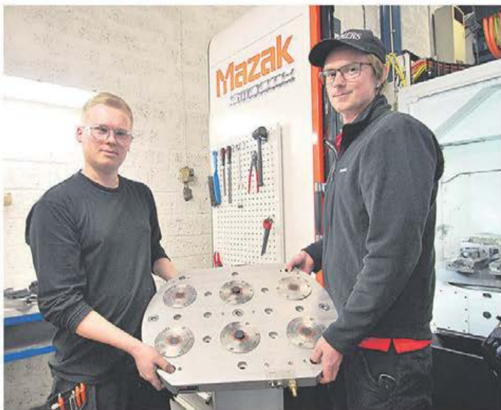
ZeroClamp fastspänningssystem som reducerar ställtiderna och stilleståndstider och därmed generera lägre produktionskostnader och samtidigt ökar processsäkerheten.
