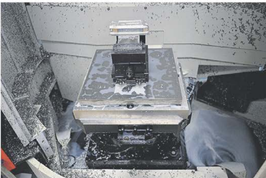
Enligt Sven är den stora fördelen med nya maskiner att de är så kallade multimaskiner som gör allt, vilket ger en säkrare process då operatören inte behöver flytta detaljen och därmed riskera att något fel uppstår.
