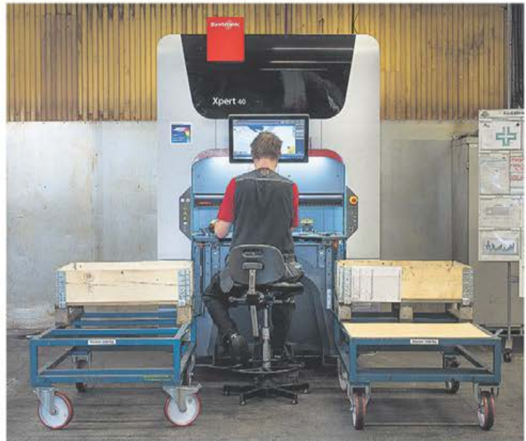
Liten men naggande god! På Stans & Press har man kantpressar med kraft att pressa upp till 400 ton, den lilla 40-tonnaren används till små och krävande detaljerna.
