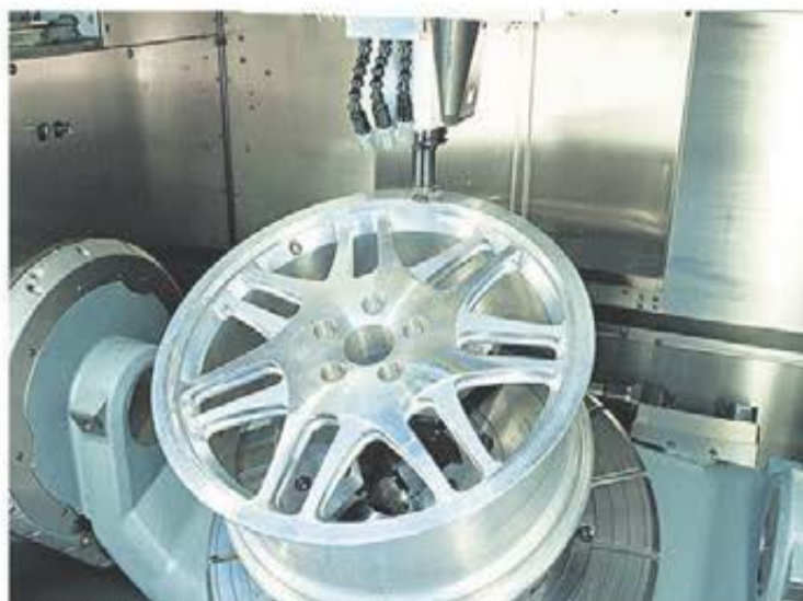
Svarvning och fräsning i en riggning: TNC 640 växlar programstyrt mellan bearbetningarna i valfri ordningsföljd
