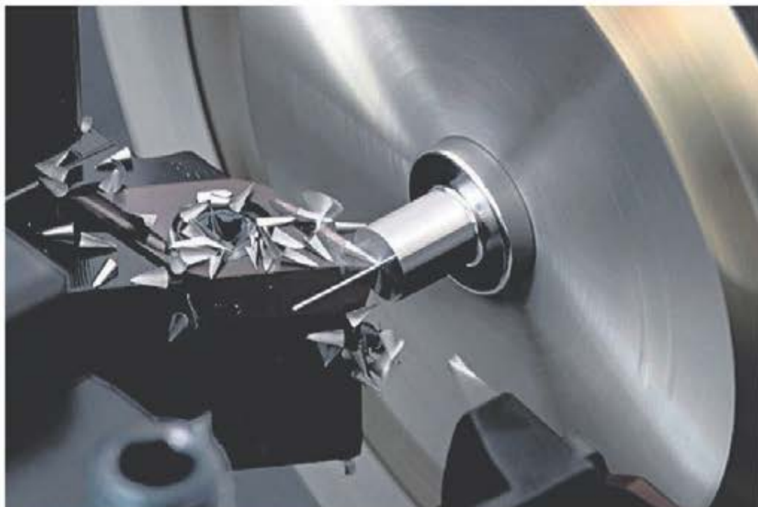
Svarvning med LFV tekniken, perfekt spånkontroll och ytfinhet.
