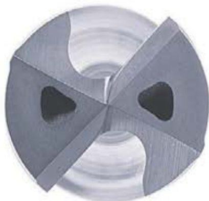
Mitsubishi's kylkanaler Tri-Coolant ger ökat kylvätskeflöde, optimerat flöde till skäreppen och bättre spånevakuering.
