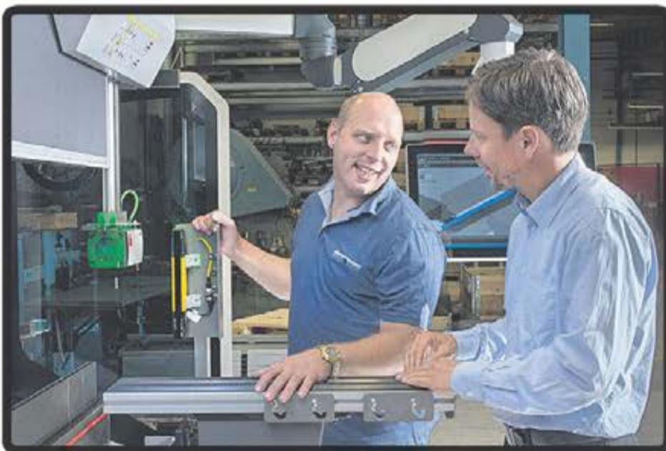
– Den fungerar väldigt bra, ljusidastyrningen som innebär att en- och tvåtaktsskörning är möjlig säger produktionschef Per-Åke Sondell till VD Peter Labecker.
