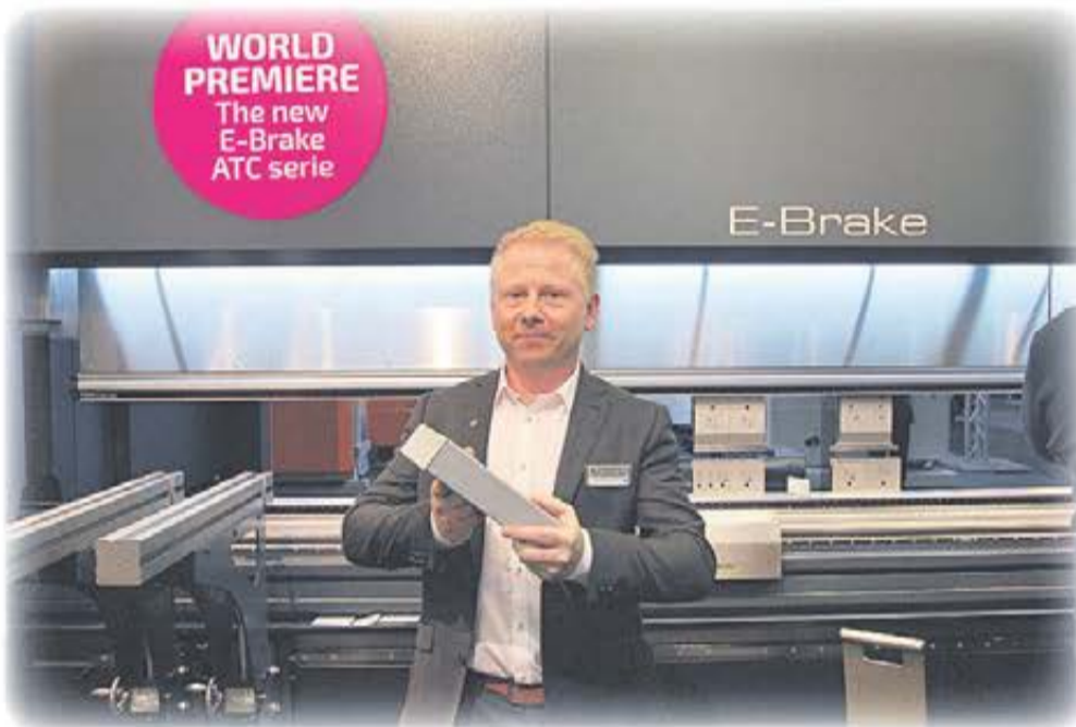
Fredrik Carlsson produktchef Safan på Din Maskin visade upp världspremiären av kantpressen E-Brake 200-4100 med automatiskt verktygsbyte där en robot växlar verktyg efter behov.
