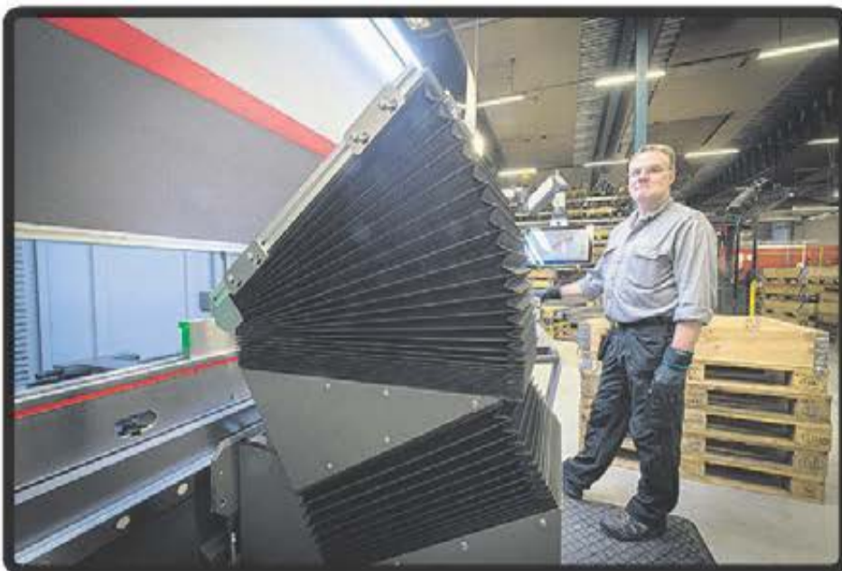
Bystronic's nya automatiska dragspel Byharmonica? Nåe, kantpressoperatören Peter Rustad demonstrerar hur bockhjälpen ser ut i uppfällt läge.
