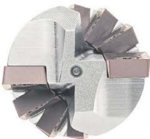
Mitsubishis DCCC vändskärfräs har variabel spiralvinkel för att eliminera vibrationer.
