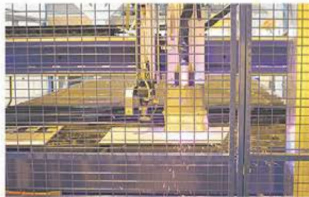
Stort intresse för OSTP nya automatiska skärninje med en Messer laser 6kW och en ny Messer plasmaskärningsmaskin för tjockare material.
