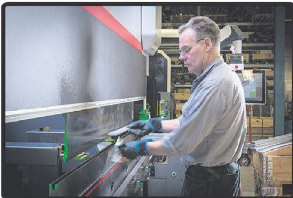
Här ser man hur snabbt det går för Peter Rustad att skifta mellan ett färdigbockat ämne och ett nytt som skall in. Ljusridan styr det man annars behöver foten för att göra, och processen när verktygen skall ner (och upp) går väldigt snabbt och smidigt.
