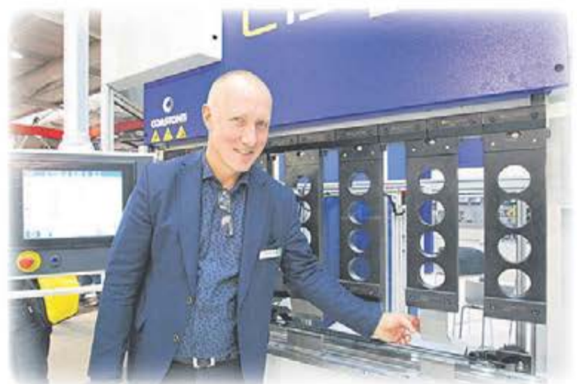
– Lars Carlsson på Maskinab Teknik AB visade bl.a en ny kantpress från CoastOnes på mässan. Denna maskinmodell passar utmärkt att bocka höga produkter som t.ex. lådor m.m. Cones kantpressar, såväl singelmaskiner som robotiserade, har nu funnits på den svenska marknaden ett antal år.
