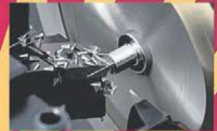
Svarvning med LFW tekniken, perfekt spänkontroll och ytfinitet.
