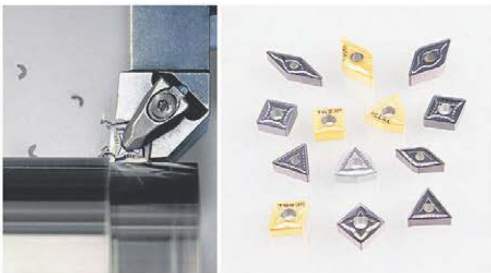
SF och SM geometrierna stödjer svarvning av svärbearbetade material (DTMM).
