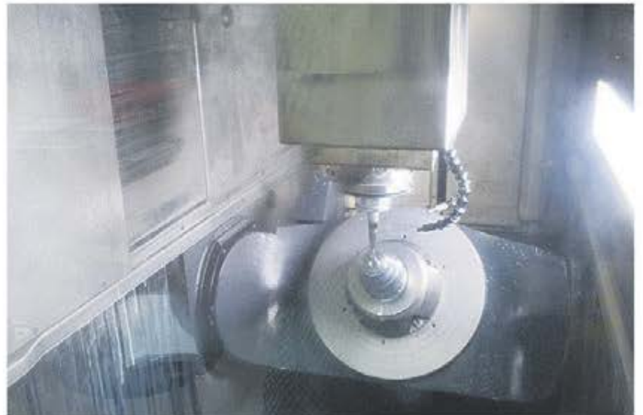
Bearbetning av fräskropp på produktionsfixtur PM85 Monoblock. Höghastighetsbearbetning av plattläge i fräskropp
