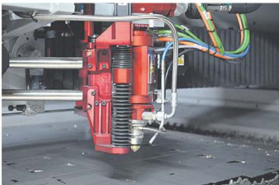
Det nya patenterade skärhuvudet från den italienska maskintillverkaren Salvagnini.
