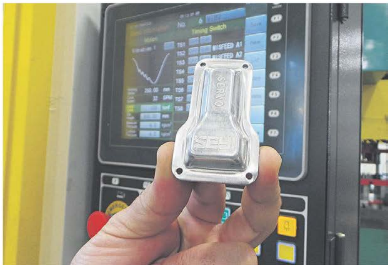
Exempel på en detalj tillverkad i en servo press. Kaliffyttformning av aluminium.
