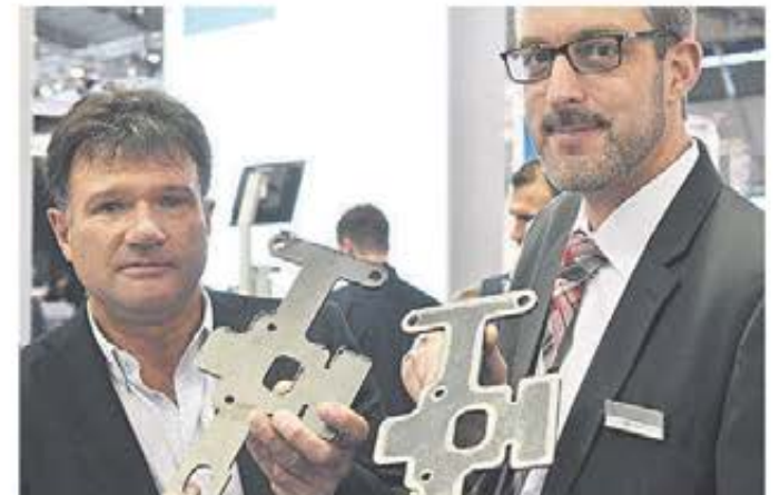
Laserskuret material före och efter gradning och slipning med den tyska maskintillverkaren Loewer teknik.
