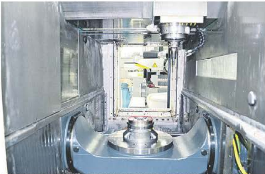
Roboten förser maskinen med paletter från baksidan för optimal access för operatören. Bearbetningsutrymme i DMG-maskin med Erowa-robot i bakgrunden
