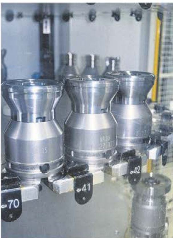
Produktionsfixturer PM85 Monoblock i ett av magasinerna. Fräsmånen i väntan på 5-axlig bearbetning monterade på Erowafixturer med eskortminnen
