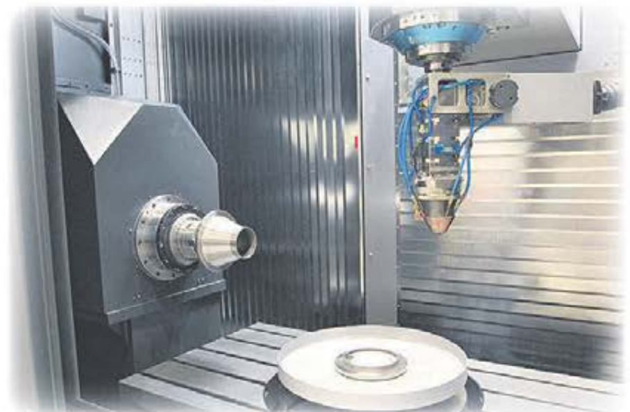
På mässan ställde den spanska maskintillverkaren Ibarmia ut med att visa en ny 5-axlig vertikal fleroptionsmaskin Z VH 45. Det handlar om pendelmaskin med rundbord/multifunktion, inbyggd svarvfunktion och en applikation med ny teknik "add on material + process" vilket betyder att man nu har ett koncept för additiv tillverkning där man kan dels bygga upp materialet med en laserkälla och i kombination med detta i nästa steg utföra en skärande bearbetning i process.
