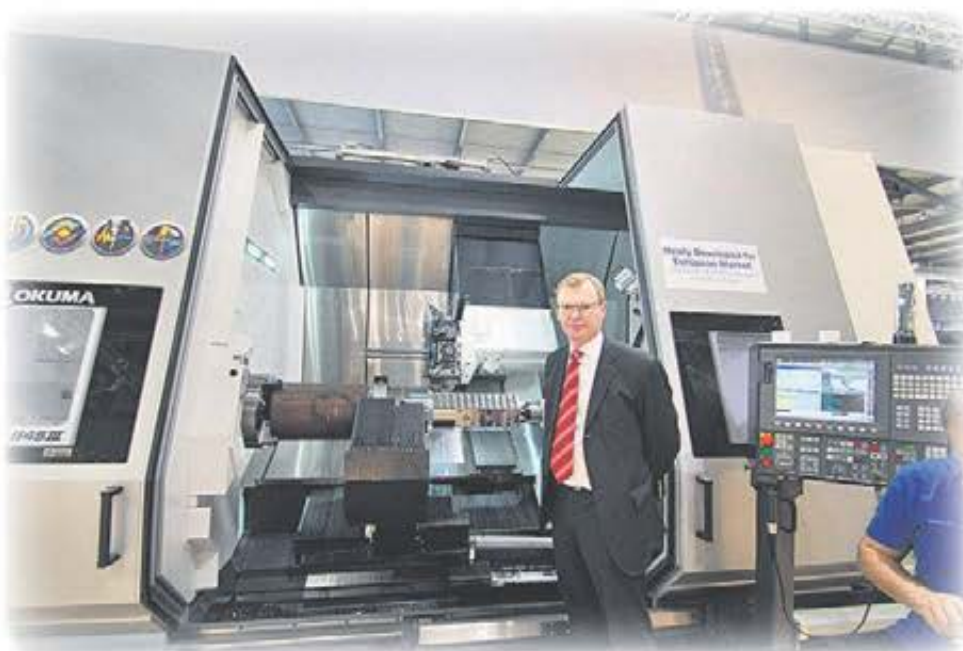
Jimmy Jensen framför LB 45, en verktygsmaskin med drivna verktyg på 15 kW och 119 Nm. Passar för att tillverka stora och tunga detaljer.
