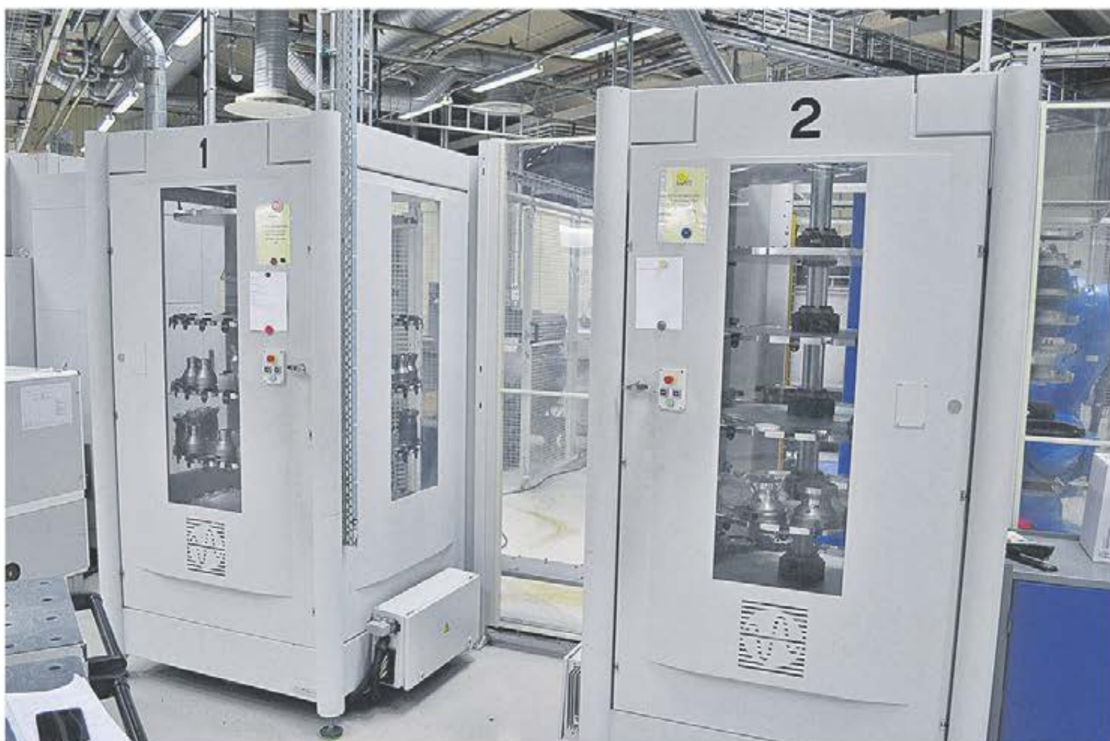
Robotcellerna har två magasin. Fixturerna i magasinerna är uppdelade efter palettstorlek.
