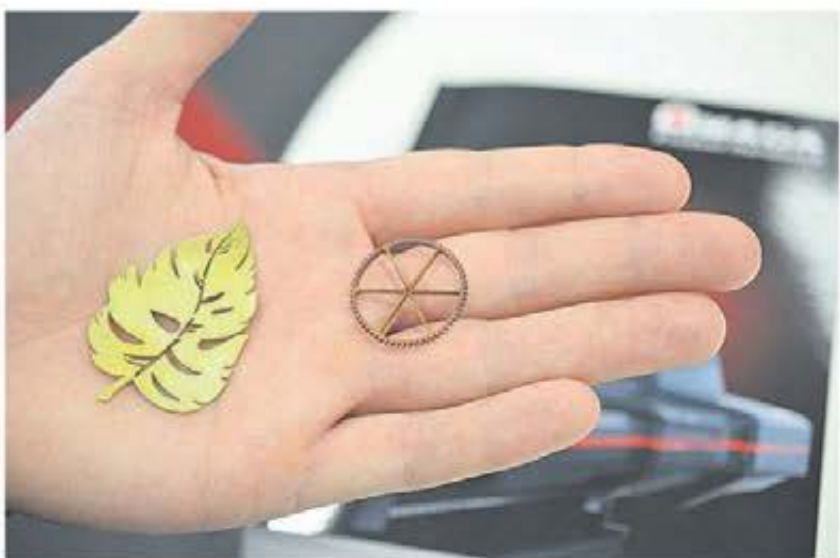
Laserskuret material, koppar 2 mm och mässing 1 mm.
