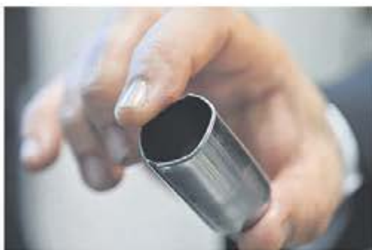
Dragningen görs rent tekniskt i ett steg istället för att dra den i flera steg vilket ger knappt någon temperaturökning i materialet. Toleransen hålls och här erhålls en tolerans ner mot 5 tusendelar på diametern, det är riktigt bra när det gäller djupdragning.
