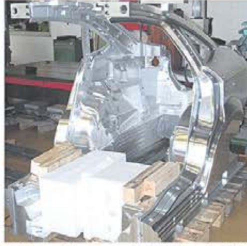
Typiska komponenter hos M.Reuss: Skumningsverktyg i aluminium för bilsäten, kubmodell för sidopaneler och kontrollfixtur för fönsterkarm, tillverkade för underleverantörer inom fordonsindustrin.
