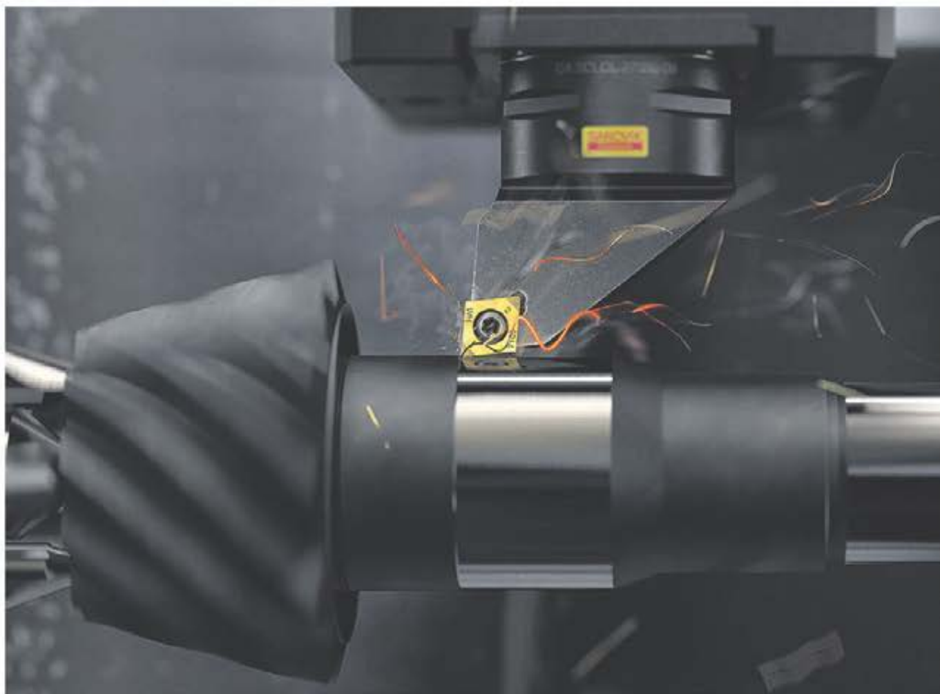
Hårdsvarvning med optimerade skärsorter kan reducera bearbetningstiden och kostnaderna med 70 % eller ännu mer, jämfört med konventionella slipningstekniker.
