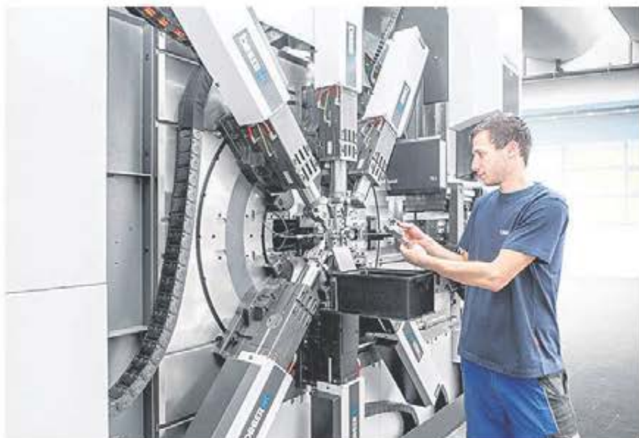
Den servo-styrda bock och stansmaskinen RM-NC med integrerat LEANTOOL
