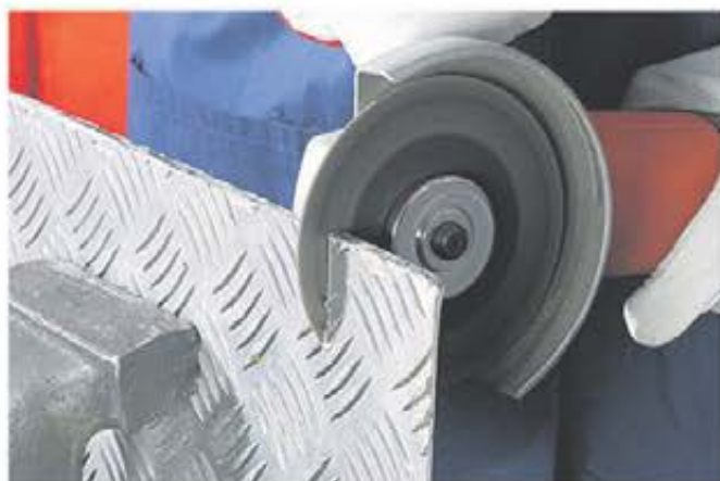
Flexovits nya kapskivor Mega-Line med 1,6 mm tjocklek används i vinkelslip för kapning av stål, rostfritt och hårda legeringar. De är speciellt lämpade för kapning av tunnväggiga detaljer som t.ex. rostfria rör.
