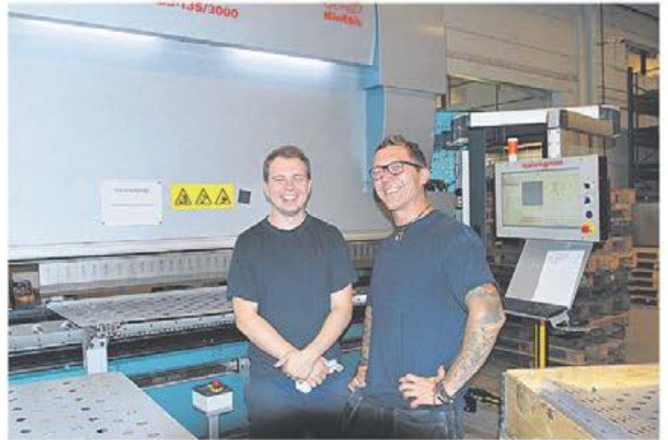
Operatör Dimitrij Kutichshev och teamledare Mikael Fröjdendahl vid den nya kantpressen, Salvagnini B3.ATA som är den italienska maskintillverkarens senaste modell med hybridbockningsteknik samt automatisk verktygställning som hämtat inspiration från panelbockningsmaskinerna. Ett ställ som görs automatiskt tar ca 10 sekunder. Dynan (MVM) som är elektriskt ställbar arbetar med steglös inställning av dynöppningen mellan 6-51 mm spår. Dynan kan även användas som dynhållare och då klarar den en presskraft på 100 t/m. Maskinen kan programmeras direkt på maskinen eller via 3D off-line programmering.
