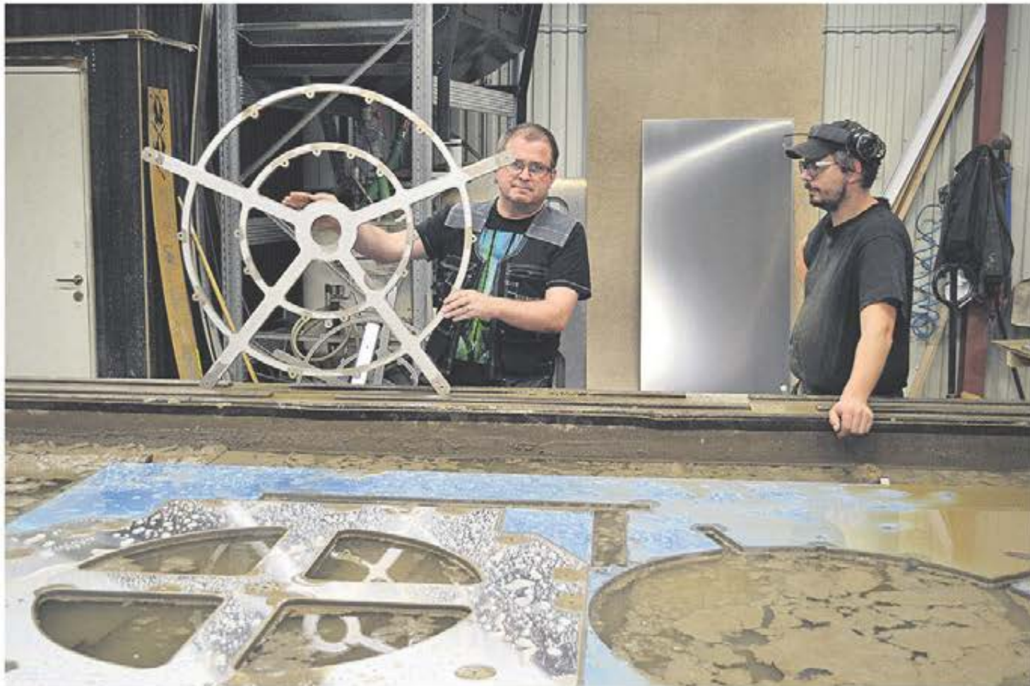
Företaget Lintos ägare Niklas Lindberg har satsat på precisionsvattenskäring. Här visar han upp en precisionsskuren detalj till ett automationsprojekt.
