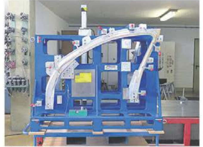
Typiska komponenter hos M.Reuss: Skumningsverktyg i aluminium för bilsäten, kubmodell för sidopaneler och kontrollfixtur för fönsterkarm, tillverkade för underleverantörer inom fordonsindustrin.
