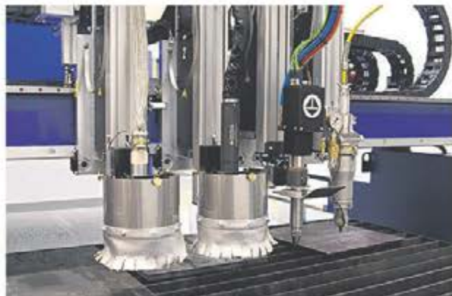
Plasma, gasbrännare och Fiberlasar på MultiTherm ® kombimaskin
