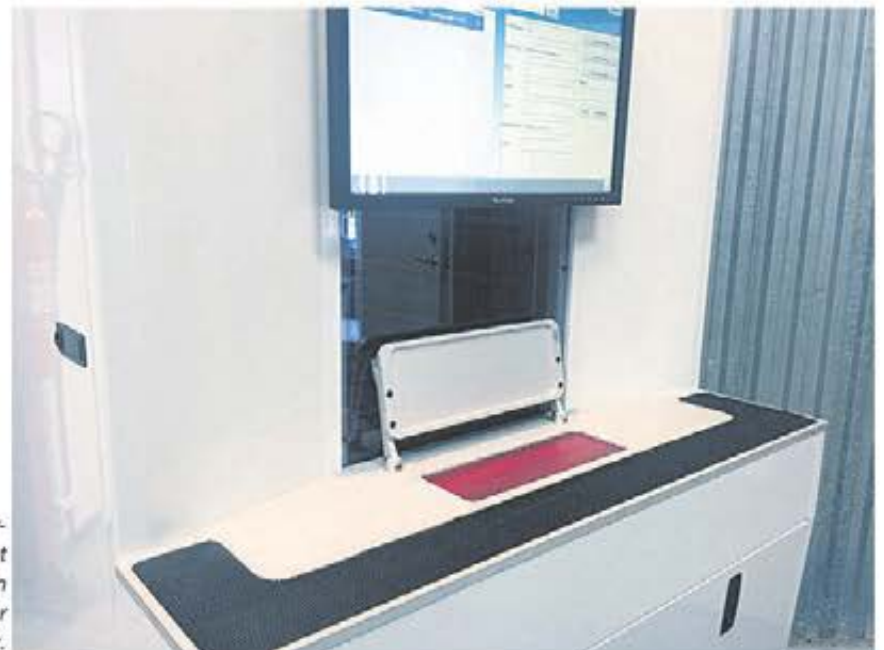
Som tillval finns även servostyrd lucköppning, vilket förhindrar användaren från att av misstag hämta eller lämna detalj i fel fack.
