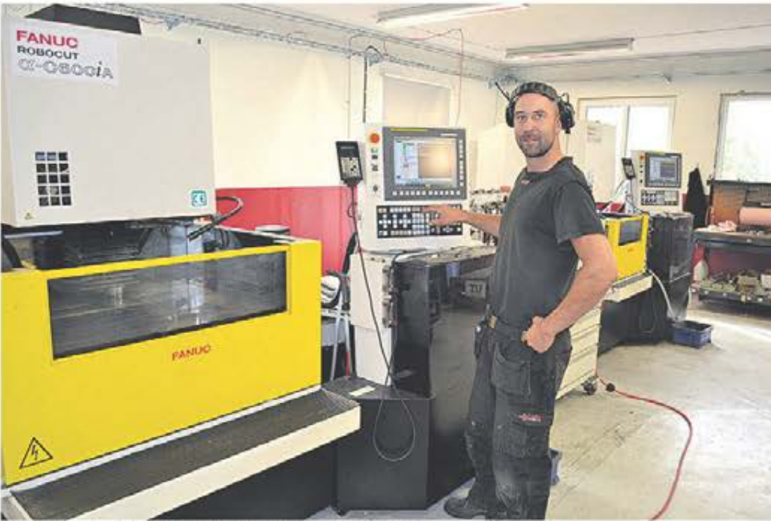
Företaget har nyligen investerat i tre nya FANUC trådnistmaskiner som operatören Gustav Blommesköld ansvarar för.
