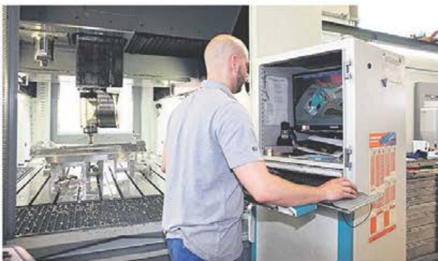
Verkstadsnära programmering med Tebis är vanligt hos M.Reuss. VD'n Markus Reuss ser fördelar i utförandet av krävande jobb direkt vid CNC-maskinen samtidigt som det blir en mer intressant och varierande arbetsplats för personalen. Maskinoperatörerna kan också utnyttja sina kunskaper och erfarenheter bättre då de får omedelbar feedback från programmeringen.
