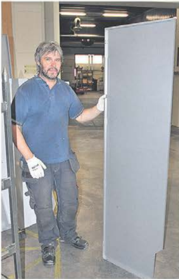
Magnus Kylén visar upp en stansad och bockad plåtpanel till ett torkskåp, klar för ytbehandling och montering.
