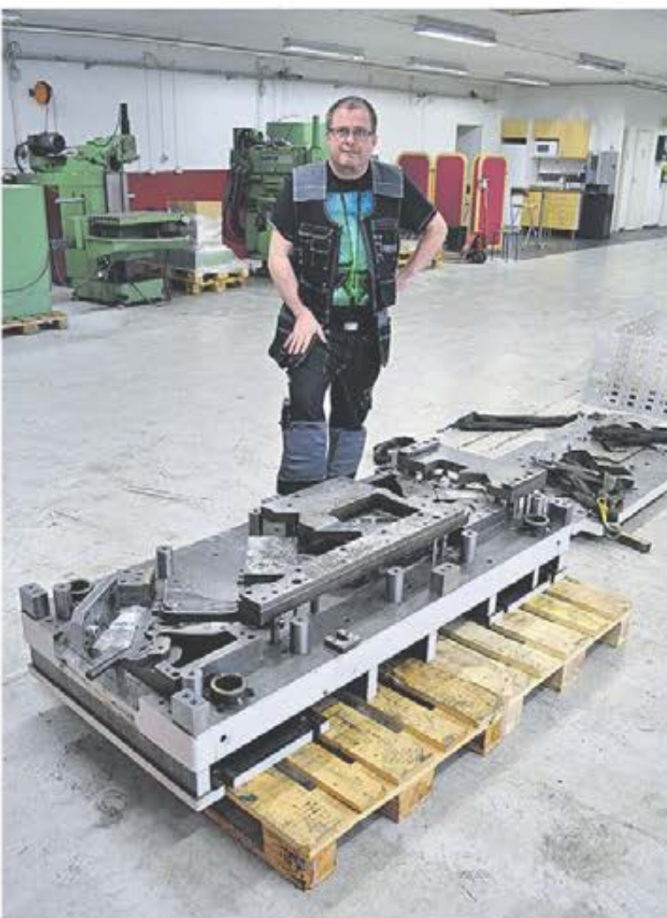
Niklas visar upp ett större följverktyg till en Scania-komponent.
