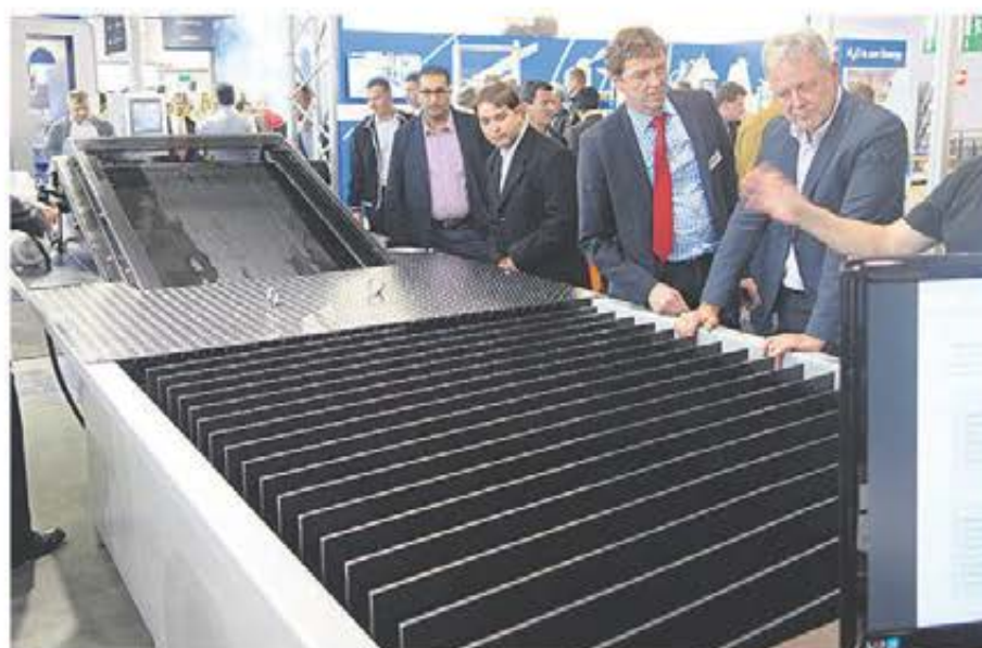
Skärbord med transportband i vatten samt utsug
