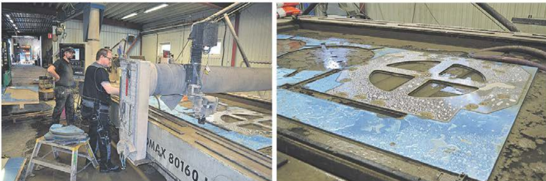
Precisionsvattenskärmning ger bästa möjliga precision. Maskinerna eliminerar eller minskar efterföljande bearbetningsprocesser, vilket gör att Linto kan konkurrera med utländska företag.
