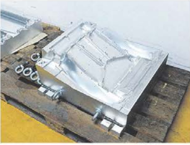
Typiska komponenter hos M.Reuss: Skumningsverktyg i aluminium för bilsäten, kubmodell för sidopaneler och kontrollfixtur för fönsterkarm, tillverkade för underleverantörer inom fordonsindustrin.
