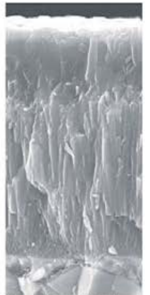
Den släta beläggningen motverkar effektivt löseggsbildning. Det tjockare TiCN-skiktet ger dessutom överlägsen slitstyrka för bästa processsäkerhet.
