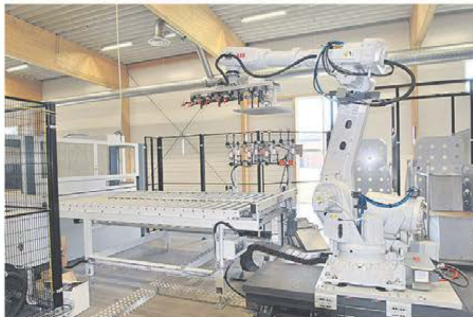
Med robotlösning för plockning och sortering av detaljer plus förarlös truck som hanterar färdiga plåtdetaljer, så har Nimo-Verken i Hova kommit långt i sin fabriksautomation.
