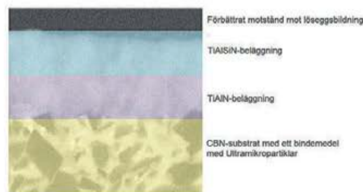
Mitsubishi's nyutvecklade keramiska beläggning.
