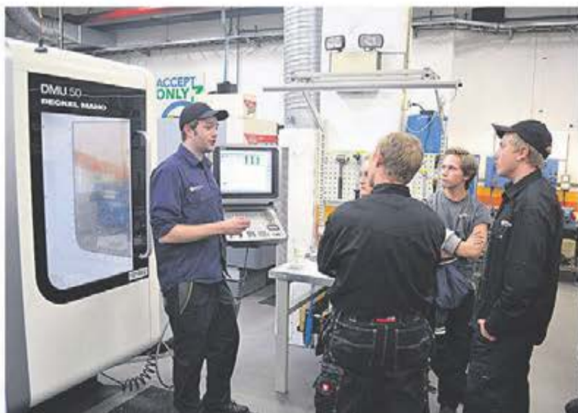
Komvux-studerande Christian Midlöv visar upp dynamisk fräsning i femaxliga maskinen DMU 50 för årskurs ett vid Industritekniska programmet i Emmaboda.
