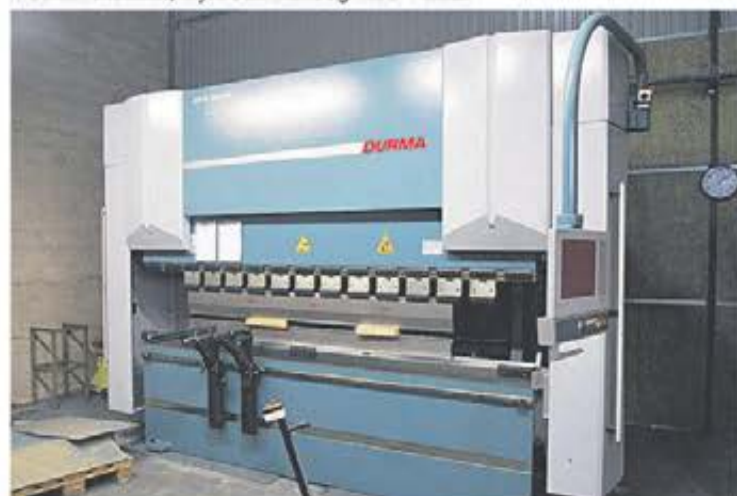
Kantpress Durma modell AD-S 30175, längd 3 meter, presskraft 175 ton. Cybelec ModEva 15T styrsystem med touchskärm, styrt bakre anslag med 4 axlar.
