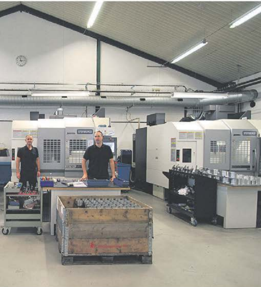
Maskinparken är anpassad efter såväl prototyp tillverkning som serieproduktion. Här är kapacitet inom svarvningen för att hantera arbetsstycken på upp till \varnothing 600 \times 3000 mm och man kan även fräsa med fyra axlar samtidigt.
