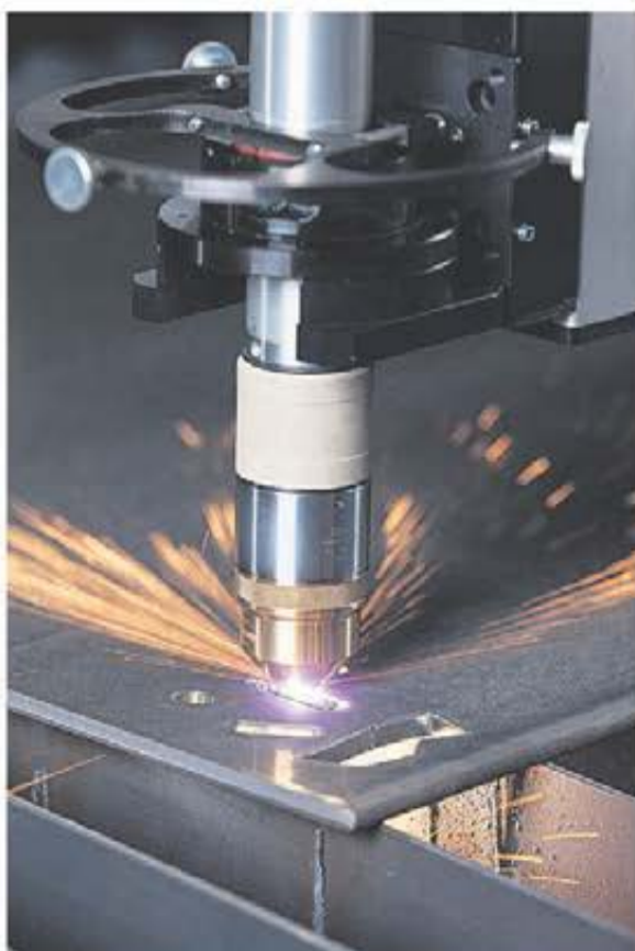
Plasmabrännaren i full action, snabb och exakt, såväl kolstål som rostfritt kan bearbetas i upp till 50 mm.
