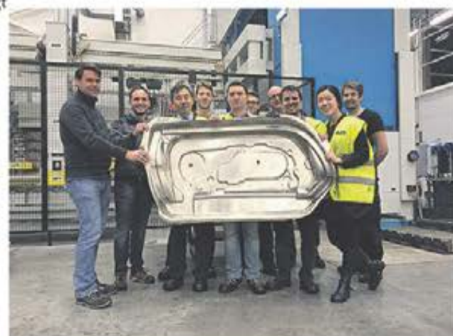
Världens första bildörr med innerdel av varmformad, härdad, höghållfast aluminium. Prototypen är tillverkad hos AP&T för Lotus.
