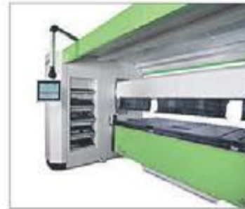
Böjbalk i nedre läget innan bockning
