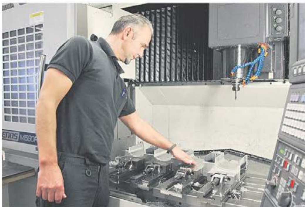
Effektivisera och automatisera, här handlar det om att placera både fler skruvstycken och som på bilden även en manuell tre-backs chuck för att kunna köra fler och olika detaljer i en uppspanning.
