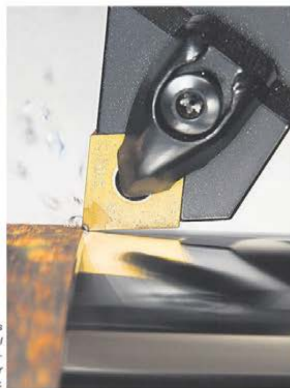
Sandvik Coromants CB7015 är förstaval vid svarvning av säthårdade komponenter för transmissioner.
