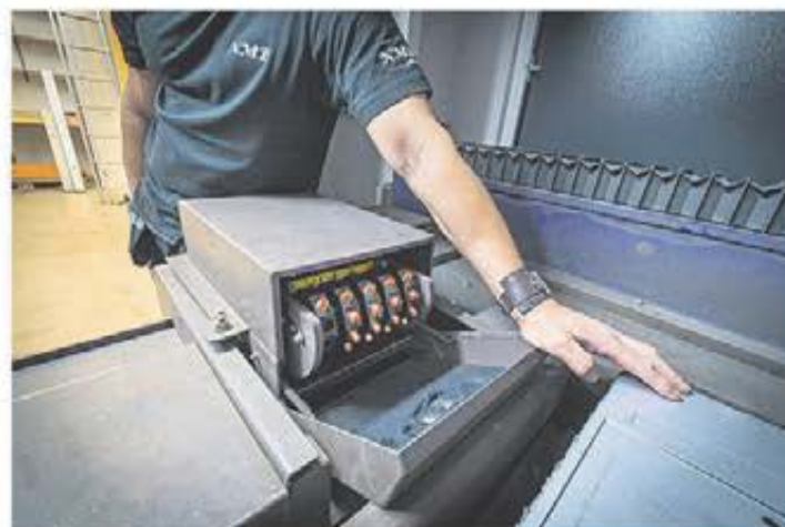
En automatkassett med nozzlar i olika dimensioner där laserskäraren själv hämtar och byter när det behövs.
