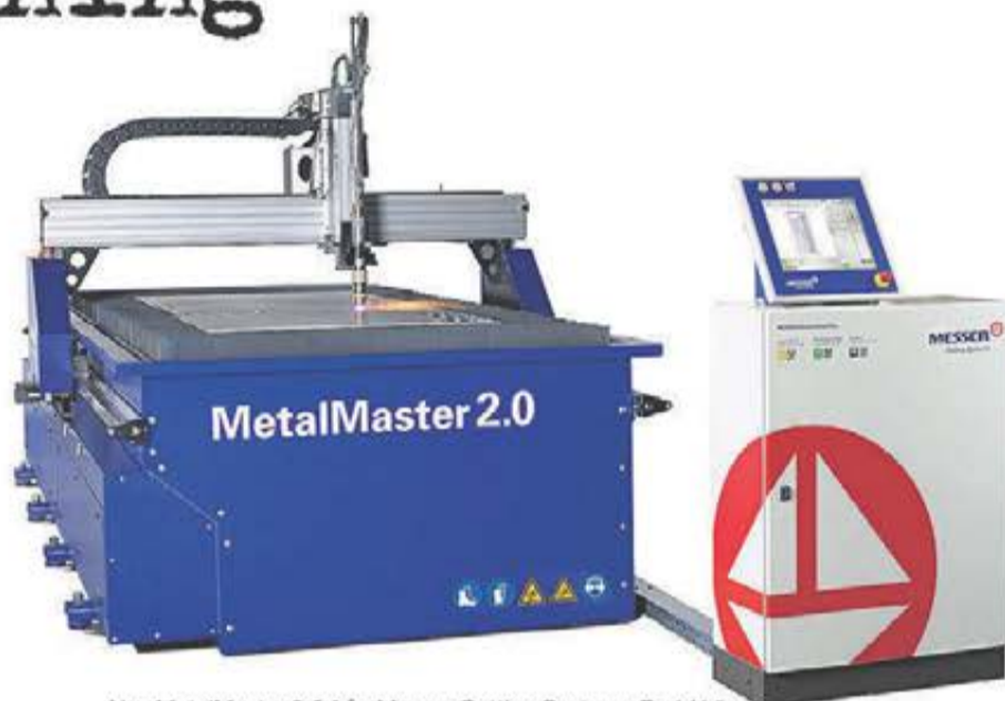
Nya MetalMaster 2.0 från Messer Cutting Systems GmbH är en prisvärd "Entry-Level" skärmaskin med gas- och plasma.
