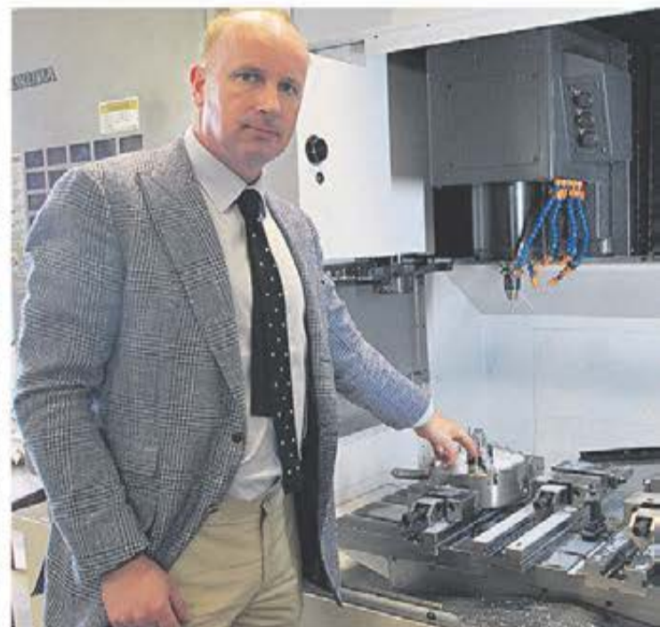
Effektivisera och automatisera, här handlar det om att placera både fler skruvstycken och som på bilden även en manuell tre-backs chuck för att kunna köra fler och olika detaljer i en uppspanning.
