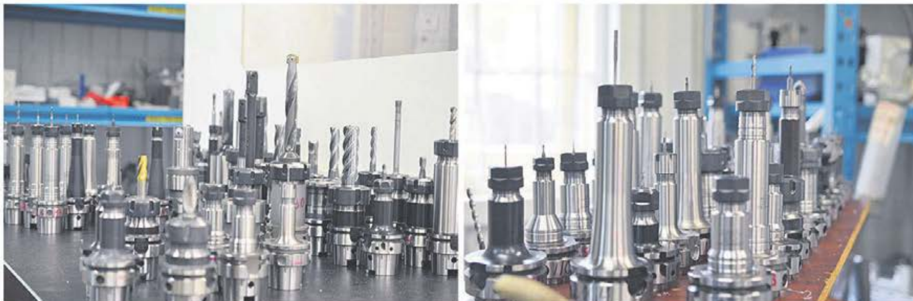
Verktyg, den nya 5-axliga Yasda maskinen har 240 verktygsplatser och det behövs för här pratar vi obemannad körning med 24 paletter i system vilket ger stora möjligheter att kunna köra en mängd olika detaljer i automation.
