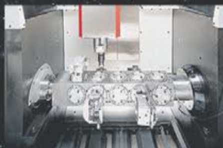
NC-uppspänningsbrygga för serieproduktion och 4- eller 5-sidig bearbetning
