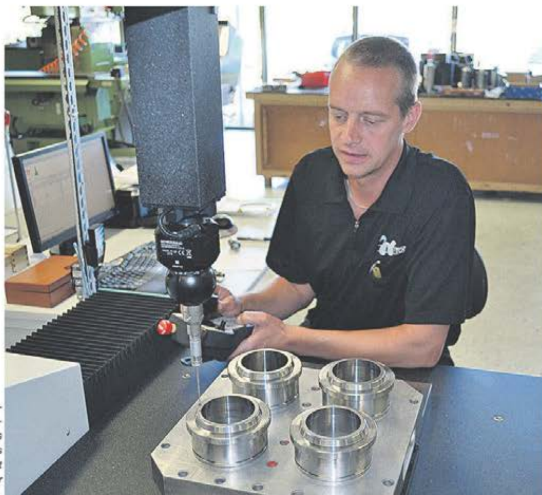
Niklas Antonsson mäter elektroderna. Alla värden, som x- och y-koordinater, registreras på ett chip som sedan scannas av inne i roboten. Datasystemet håller reda på vilka chip som är knutna till respektive maskin.
