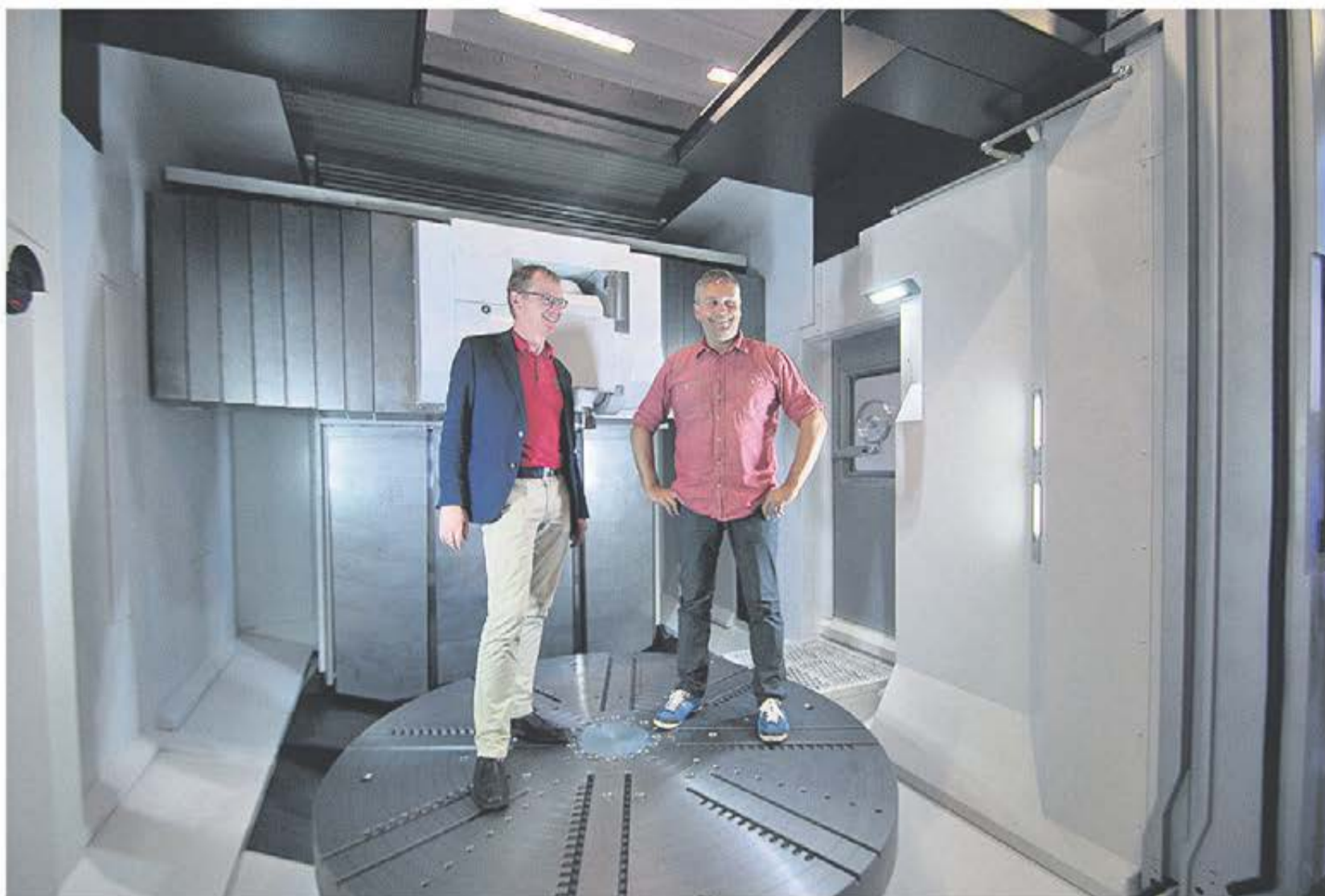
Jimmy Jensen maskinsäljare på Stenbergs och Victor Carlsson inne i bearbetningsutrymmet i maskinen. -Vi klarar 10 ton på bordet och detaljer med maxstorlek på 2 400 mm
