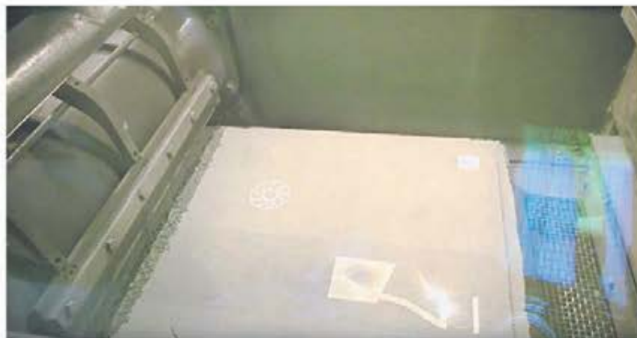
Inuti en metallskrivare: ett skikt med högupplöst pulver smälts med en kraftig laser. Skrapan och valse till vänster lägger sedan på nästa lager som kompakteras.
