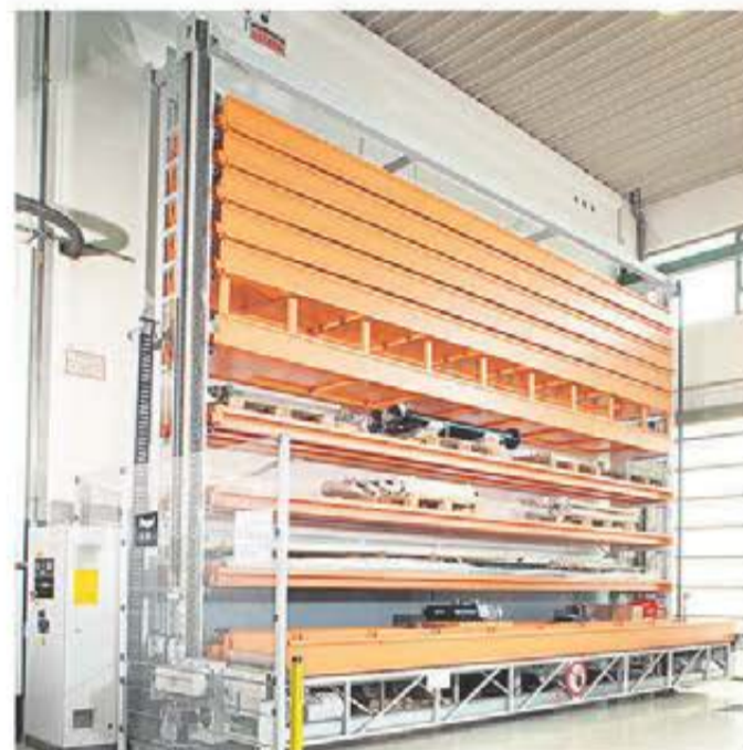
Tornlagersystemet UNITOWER är ett platsbesparande och ekonomiskt alternativ till klassisk golvlagering och pallställage.
