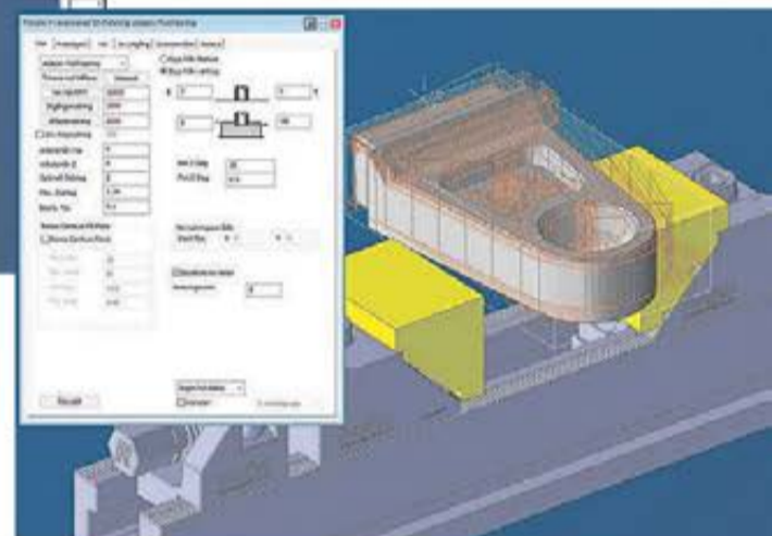
Adaptiv fickfräsning - ny högeffektiv metod för grovbearbetning, både för 2D och 3D detaljer med många valmöjligheter. Intelligent adaptiv metod med autoigenkänning av kavitet / källa producerar mjuka verktygsbanor väl anpassade för HighSpeedMachining och valsfräsning med stora skärdjup.
