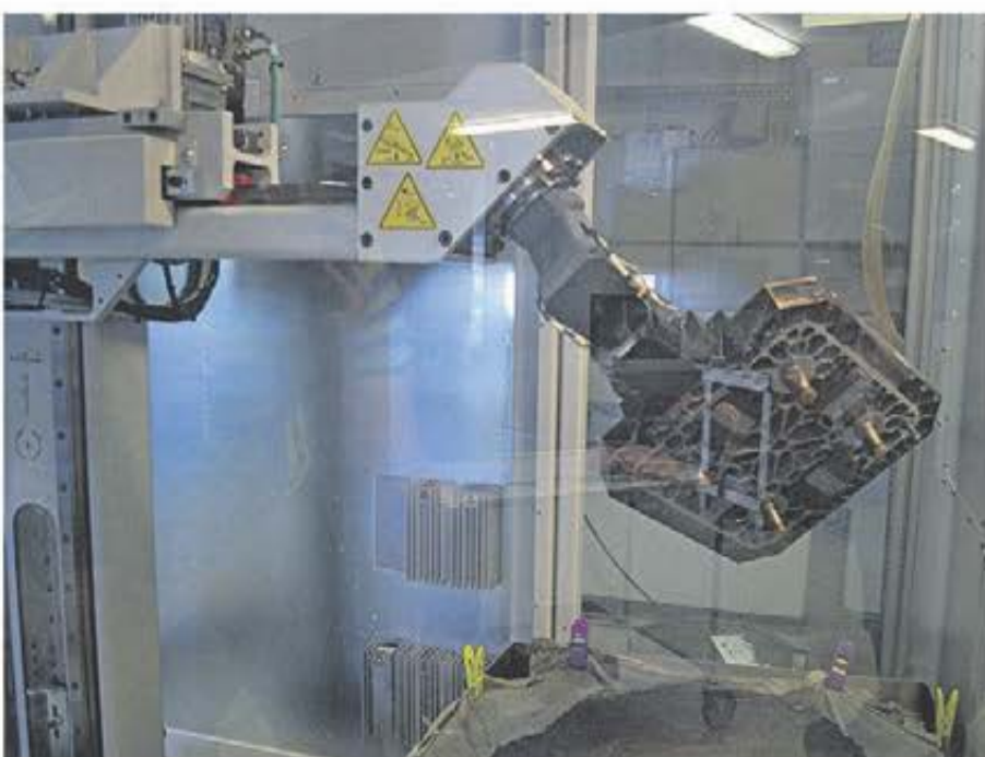
När paletten är färdig i sänknisten innehåller den mycket vätska som används vid bearbetningen. För att tömma den på vätska vrider roboten paletten när den hämtar den.
