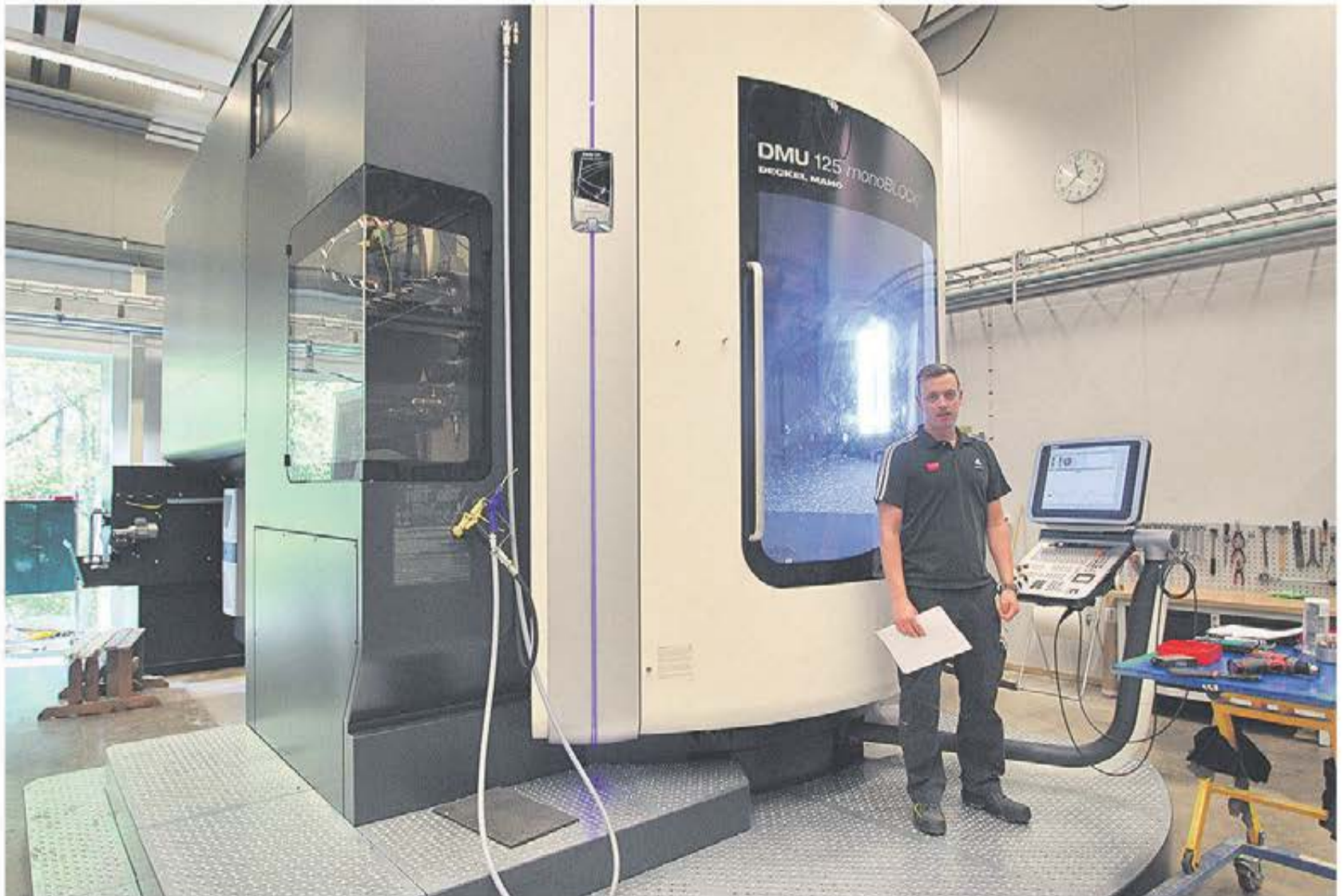
Högre noggrannhet och bättre stabilitet. Det uppnår man med den senaste maskininvesteringen, en 5-axlig fräsmaskin DMG DMU 125 monoBLOCK som kan bearbeta arbetsstycken upp till 1 400 mm i diameter och 750 mm i höjd. Maskinoperatör Joakim Pettersson är ansvarig för maskinen och programmerar i Tebis.
