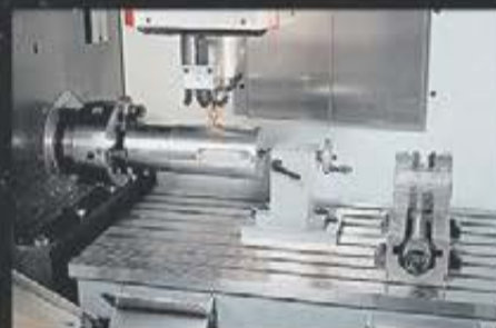
NC-rundbord och dubbdocka integrerade i maskinens fundament
