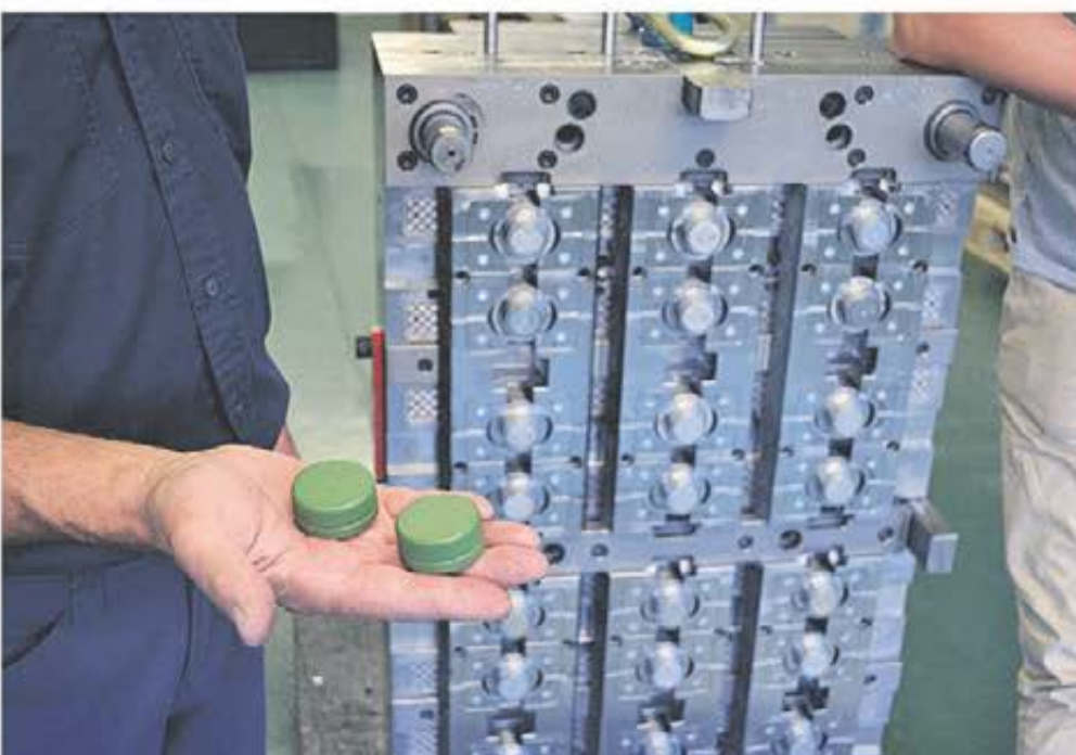
De stora plattorna köper företaget in, men allt som sitter inuti har de tillverkat själva.
