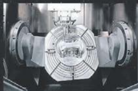
Tippbart stort NC-rundbord för 5-axlig bearbetning av detaljer upp till 2.500 kg
