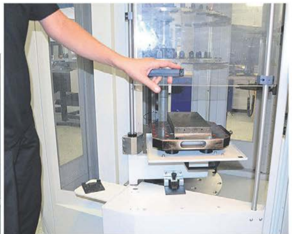
När paletten är färdig i sänknisten innehåller den mycket vätska som används vid bearbetningen. För att tömma den på vätska vrider roboten paletten när den hämtar den.
