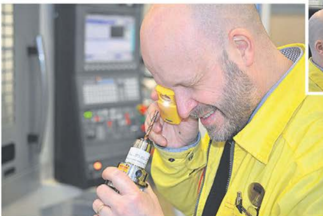
Henrik Liljeby pratade och visade olika frässystem med bl.a utbytbara huvuderna som Coromill 316. CoroMill 316 är mångsidig i ordets bredaste bemärkelse och kan användas för hög matning vid planfräsning, spårfräsning, spiralintolerering, fräsning mot skuldra, profilfräsning och fasfräsning av komponenter i alla material.
