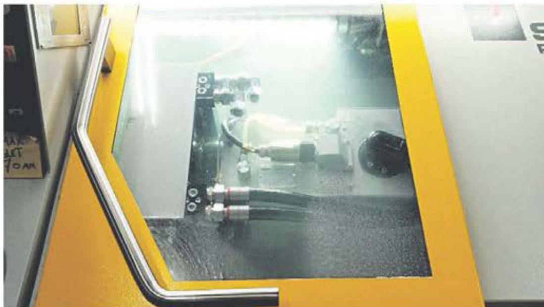
Bilden visar en maskin där föroreningen är enbart oljerök. Alla partiklar är mindre än 1 µm och halten av föroreningen klart över 150 mg/m 3 . Om ett Absolentfilter ansluts kan de partiklar som filtreras bort motsvara 7,5 oljefat per år.
