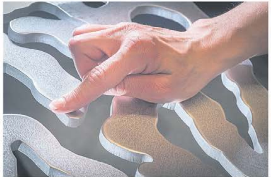
Alla som hanterar plåt, och särskilt högblankt material, vet att så fort man hanterar den blir det fläckar och repor. Oftast gör det inget, men om plåt detaljen skall vara synlig så vill man ha den perfekta ytan – som här på en blivande offentlig skulptur som kritiskt kommer att granskas.
