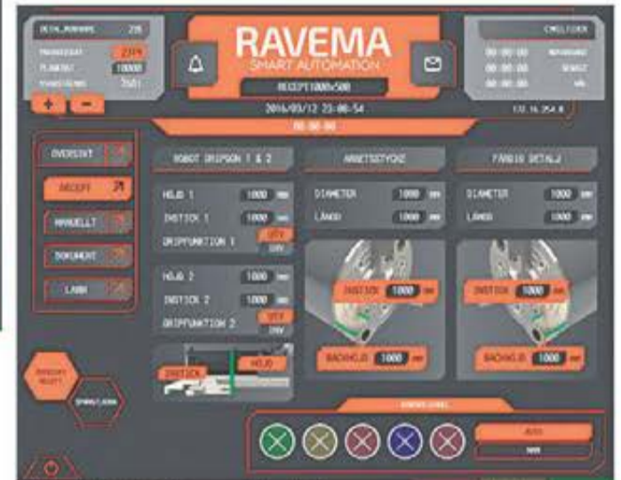
Med mindre än 15 numeriska värde programmeras roboten med det nya intuitiva grafiska operatörsgränssnittet.
