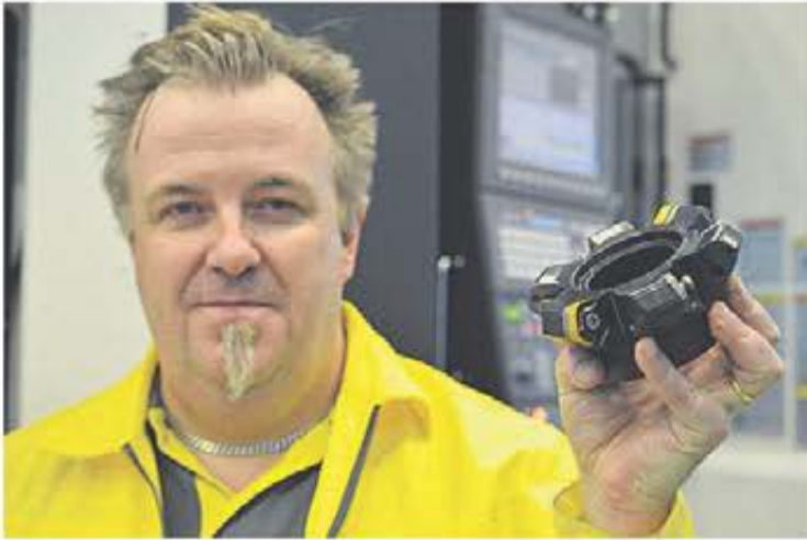
Mikael B. Larsson visade Coromill 300 en lättskärande plan- och profilfräs.
