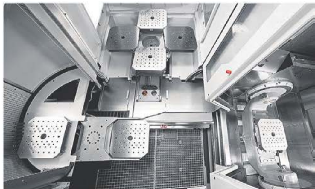
Blick in i palettväxlare PW 250 med riggplats (till vänster), 4-palettbuffert (baktill), paletthanteraren (i förgrunden) och maskinens arbetsrum (till höger).
