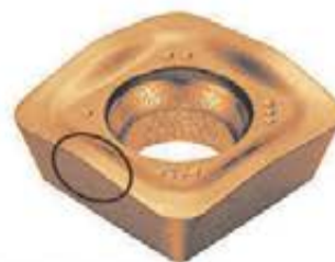
Konvex egglinje reducerar skärkrafterna
