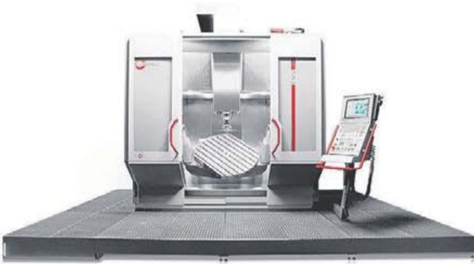
HERMLE C 52 U dynamic med NC-rundbord Ø 1150 och styrsystemet TNC 640.
