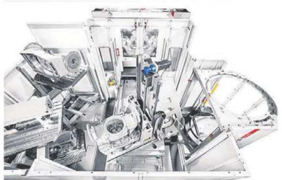
HERMLE C 52 UP dynamic med palettväxlare PW 3000 med 4 palettplatser, riggplats samt ett enkelt tilläggsmagasin för verktyg.
