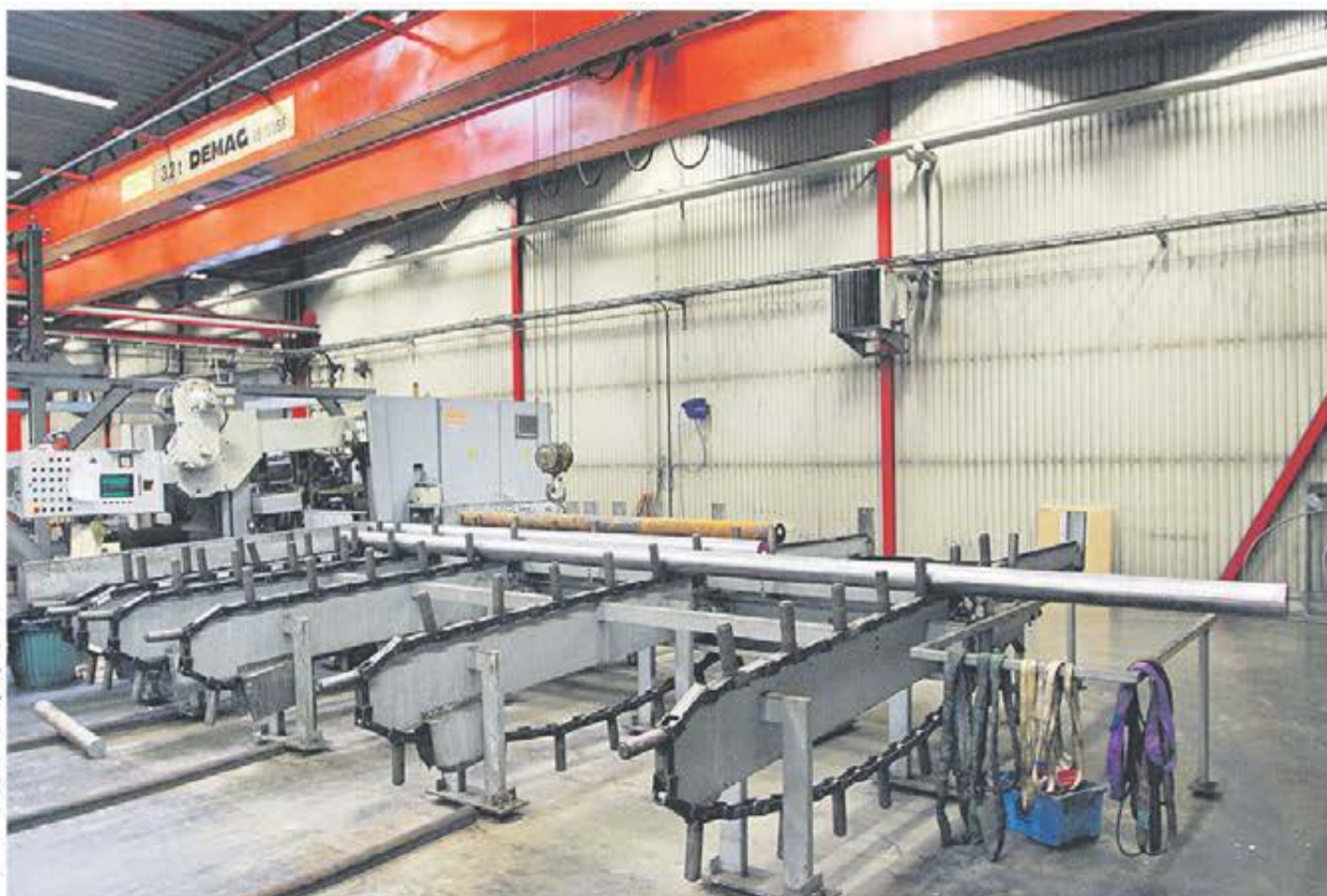
KASTO HBA 320/420 PM, tung produktionsbandsåg, försedd med kedjemagasin på materialinmatningssidan, vilket möjliggör laddning av olika material och dimensioner för en lång obemannad körning av olika sågordrar. Restbitsretur av ej uppkapat material. Sortering av kapade sågordrar sker sedan med automatik på sågens materialutmatningssida. Kapacitet upp till 320 x 420 mm. Sågbandsdimension 6800 x 38 x 1,3 mm. Skärhastighet 20-130 m/min.
