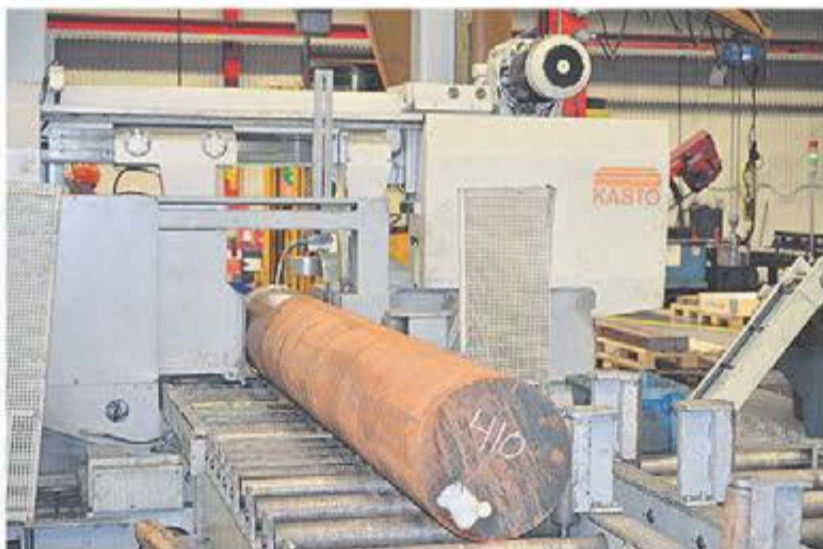
KASTO HBA 660 AU, helautomatisk produktionsbandsågmaskin i tung konstruktion, speciellt för verktygsstål och svårspånat material i grova dimensioner. Maskinen är försedd med genomgående rullbana för enklare hantering av stora dimensioner. Kapacitet upp till 660x660 mm. Sågbandsdimension 8585x67x1,6 mm. Skårhastighet 20-130 m/min
