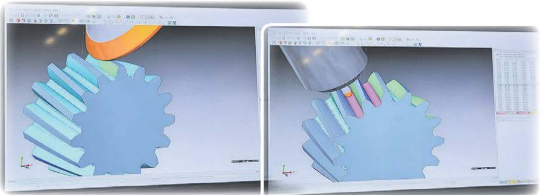
Programvaran InvoMilling 1.0 är mycket användbar med sin utmärkta grafik, fräsvägs-generering och simuleringsfunktion. Den har tagits fram av Sandvik Coromant och Euklid, ett företag med specialkompetens inom kuggar och avancerade CAD/CAM lösningar.
