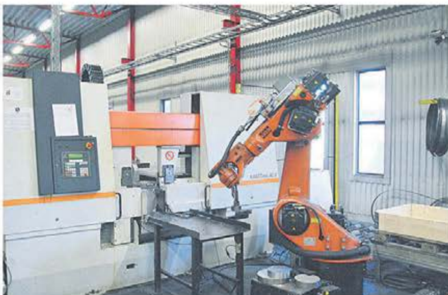
Bandsåg KASTOtec A5 plus industrirobot arbetar i en helt automatiserad process. Roboten monstrelägger materialet på pall om kunden önskar.
