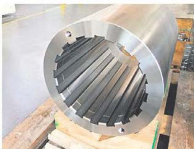
Kilspår dragna ett i taget med hjälp av indexerande rundbord.
