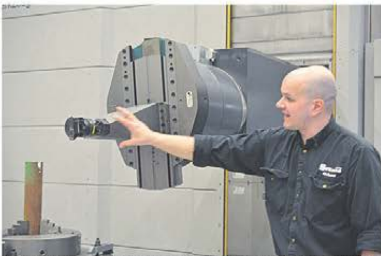
Richard Andersson visar fördelarna med växlingsbara fräshuvuden och betonar vikten av att använda långa bommar när det gäller bearbetning för bästa åtkomst utan vibrationer. Här berömmar han Sandvik Silent Tools® är varumärket för ett sortiment med verktyghållare för svarvning, fräsning, uppborring och borming. Verktyghållarna är konstruerade för att minimera vibrationer med hjälp av en dämpare
