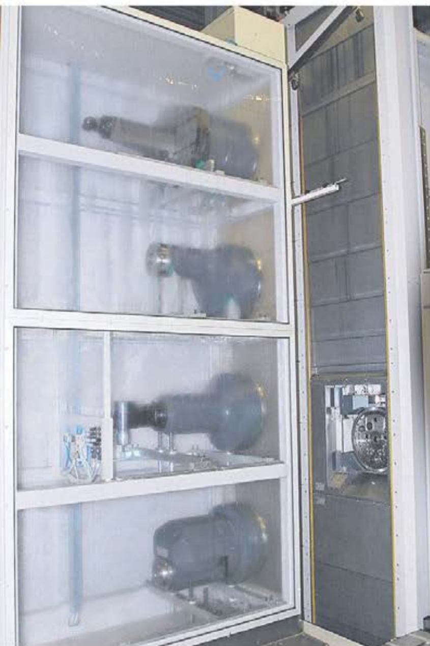
Växarsystemet för maskinhuvuden där man väljer helt automatiskt vilket man vill använda. Bytet av huvud går snabbt.
