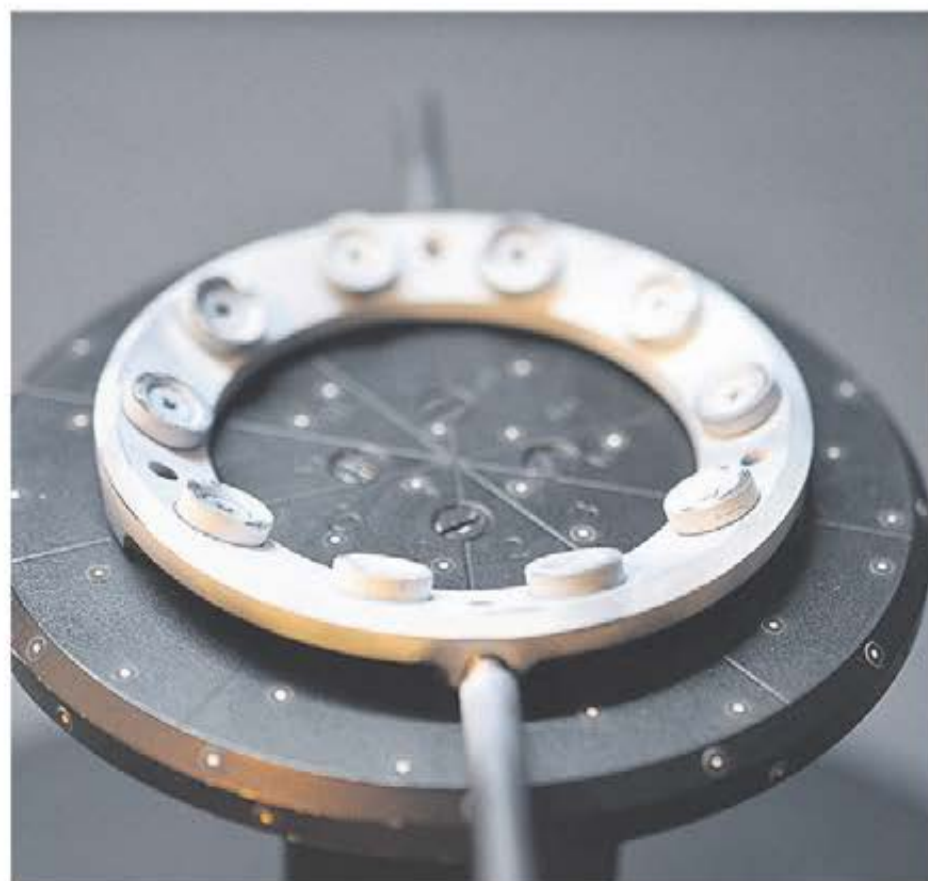
Fixtur för mätning av små detaljer i en automationscell.
