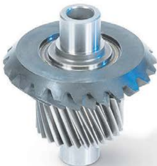
Genom att lasersvetsa differentialhuset med kronhjulet blev komponenten 1,2 kg lättare.
