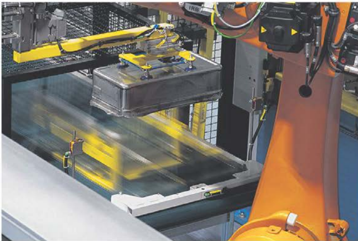
AP&T har byggt en fullt automatiserad och integrerad produktionslinje för Aesculaps tillverkning av sterilcontainrar för kirurgiska instrument och annan operationsutrustning.
