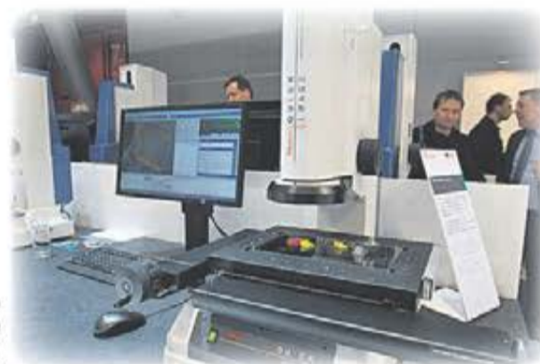
Quick Image är ett beröringsfritt 2D vision system. Enkelt handhavande med ett-klicks-mätning för maskinoperatören.
