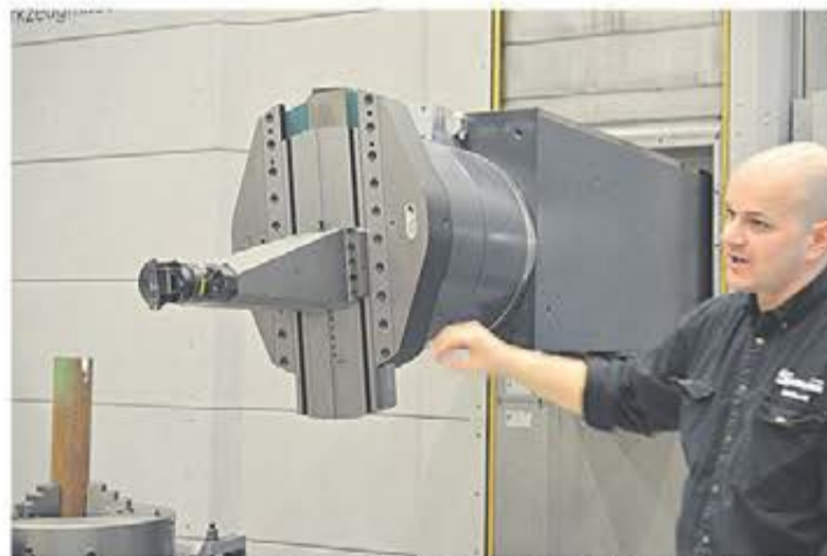
Richard Andersson visar fördelarna med växlingsbara fräshuvuden och betonar vikten av att använda långa bommar när det gäller bearbetning för bästa åtkomst utan vibrationer. Här berömmar han Sandvik Silent Tools® är varumärket för ett sortiment med verktyghållare för svarvning, fräsning, uppborring och borming. Verktyghållarna är konstruerade för att minimera vibrationer med hjälp av en dämpare
