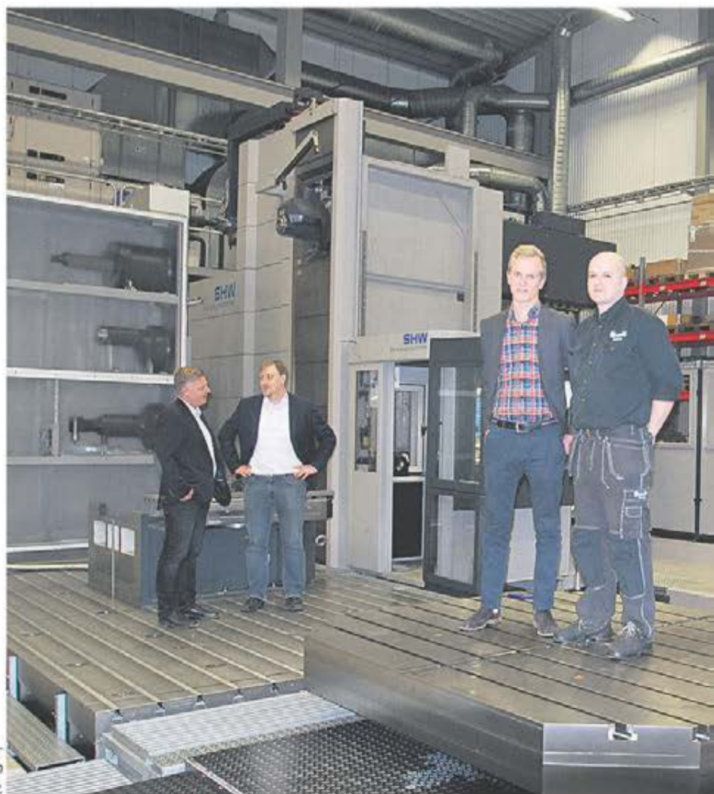
Cirka 160 kg på bordet som tar 35 ton. I bakgrunden ser vi maskinens huvudväxelsystem med fråshuvuden för olika applikationer.
