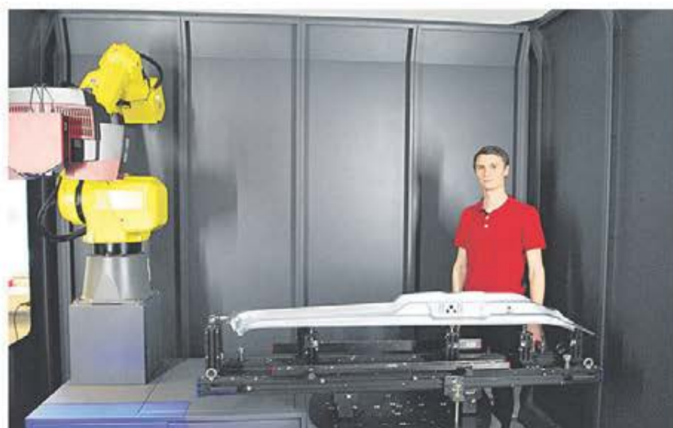
Foto på ATOS Scanbox 5120, scanning av B-stolpe.
