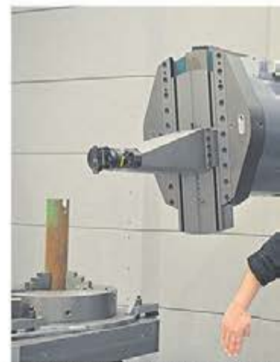
Richard Andersson visar fördelarna med växlingsbara fräshuvuden och betonar vikten av att använda långa bommar när det gäller bearbetning för bästa åtkomst utan vibrationer. Här berömmar han Sandvik Silent Tools® är varumärket för ett sortiment med verktyghållare för svarvning, fräsning, uppborring och borming. Verktyghållarna är konstruerade för att minimera vibrationer med hjälp av en dämpare
