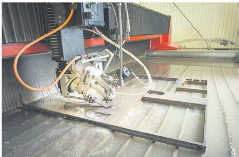
Dubbla skärhuvuden som klarar allt! Ett exempel på tillbehör är en borrar i vattenskären. Om man skall skära i trä laminat borrar först ett hål där vattenstrålen skall börja skära. Detta för att undvika att vattnet tränger in mellan träskikten vid hålslagningen.
