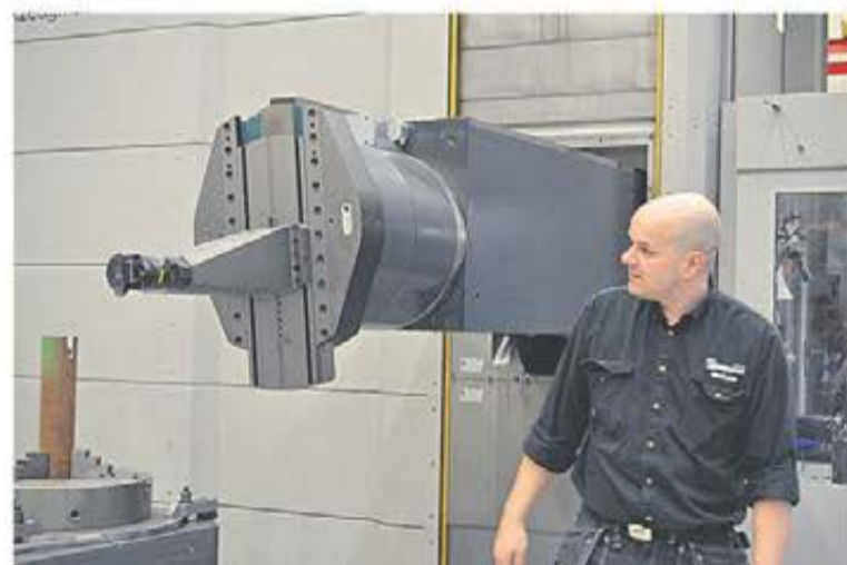
inne i verktygskroppen. Merparten av Silent Tools-kunderna använder dessa verktyg för långa överhäng som ger stora produktivitetsökningar och förbättrad ytjämnhet. Källa Sandvik Coromant.
