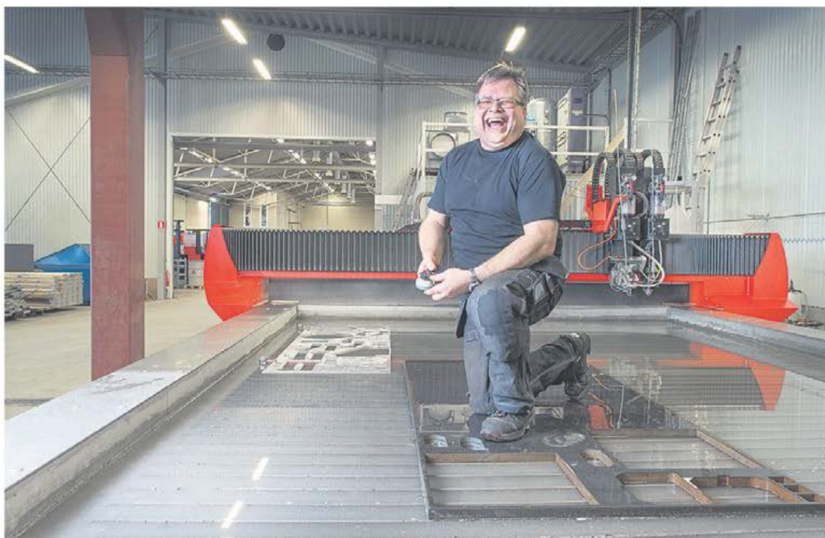
Hjärtat i anläggningen är en ByPump Direct+ som levererar ett tryck på 3600 bar vilket skär de grävsta materialen som går att tänka sig, och i alla tänkbara material säger Peter Stenqvist.
