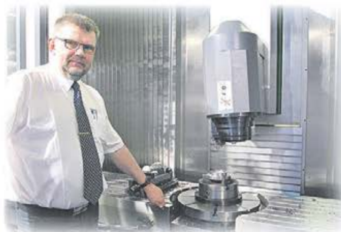
Kjell Gallneby visade en AXA 5-axlig VHC 2-1760 XTS /50 D, vertikal flerooperationsmaskin med steglöst fråshuvud samt horisontalt svarvbord.
