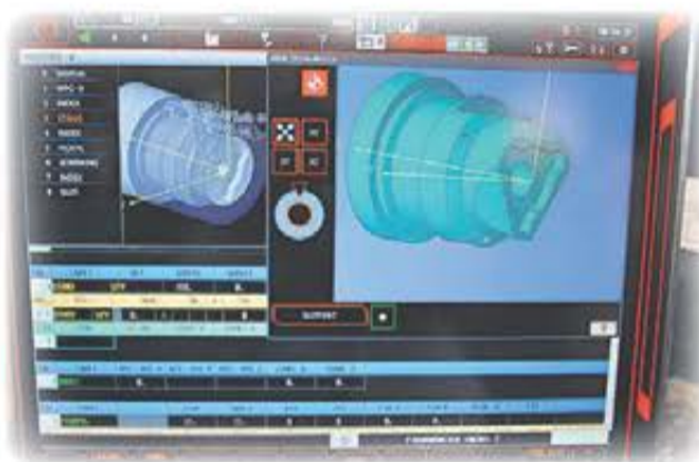
Import av 3D-solider till Smooth systemet, allt styrs med touch kontroll.
