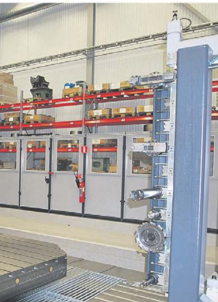
Växarsystemet för maskinhuvuden där man väljer helt automatiskt vilket man vill använda. Bytet av huvud går snabbt.
