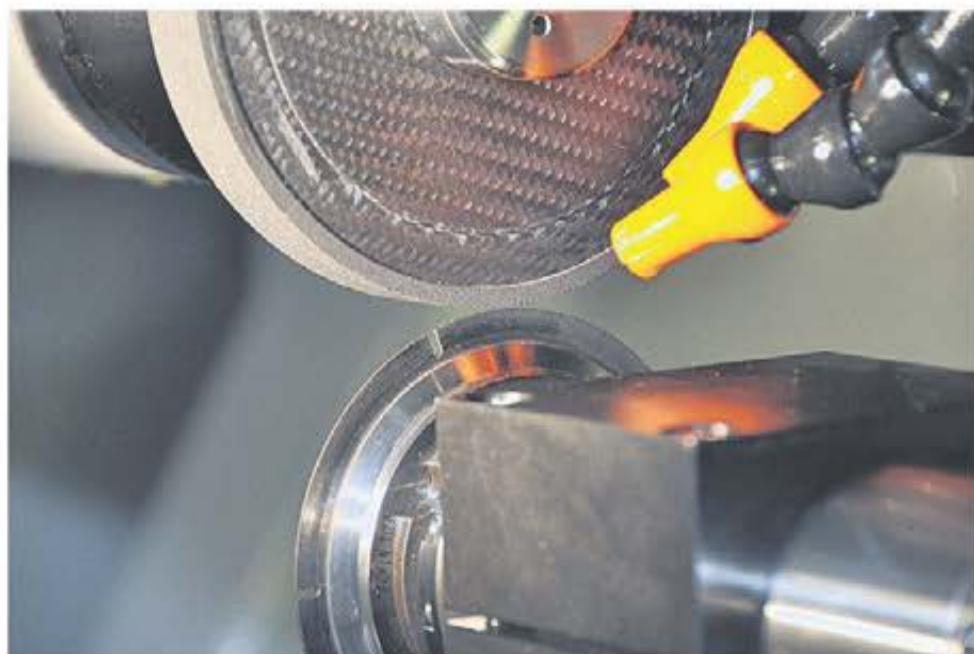
Winter har utvecklat ett nytt system skärprullar för skärpning av keramiska slipskivor samt diamant- och CBN-slipskivor. Det nya sortimentet omfattar två olika typer av skärprullar för CNC-skärpning: DDS Plus och DDS Cut.
