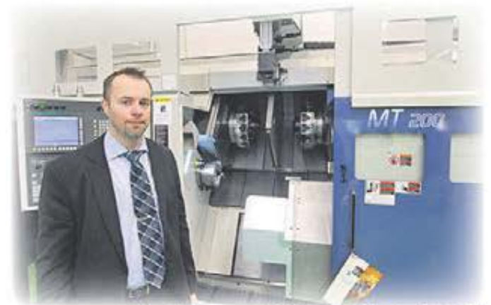
Henrik Fransson på MAF visade Muratec MT 200 G T3, cnc-svarv med dubbla spindlar, 3 revolverar med Y-axlar och portalrobot för laddning och plundring.
