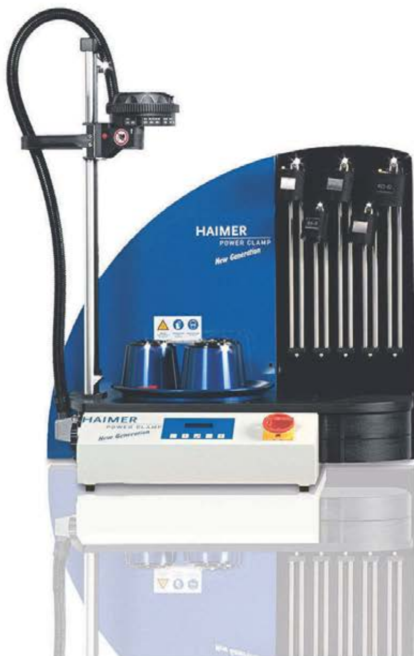
P05_HAIMER_Power Clamp Comfort NG HAIMER Power Clamp Comfort NG är tillverkad för högt ställda krav. Som med alla HAIMER Power Clamp maskiner kan i- och urkrympning göras av HSS och solida verktyg, med en diameter från 3mm till 32mm, snabbt och utan begränsningar.
