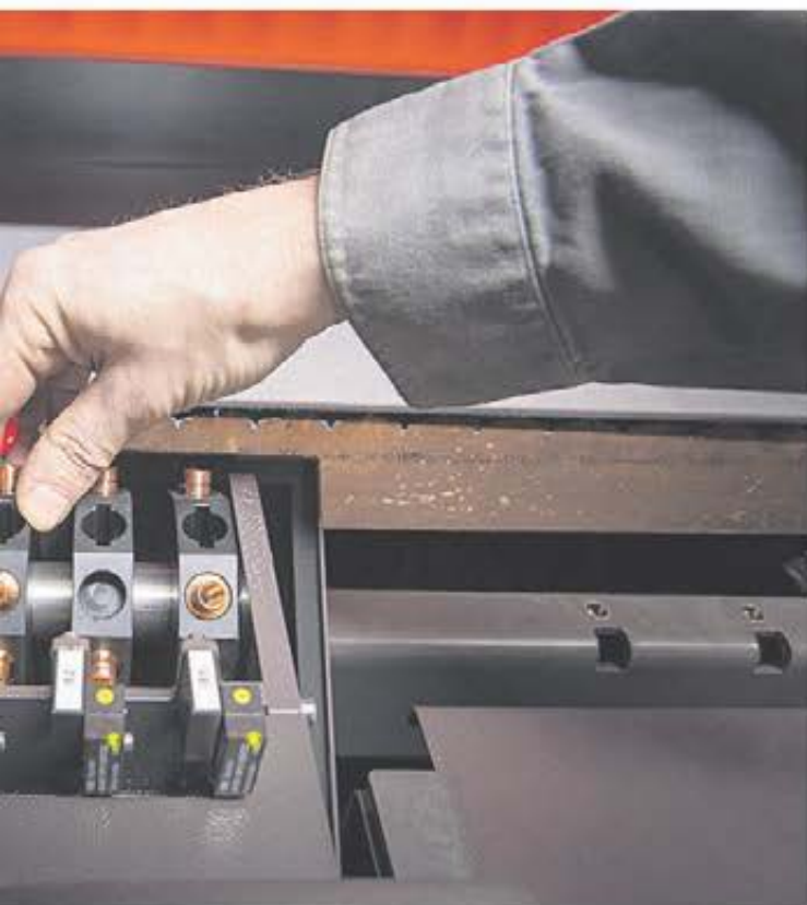
En kassett med munstycken laddas, och laserskäraren byter själv huvud utifrån den dimension på plåten som skall skäras.
