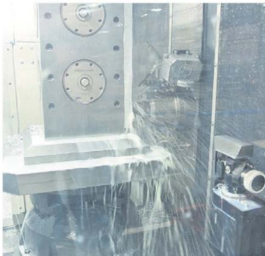
En Heas fleropmaskin med mätprobe "in action" på Andrénerken.
