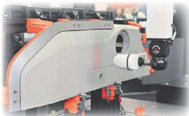
Kontroll av detalj i mätmaskin med multiprob- kontaktmätning med konventionell mätprob eller laserscanner.
