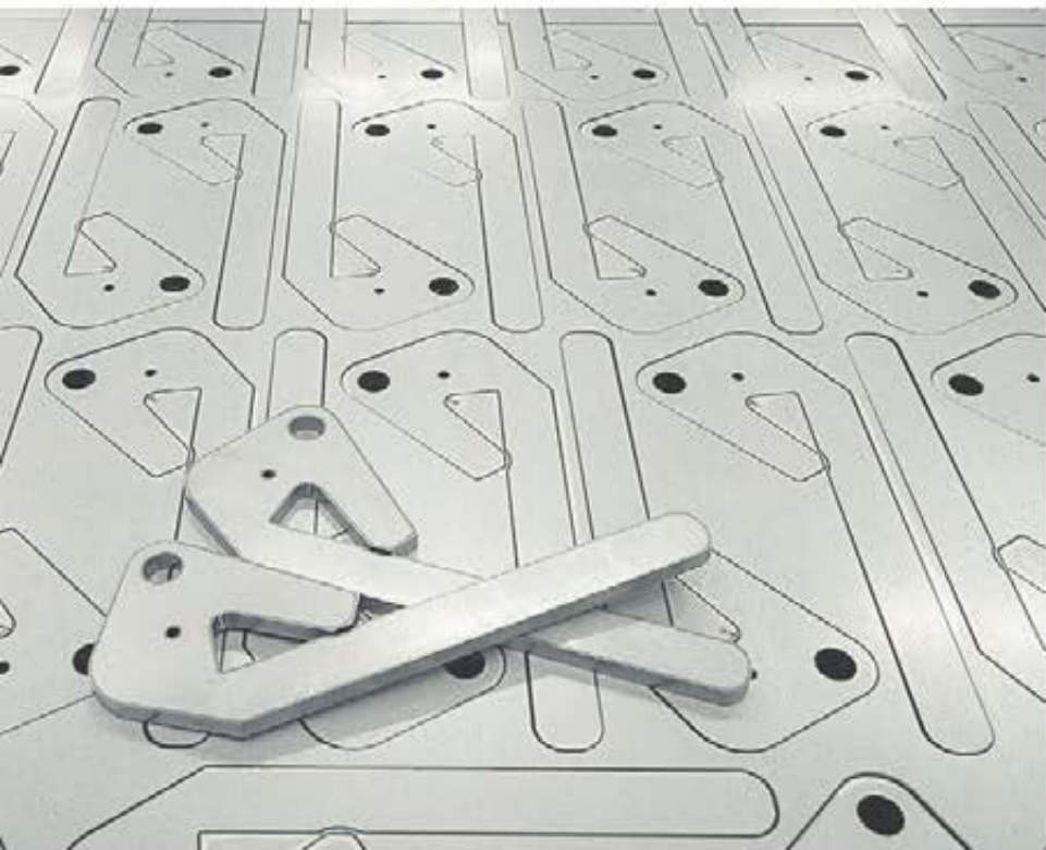
Färdigskuret i svartplåt! En detalj till en låsbygel för en truck är utskuren, det gick att utvinna 265 stycken ur en enda plåt.
