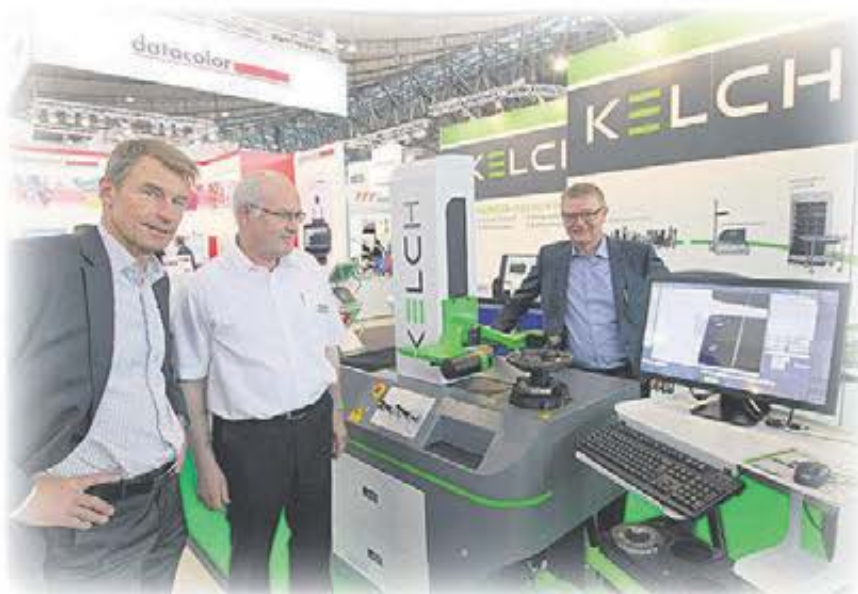
Optisk mätmaskin Kelch Kenova VHE där man med fördel, snabbt mäter små svarvade detaljer.
