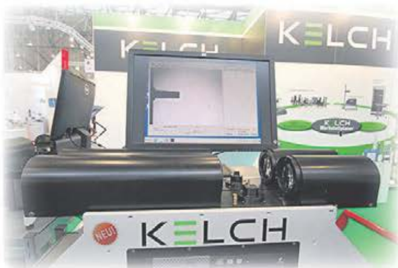
Optisk mätmaskin Kelch Kenova VHE där man med fördel, snabbt mäter små svarvade detaljer.
