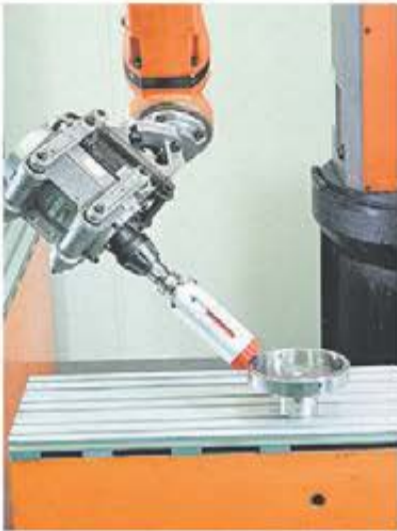
Gradning med laddrobot utanför CNC-maskin
