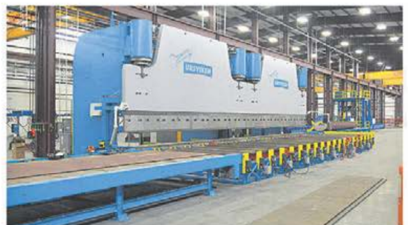
Två av Ursvikens större maskiner kopplade i tandem med automatisk inmatning.
