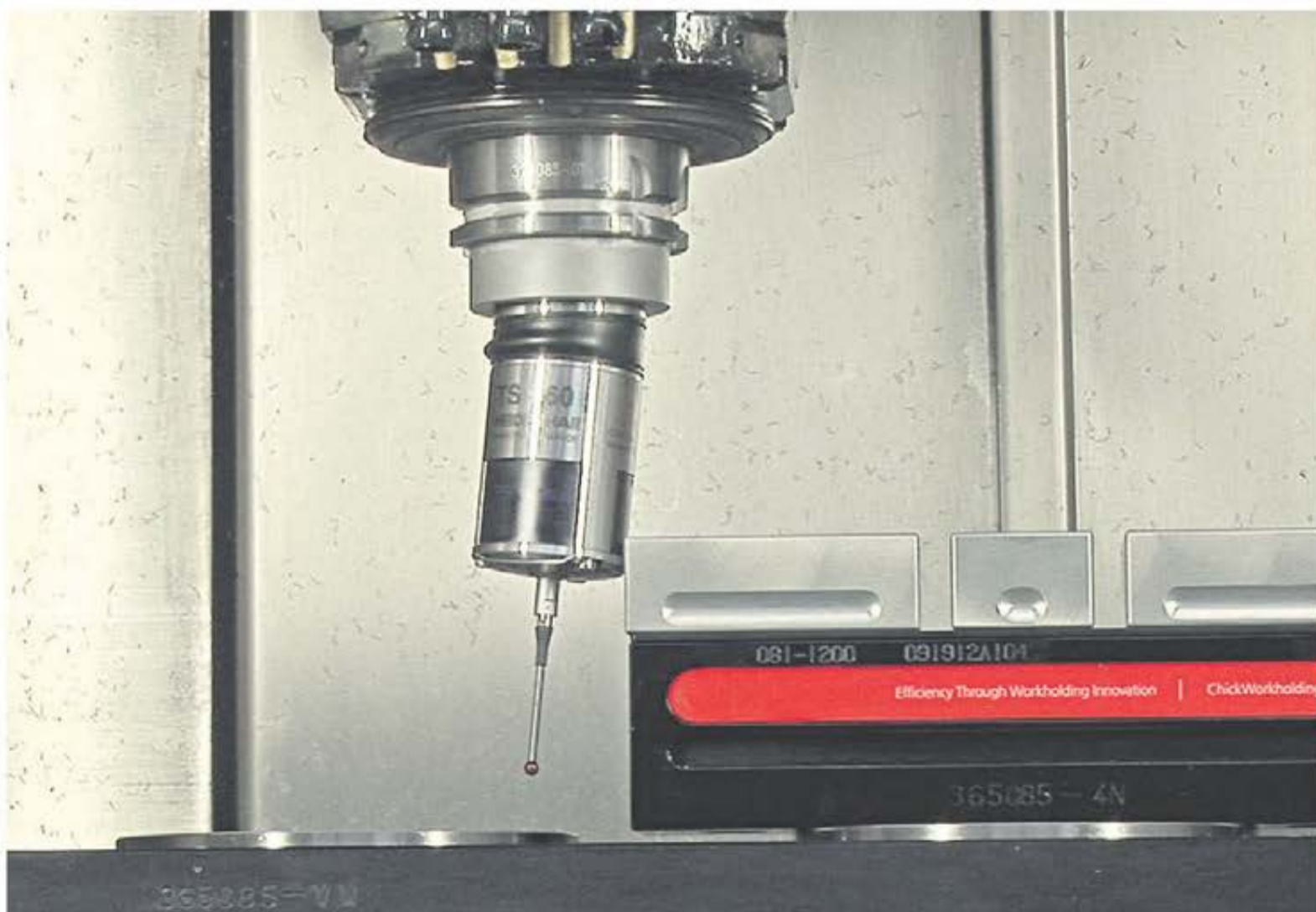
Heidenhain touch probe TS 460 med mekaniskt kollisionsskydd fjädrar ut och stoppar maskinen.
