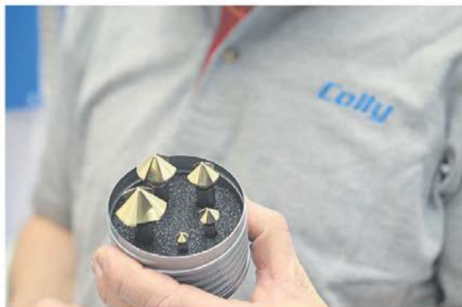
Tyska Mapal lanserar nu en helt ny generation försänkare. Skärepparna är diffdelade vilket resulterar i minskade skärkrafter vilket ger ett mer lättskärande verktyg och minskade vibrationer.
