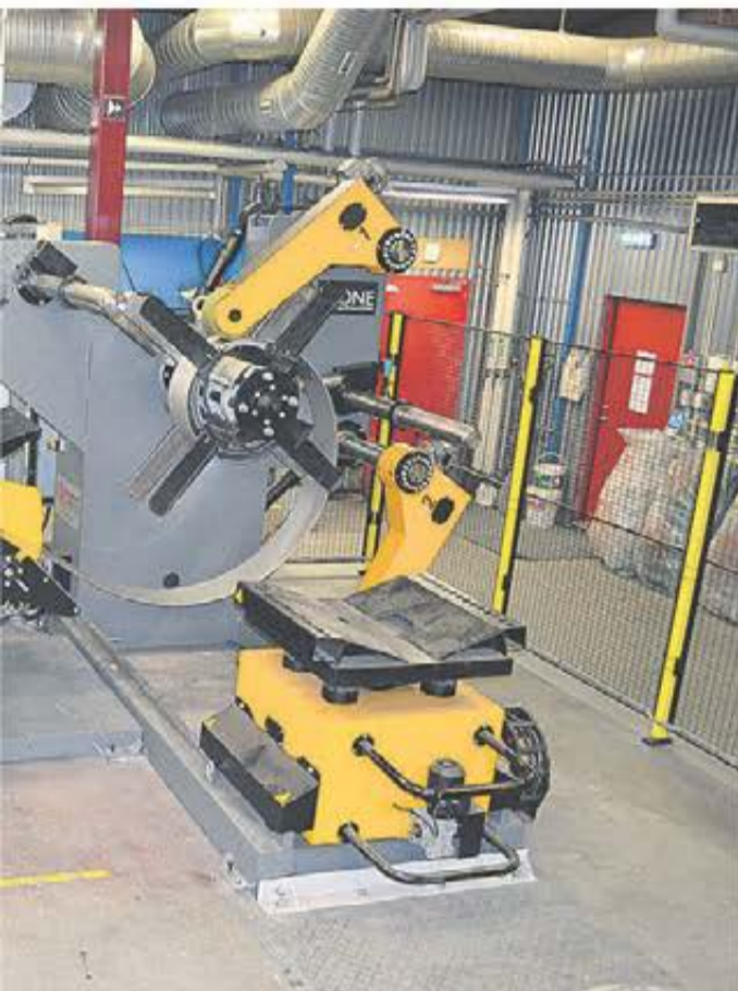
Den kraftiga haspeln klarar vikter upp till 6 000 kg, och har en max coilbredd på 700 millimeter.
