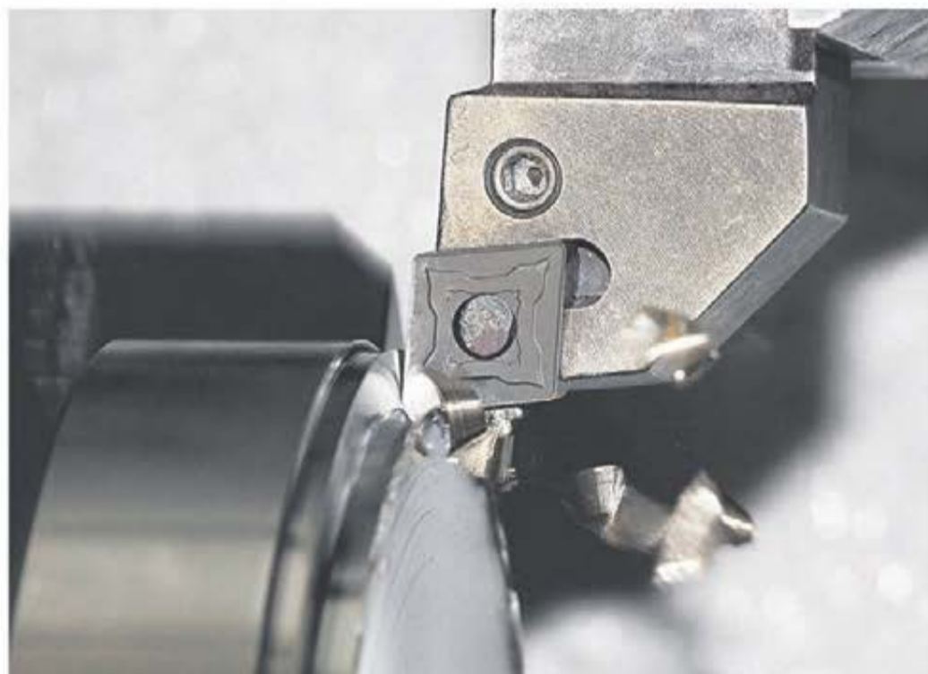
NMR-spånbrytaren används främst vid medelgrov- och grovsvävning.
