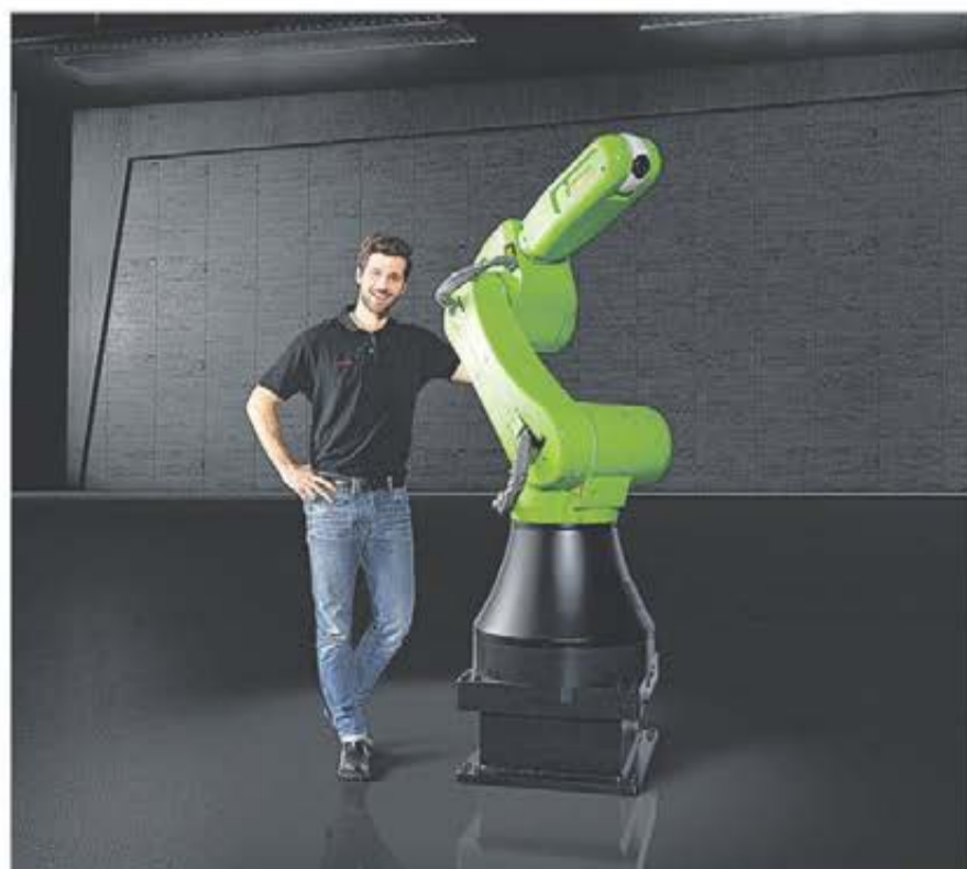
Den samverkande roboten CR-35iA från FANUC lyfter 35 kilo och behöver inget skyddsstängsel vid arbete med människor.
