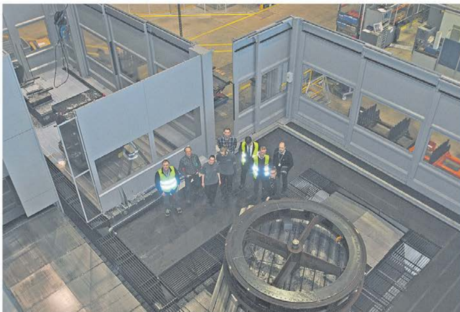
Det gigantiska golvfräsverket från tyska maskintillverkaren SHW mäter sammanlagt 16 x 4,1 x 1,6 meter i bearbetningsyta.
