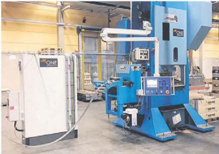
En äldre SMV pressline som One Automation renoverat och satt ett nytt Total Control styrsystem på.
