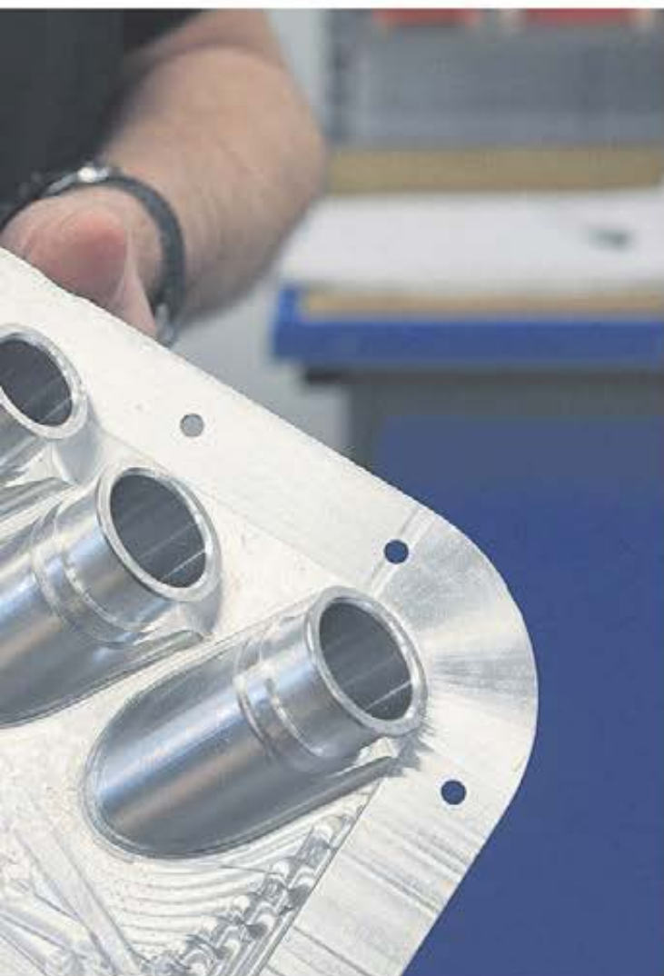
Här ser vi en detalj som är ett utmärkt exempel på vad man kan tillverka i 5-axlig bearbetningsteknik, snabbt, hög kvalitet och från ett massivt aluminiumblock i en uppspanning.
