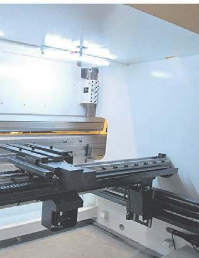
Bakre anslaget är "hjärtat" i maskinen. Härifrån styrs vilken noggrannhet man erhåller.
