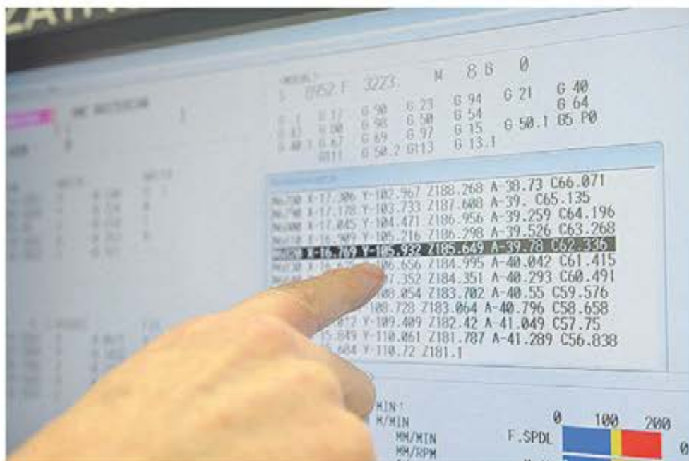
Här ser man raden med 5-axlig maskinkod i styrsystemet Mazatrol. 5 servon (axlar) programmeras i ISO kod med Mastercam.
