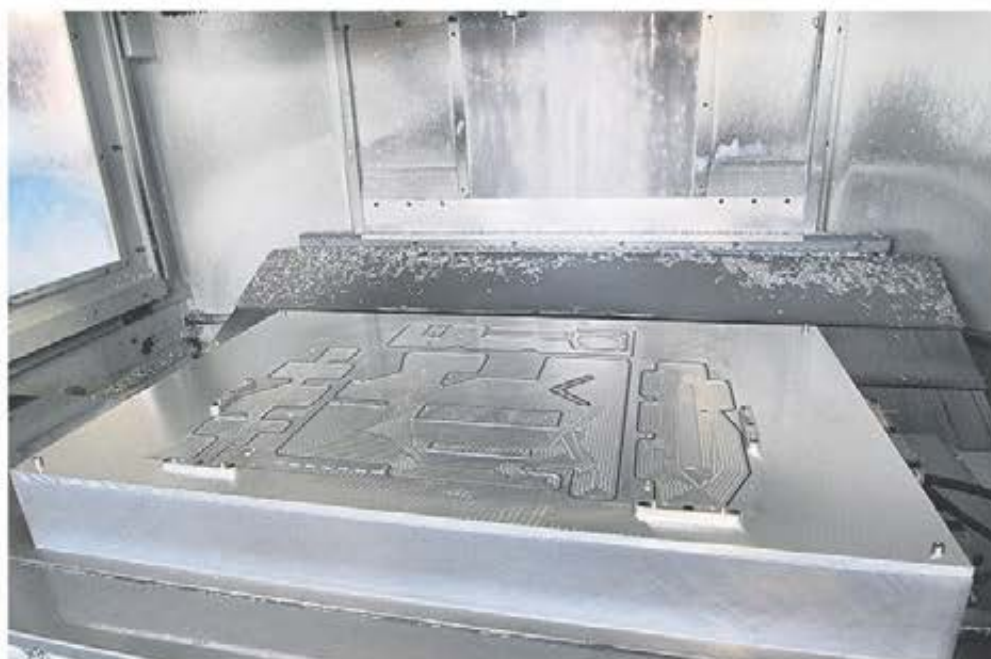
Fastspänningen med detta vakuumbord är en ytterligare nyutvecklad vakuumteknik.
