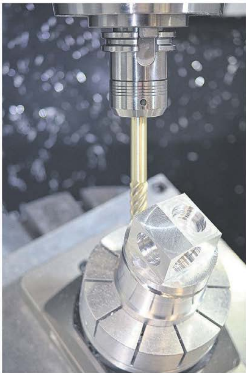
5-axlig simultan bearbetning i Mazak Variaxis J500 5X.
