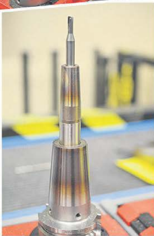
Ett tjugotal cnc-maskiner med flera hundra verktyg i verktygsmagasinen, där femton till tjugo verktyg behöver kontrolleras i varje serie/artikel gör att Husqvarna sparat mycket tid men sin nya cnc-styrda förinställare.
