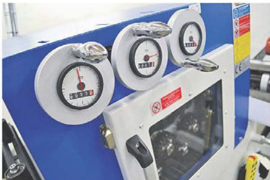
Anläggningen har en mycket noggrann valsmatning med flera möjligheter att justera matningen.
