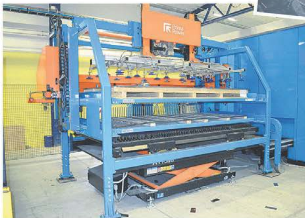
COMPACT SERVER för laddning av plåtämnen och hantering av skelett.
