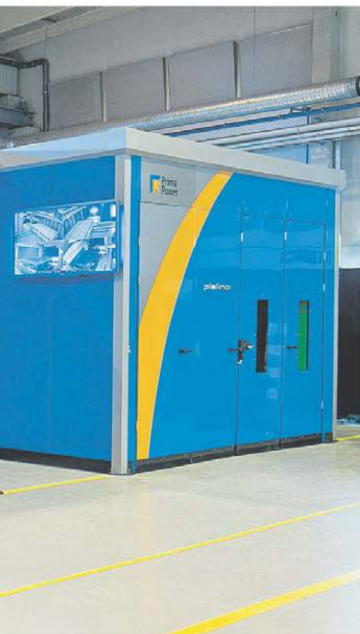
PLATINO fiber med LST-robot. Rent och snyggt med hela systemet inbyggt i skyddskabin. Till höger syns systemets sluss för plundring av staplade detaljer
