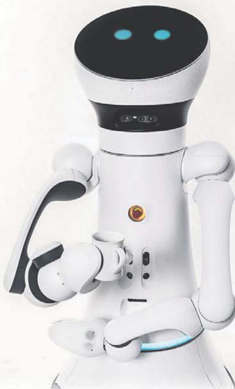
Den standardiserade lättviktsarmen SCHUNK Powerball möjliggör tillsammans med 1-fingerhanden olika gripoperationer.
