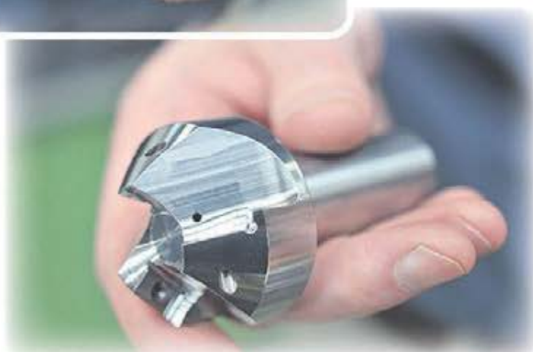
Produktion av specialutvecklade vändskärshållare på Kyocera i Danmark. Hållarna kan ha många olika geometrier, beroende på bearbetningsuppgiften. En specialutvecklad Kyocera MEC vinkelfräs, som är designad och producerad i Danmark. Skafftråsen är anpassad med en 50° fas. Till hållaren kan hela Kyoceras standardprogram av BDMT vändskär användas.
