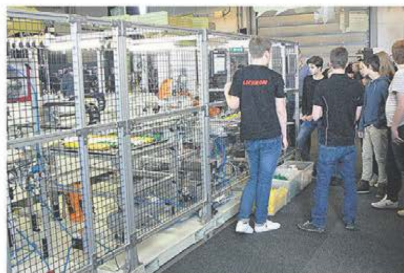
Helautomatiserad cell från Volvo med bilmontering i miniatyr. Cellen innehåller robotar med vision-teknik. Robotarna bygger och förflyttar bilar, monterar tillbehör och sorterar dem obemannat.
