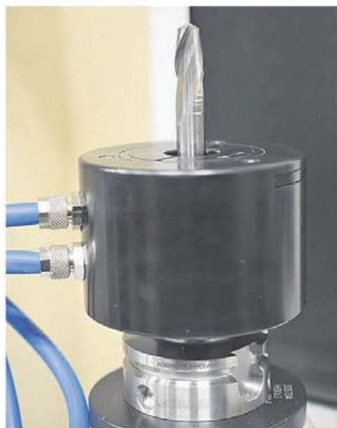
Nedkylning av verktyget. På maskinen finns ett integrerat slutet kylvätskesystem och en adapter kyler ner verktyget från ca. 330 grader. Efter mindre än 1 minut kan man ta i verktyget.
