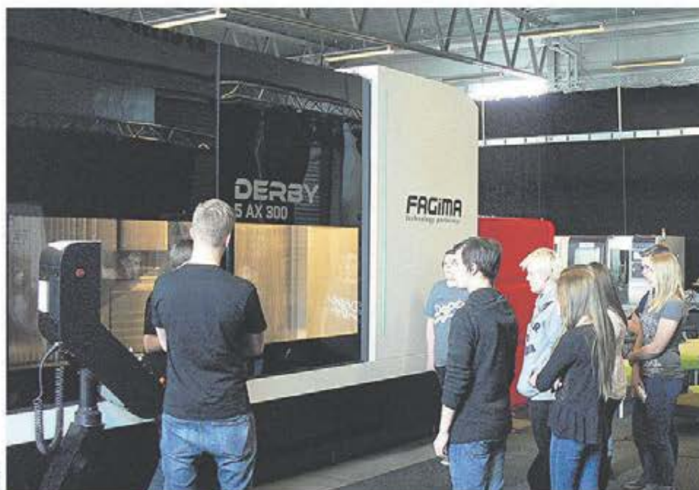
CNC-avdelning med fleroperationsmaskin och svarv. Detaljerna som körs har beretts i CAD-CAM system. Även 5-axlig fräsmaskin visas för att besökarna skall förstå komplex tillverkning.
