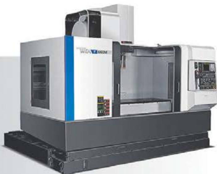
F500. Vertikala flerooperationsmaskiner i många olika storlekar. Finns i femaxligt utförande.
