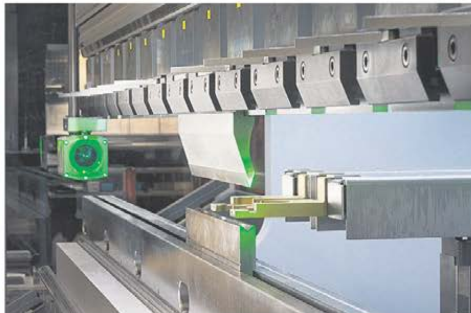
Verktøjshållare med adapter. Det gröna ljuset kommer från säkerhetsavkänningen som stänger av så att inga fingrar kommer i kläm.
