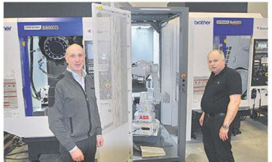
Per Svensson maskinsäljare och applikationstekniker Anders Isaksson vid den automationscell som just nu byggs till en svensk kund. Automationscellen består av en Brother Speedio S 500X1 och en Brother Speedio R450 X1, som betjänas av en SVIA robot.
