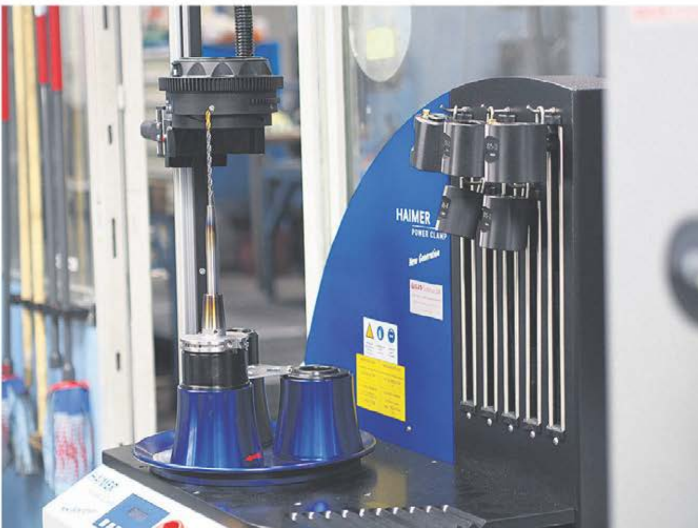
Atlas Copco har ofta behov av långa slimmade verktyg och då är krymp ett oslagbart system,
