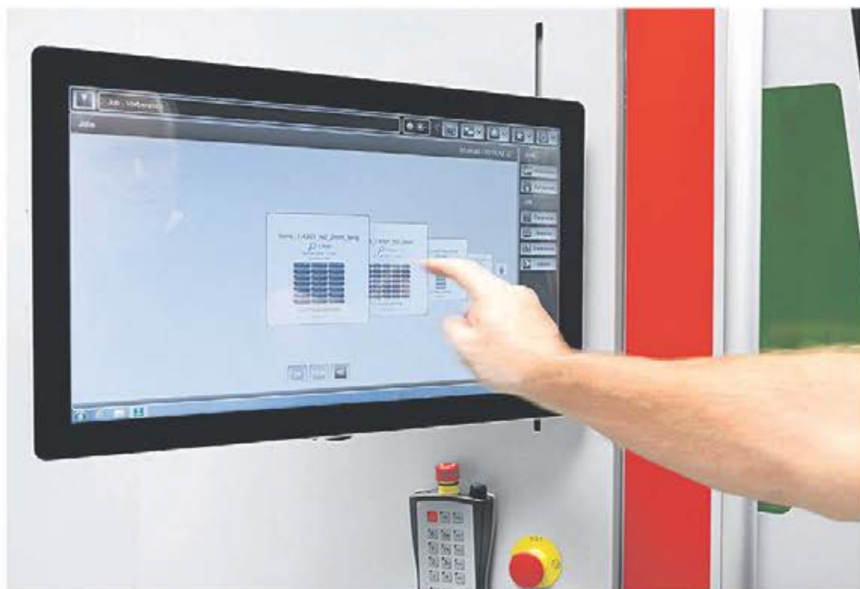
I det nya användargränssnittet ByVision Cutting har Bystronic samlat alla laserskärningens funktioner på en och samma pekskärm.
