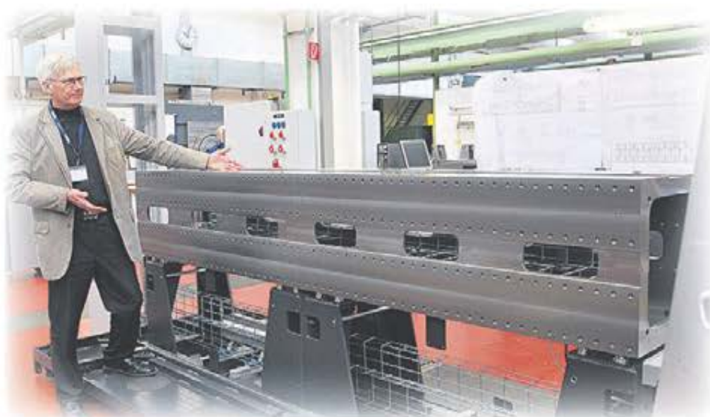
Här har vi ett exempel på ett svetsat understativ med gjutgodsmoduler för att klara av mycket snäva toleranser som "sväljer" allt vad vibrationer heter och får en hög stabilitet.
