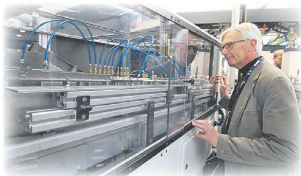
BIHLER har utvecklat olika matar- och hanteringssystem för komponenter som transporterar materialet in i maskinerna med vibrations matare och olika typer av instymningsrännor.
