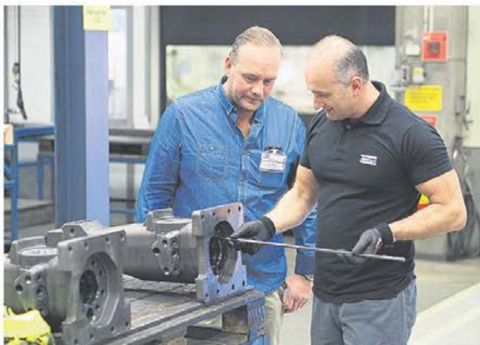
Kim och Denis inspekterar den Solida HM pipborren som används till Hammarkropparna.
