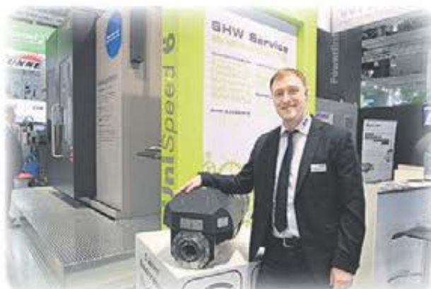
Sebastian Abele från den tyska maskintillverkaren SHW visade upp företagets nya fräshuvud med integrerad frässpindel upp till 24 000 rpm.
