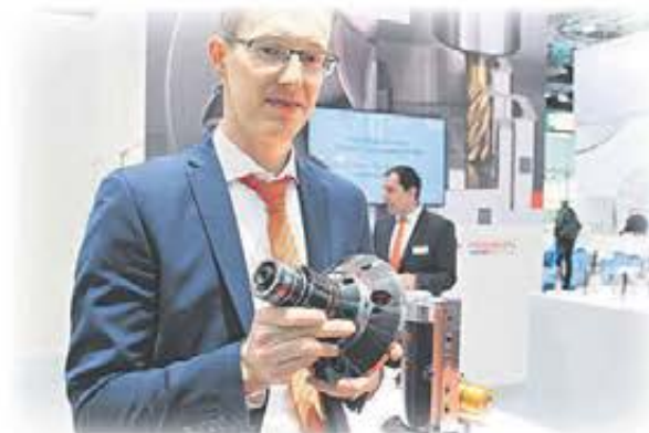
Harald Rau regionansvarig för spänntechnik för EMUGE Franken i Tyskland. På bilden ser vi ett kundspecifikt hållande verktyg för uppspänning produkt i CNC maskin, kunder med höga krav på rundgångsnoggrannhet (0,003 mm) samt hållande kraft väljer denna typ av hållande verktyg.
