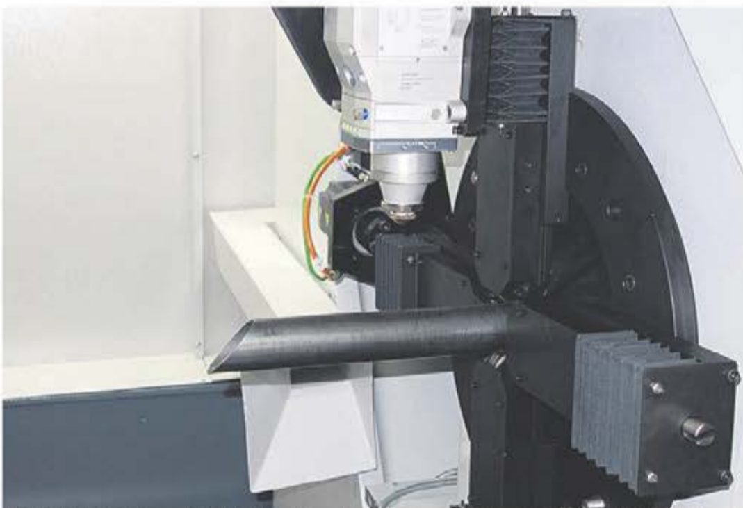
HD-TC 60170 kan skära maximalt 6500 mm långa rör med en max diameter på 170 mm med sitt 2D skärhuvud.
