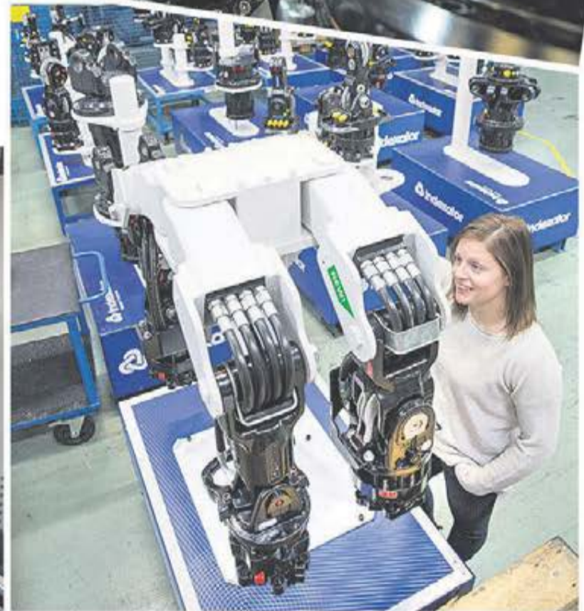
Produktionsteknisk koordinator Kristina Johansson visar en nyhet – en rotator med inbyggd väg och med en ny, tightare slangdragning som minskar risken för att t ex grenar ska slita av slangarna vid avverkning. – Att byta slangar när det är minus 20 grader ute är inte populärt, berättar hon.
