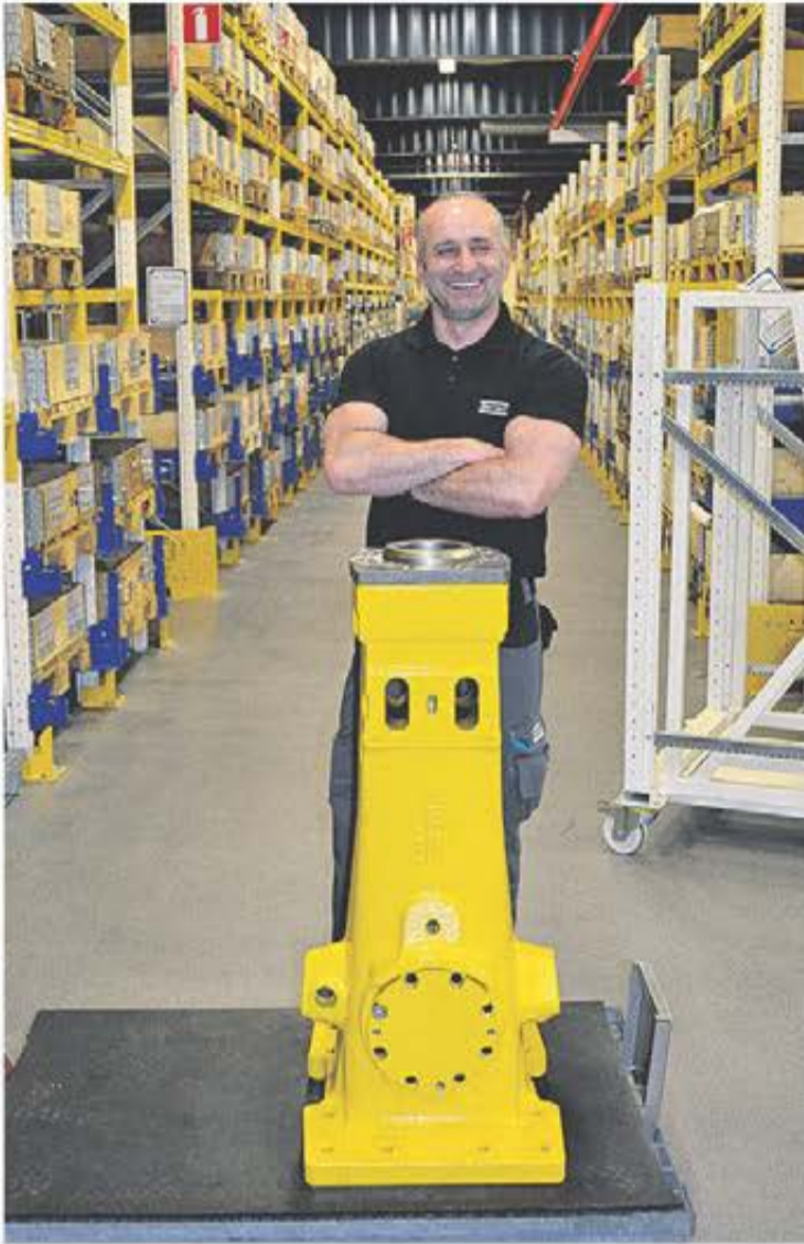
Mycket kraft på Atlas Copco Construction Tools. Den största hydraulhammaren, SB 702, för bärare från 10 till 17 ton har en slagfrekvens på 600 - 1050 blows/min.
