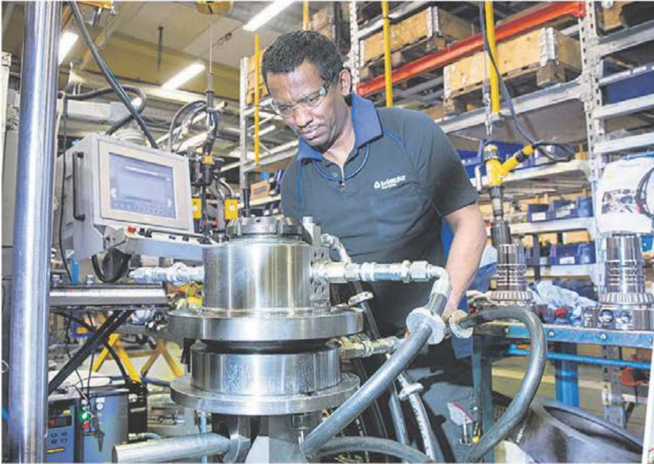
Montör Arron Khebre funktionstestar en rotator inför leverans.
