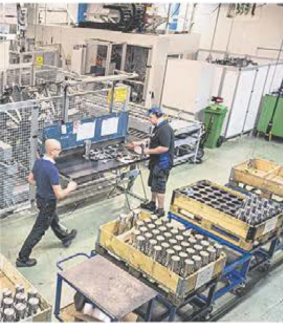
Indexator har installerat två identiska VLC 500 MT maskiner från Emag. Båda är utrustade med palettband, kvalitetsmätning, skärkraftövervakning, verktygs-magasin och verktygsväxlare för obemannad produktion.
