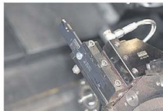
CoroCut QD för djup avstickning utnyttjar riktad högtryckstillförsel av skärvätska optimalt Pablo 140315.
