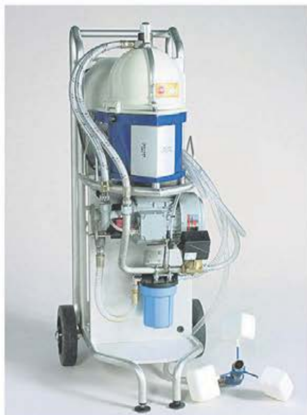
Läckolja förkortar kyl- och skärvätskors livslängd och medför stora kostnader i verkstadsindustrin. Med Alfie 500 möjliggörs återanvändning av dessa vätskor.
