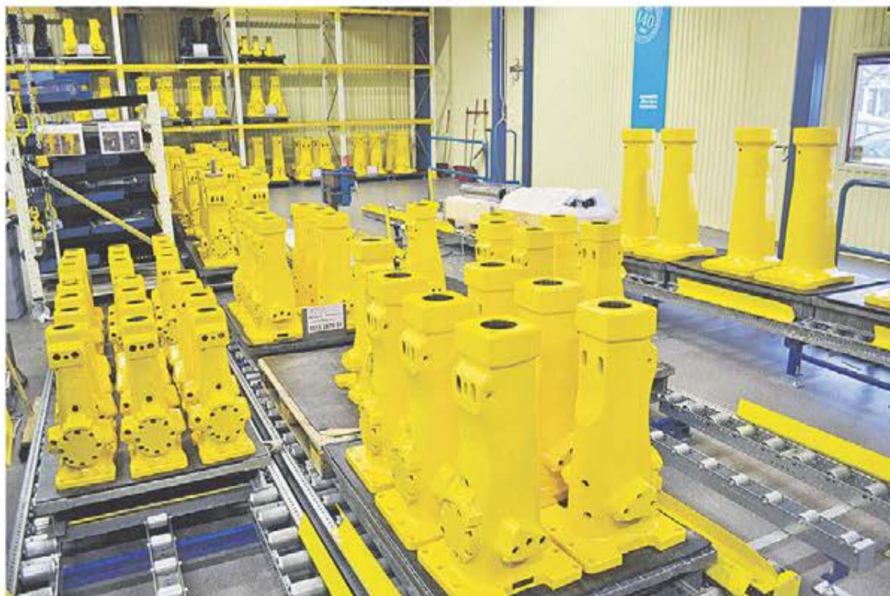
När hammarkropparna är färdiga i maskinen är det dags för målning i gul kulör och fortsatt montering.
