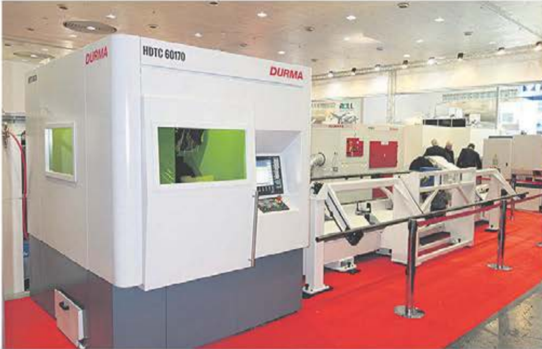
Durma rörlaser med laddning och lossning, skär i tjockleksområdet från 0,8 mm till max 8 mm med 2kW effekt.
