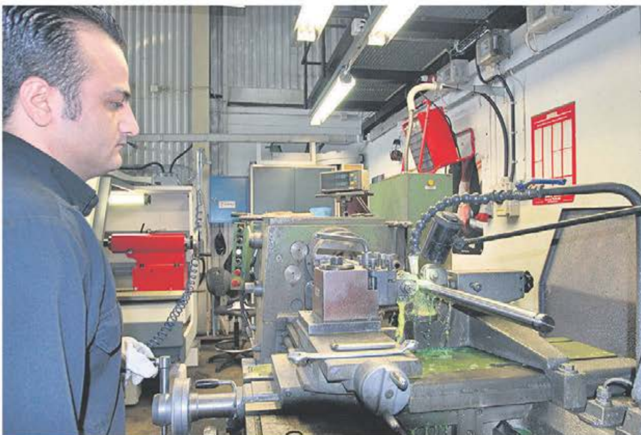
I produktionshallen står den äldre konventionella svarven kvar och man kör fortfarande stödproduktion i den. Här handlar det om ett mänskligt hantverk och maskinoperatören Krekor Najarian behöver stora kunskaper om skärande bearbetning och god materialkännedom.
