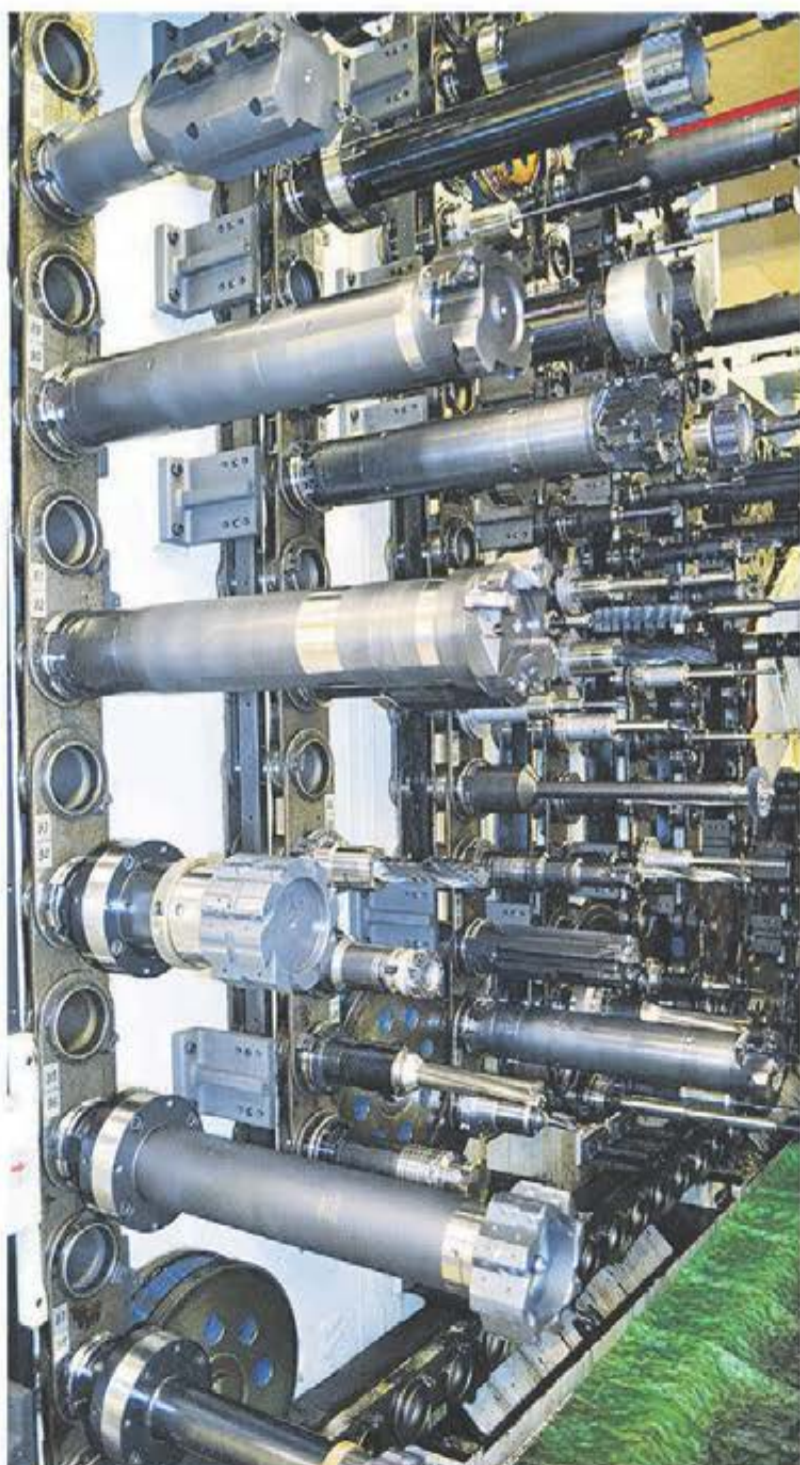
Atlas Copco Construction Tools behöver långa verktyg för att borra djupa hål i hammarkropparna, men risken är att verktygen tippas när maskinen hämtar verktyget i verktygsmagasinet. Colly Verkstadsteknik har tagit fram långa verktyg utan risk för tippmoment.
