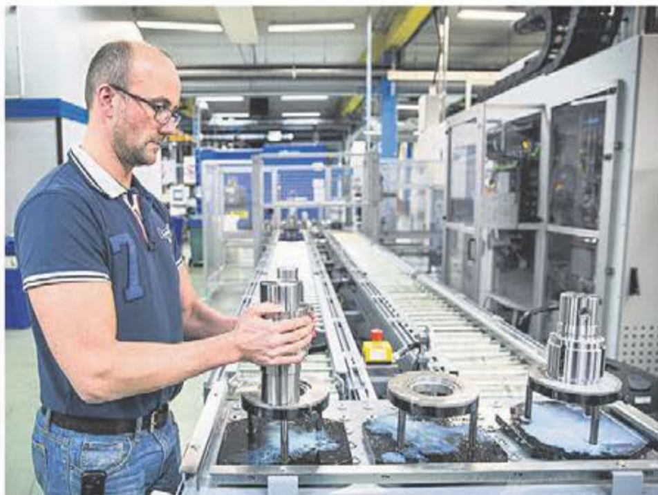
Produktionstekniker Martin Granström visar hur rotatorämnen placeras i paletten på den ingående banan.
