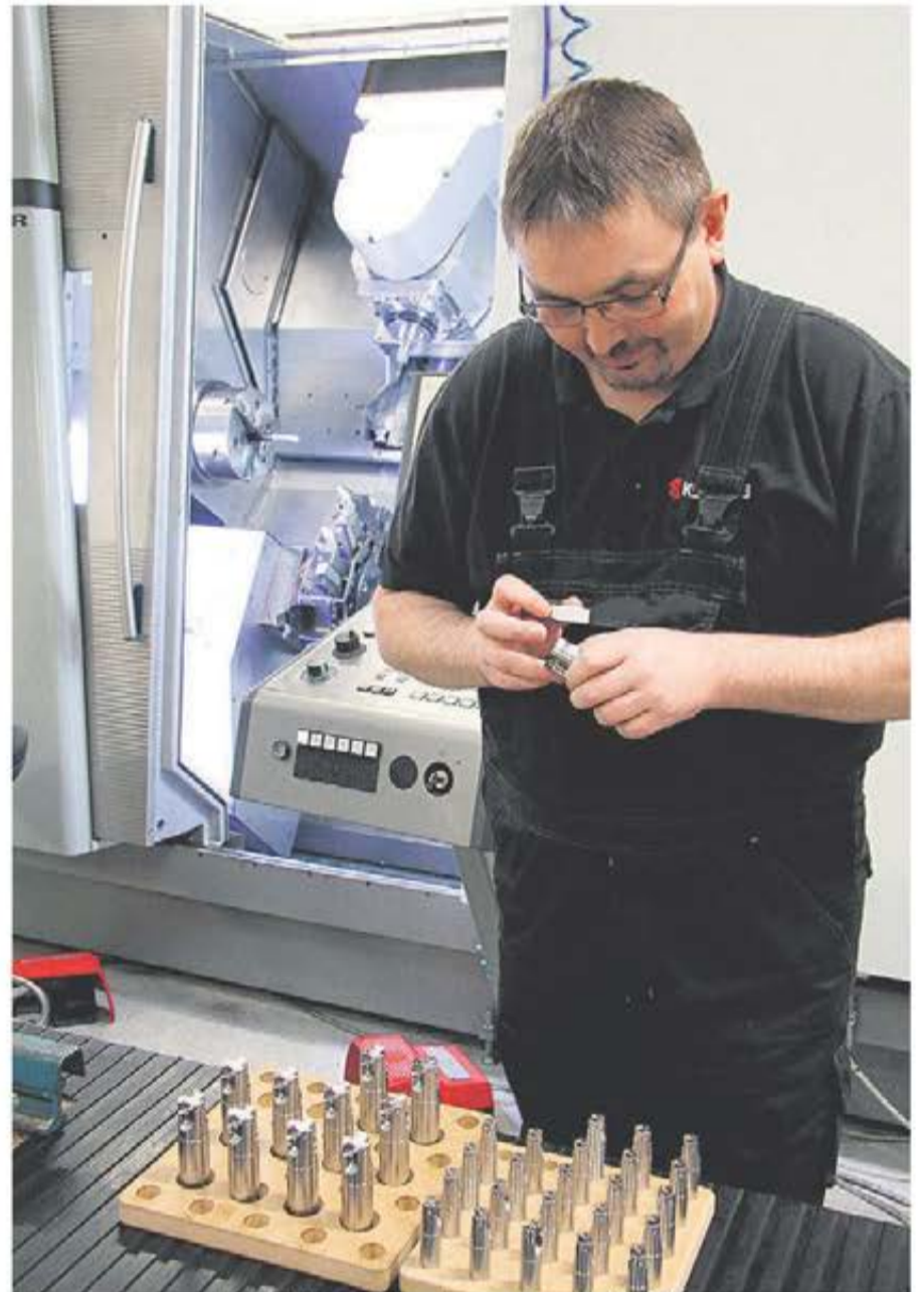
Produktion av specialutvecklad vändskärsverktyg på Kyocera. Vändskärs-kropparna kan ha en mängd olika geometrier, utifrån kundens behov.
