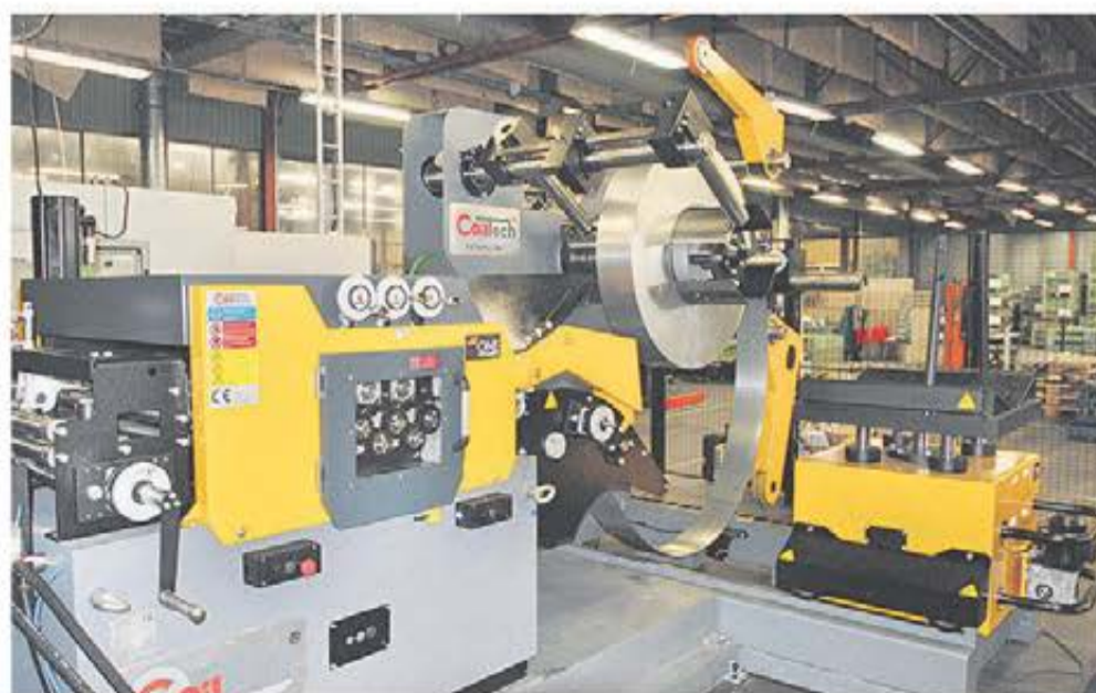
Kompakt rikt- och matarverk med haspel från CoilTech kopplat till Mossini pressen.
