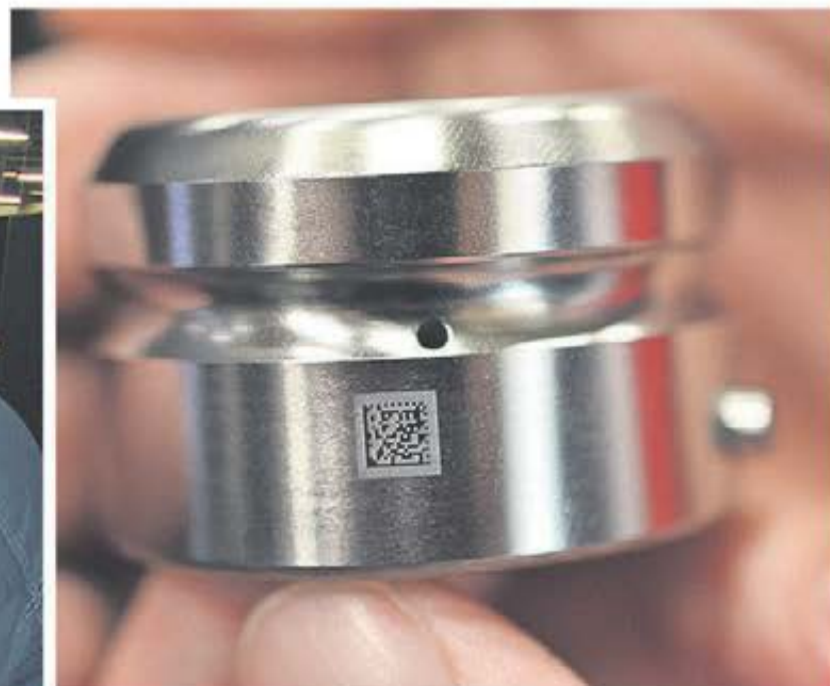
Revolverstansmaskinen har automatisk verktygshantering med QR kodläsning på stansverktygen. QR koden finns både på stans och dyna. Denna registrering kopplas till en verktygsdatabas där man kan se antal slag, hur mycket man har slipat verktyget m.m.
