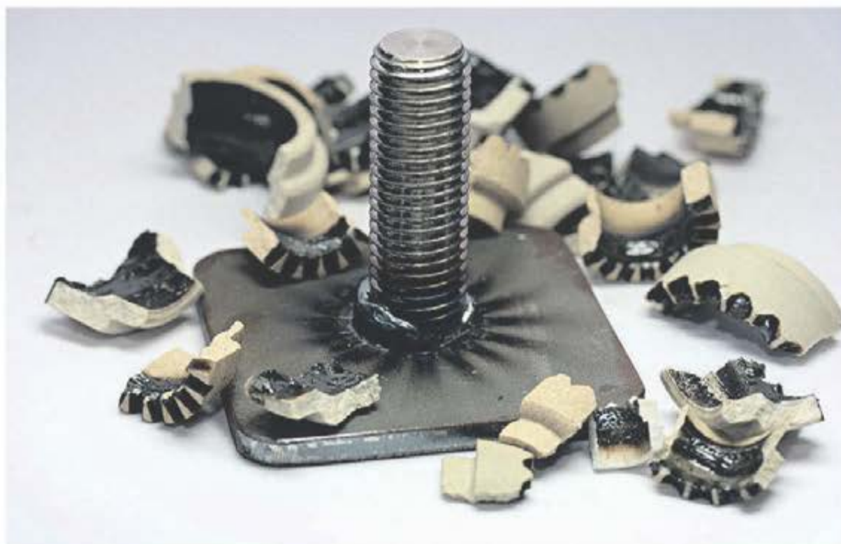
Bultsvetsning med keramiska ringar har använts i mer än 70 år - men resulterar också i avfall och kan skada materialet
