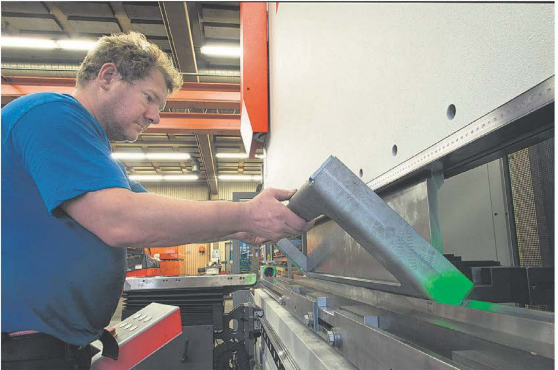
Trots sin storlek är detta ett mycket finkänsligt precisionsinstrument. – Vi kan bocka det mesta med styrkan hos 400 ton, och längden på plåten kan vara upp till imponerande 4100 mm, så nu klarar vi allt säger Urban Lendin.
