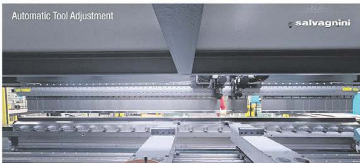
"ATA" - Automatisk längdinställning av verktyg
