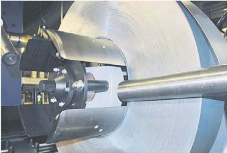
Maskinen arbetar på det asiatiska och amerikanska sättet vilket innebär avhasplning underifrån. Den stora fördelen med denna teknik är att man i hantering och matning av plåten, helt undviker märken och repor.
