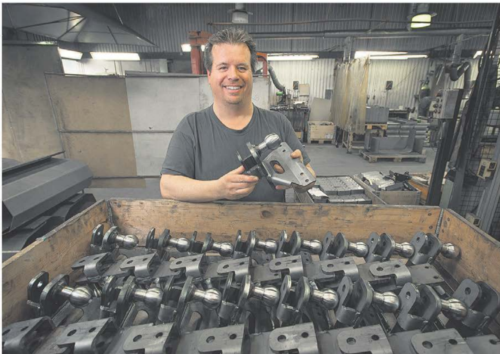
Bengt Åke Larsson VD på Fryksände Mekaniska i Torsby visar upp dragkrokar som anpassats till Yamahas fyrhjulingar. – Det är en rätt typisk produkt som visar företagets kunskaper inom laserskäring, svetsning och bockning. Vi är en komplett verkstad
