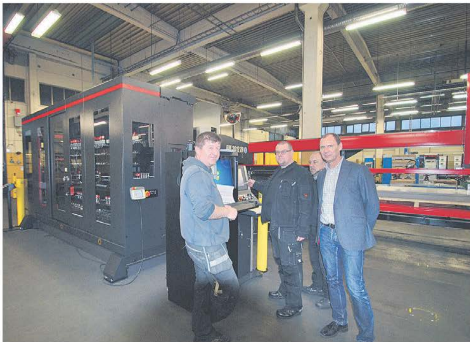
En av de senaste maskininvesteringarna som redan finns på plats i Höör. Revolverstansmaskinen modell EM 3612 ZRT är AMADA's senaste servomekaniska lösning. Detta är den första maskinen av denna modell som installeras utanför Japan. Med det nya systemet att hantera verktyg minimerar man risker av manuell felriggning av verktyg samt minimering av ställtider. Med detta system så har man tillgång till 300 stansverktyg och 600 dynor för en mycket flexibel produktion.
