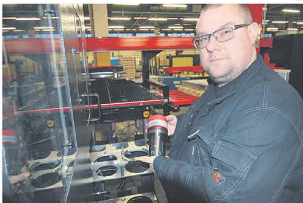
Revolverstansmaskinen har automatisk verktygshantering med QR kodläsning på stansverktygen. QR koden finns både på stans och dyna. Denna registrering kopplas till en verktygsdatabas där man kan se antal slag, hur mycket man har slipat verktyget m.m.
