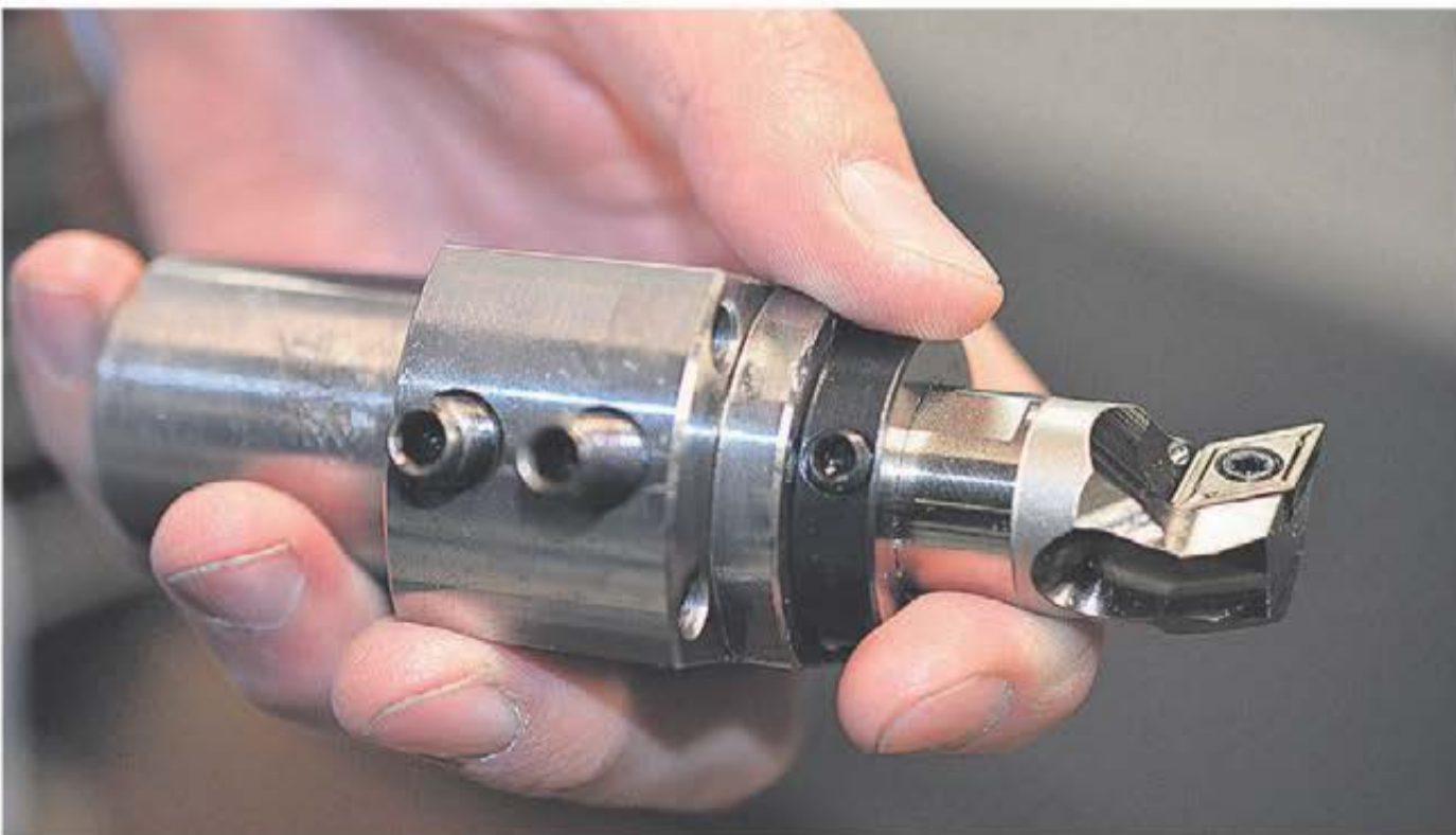
- Svarvskären från Mitsubishi som i test fungerat bra, där vi är nöjda med både funktion, hållbarhet och pris, menar maskinoperatör Johan Hinders och tillägger att spånbrytningen är riktigt bra och med så mycket obemannad körning som vi har så måste vi kunna lita på verktygen.
