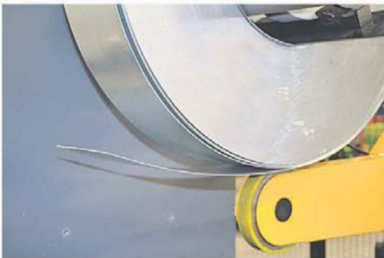
Maskinen arbetar på det asiatiska och amerikanska sättet vilket innebär avhasplning underifrån. Den stora fördelen med denna teknik är att man i hantering och matning av plåten, helt undviker märken och repor.
