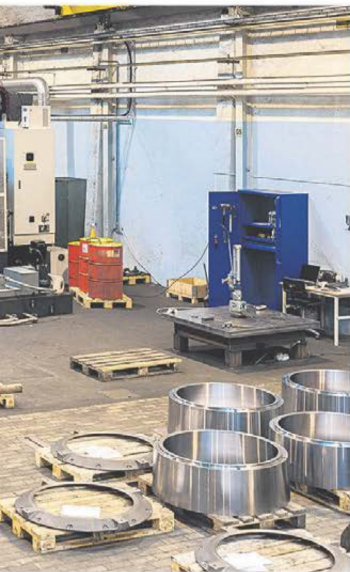
7 500 kvm produktionsyta gör Höganäs Verkstad till vad vi tror, södra Sveriges största maskin- och plåtverkstad. På bilden maskinhallen med två karusellsvarvar som klarar max 1,8 meter respektive 3 meter i svarvdiament och maskinerna är utrustade med drivna verktyg och C-axel.
